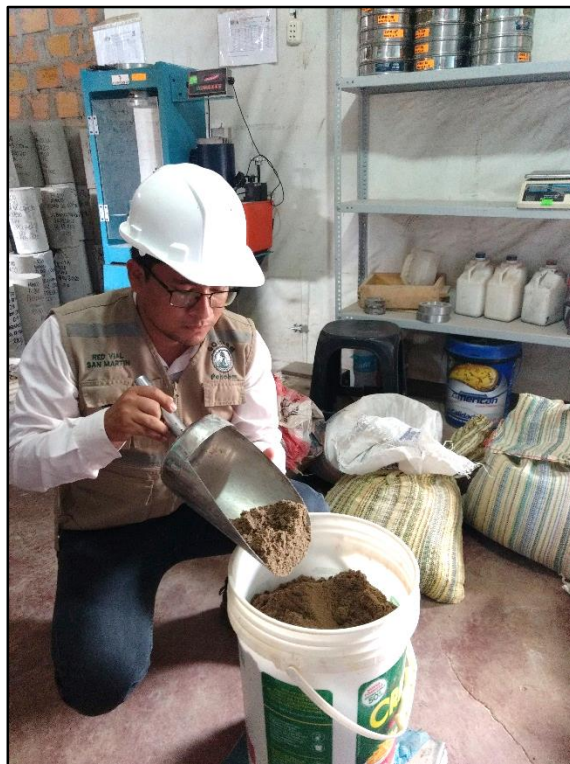
Foto 6. Pesaje de agregado fino para el concreto.
