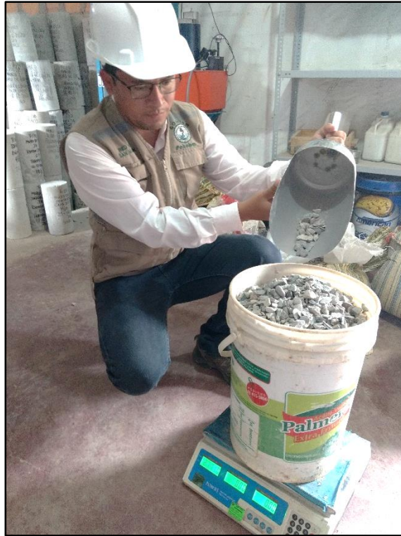
Foto 5. Pesaje de agregado grueso para el concreto.
