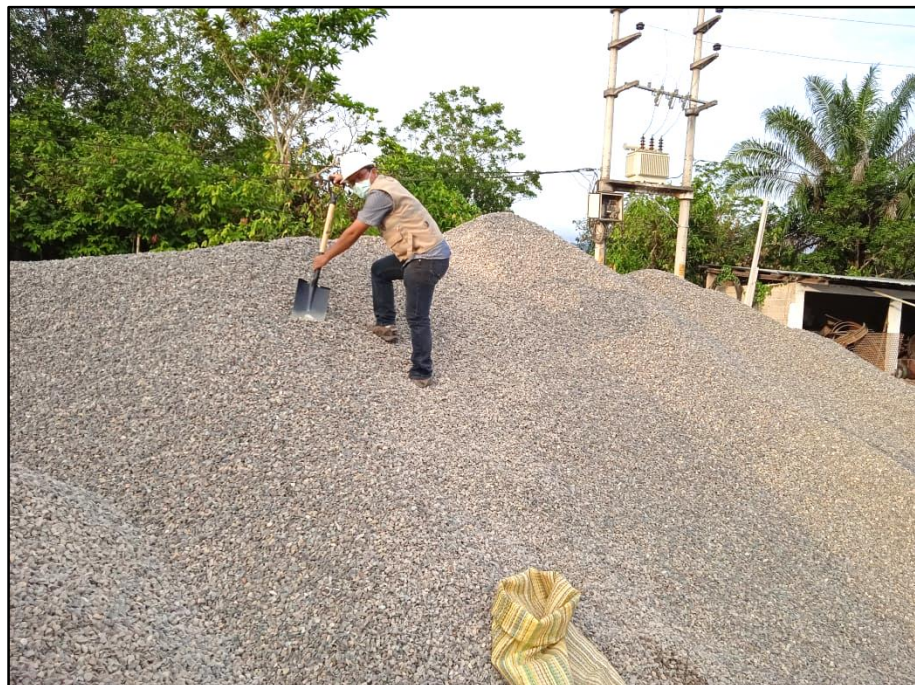
Foto 2. Agregado grueso del río Huallaga para el concreto.
