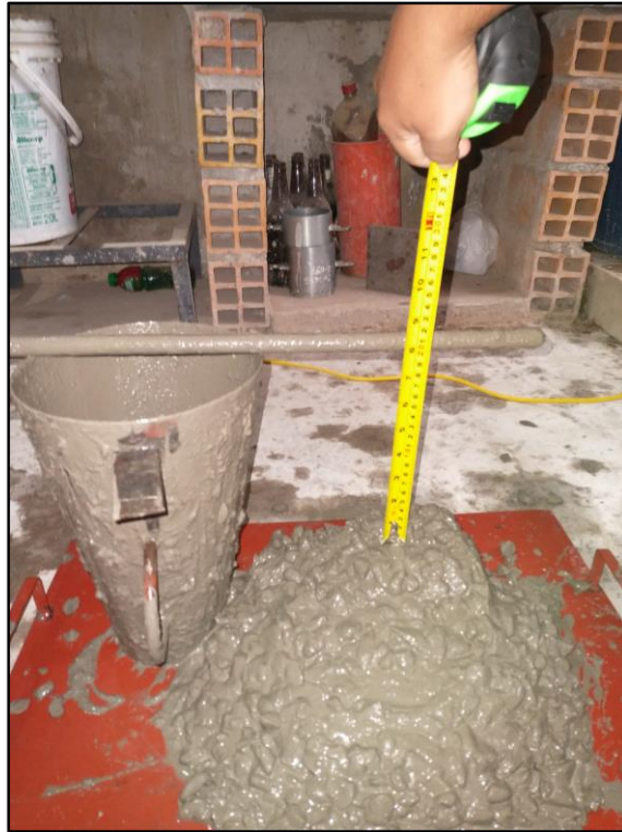
Foto 9. Concreto con slump de 8”.
