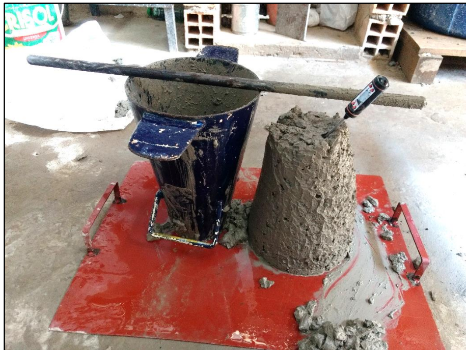
Foto 10. Concreto con slump de 2”.
