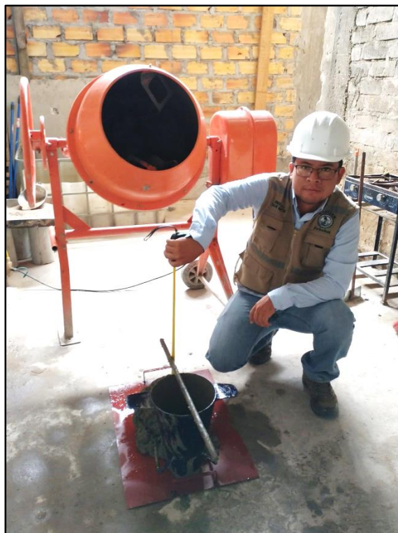
Foto 8. Medición del slump.
