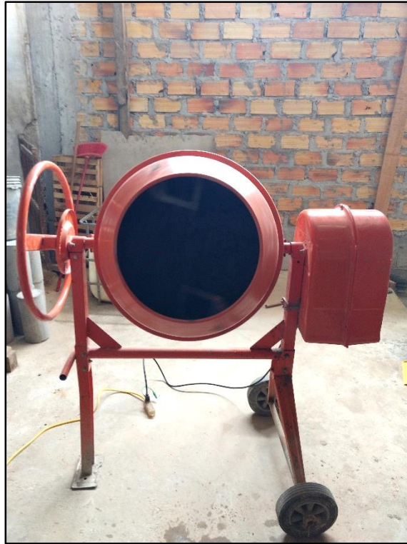
Foto 3. Mezcladora de concreto de laboratorio.
