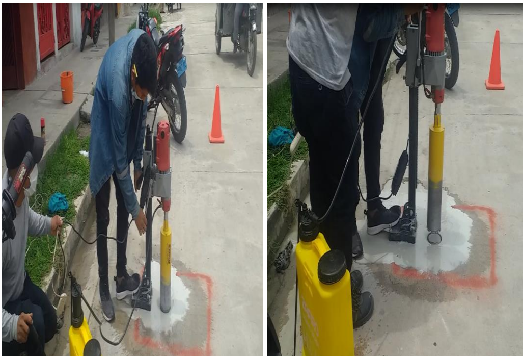
Imagen 14: Extracción del espécimen de concreto del E-22, realizado en la Cuadra 10 del Jr. Dos de Mayo.
