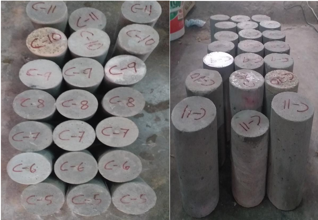
Imagen 17: Especímenes aserrados o esmerilados.
