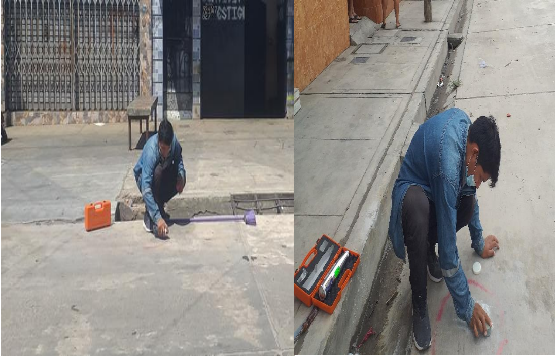
Imagen 7: Pulido superficial en la zona de prueba, para realizar el ensayo de Esclerometría- Cuadra 6 del Jr. Dos de Mayo.
