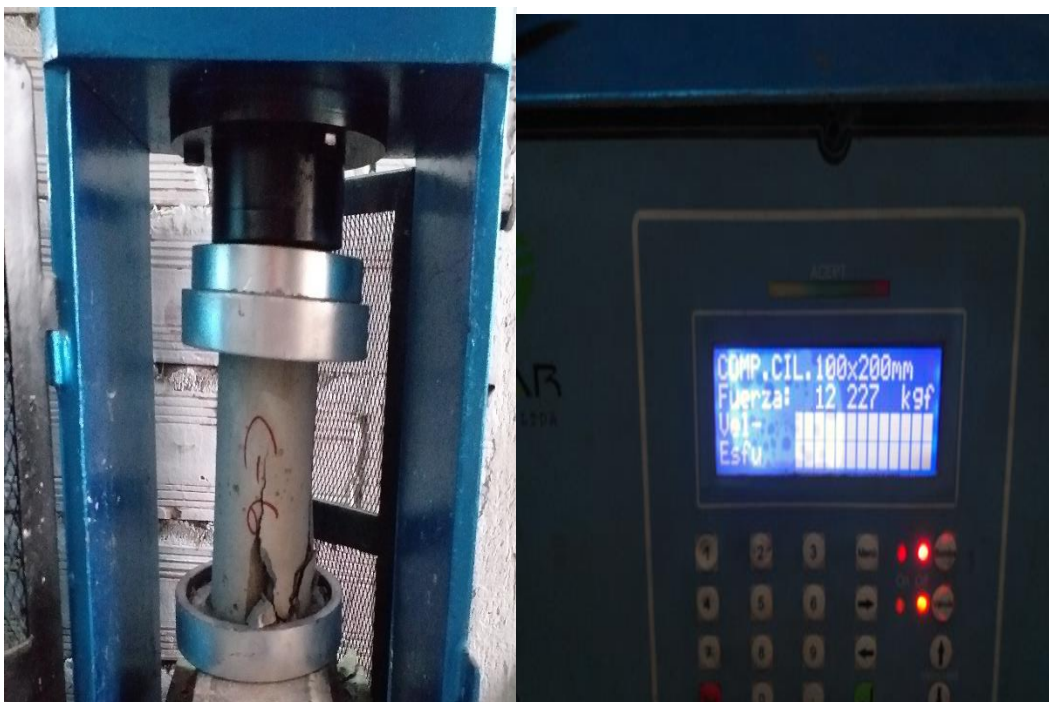
Imagen 20: Ensayo a Compresión Uniaxial del espécimen de concreto endurecido.
