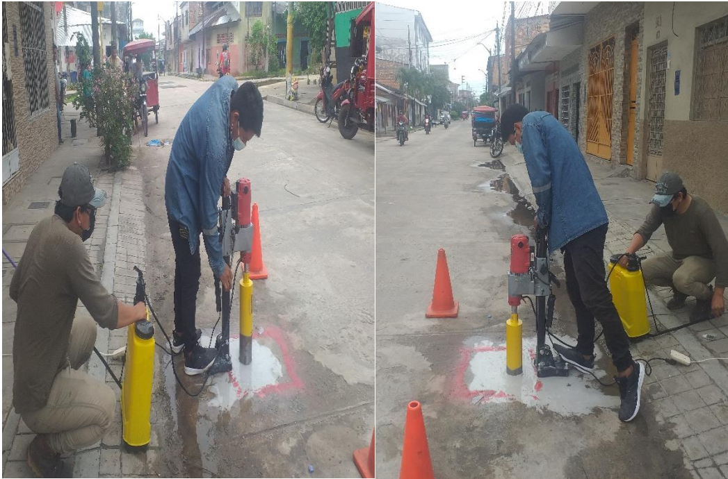
Imagen 13: Extracción del espécimen de concreto del E-19, realizado en la Cuadra 9 del Jr. Dos de Mayo.
