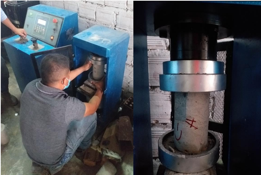
Imagen 19: Ensayo a Compresión Uniaxial del espécimen de concreto endurecido.
