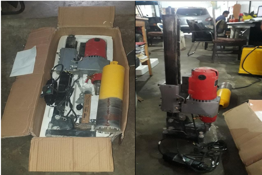
Imagen 5: Equipo sonda provista de brocas diamantadas, provista de tanque de agua.
