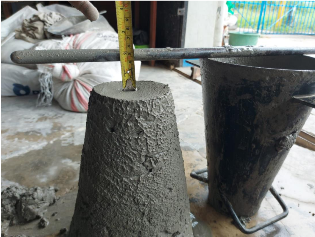
Ensayo de consistencia (Slump).
