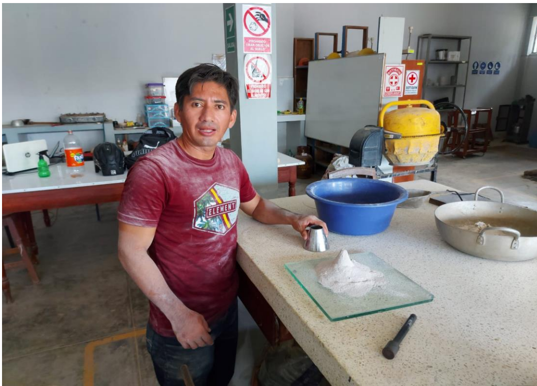
Ensayo de absorción del agregado fino.
