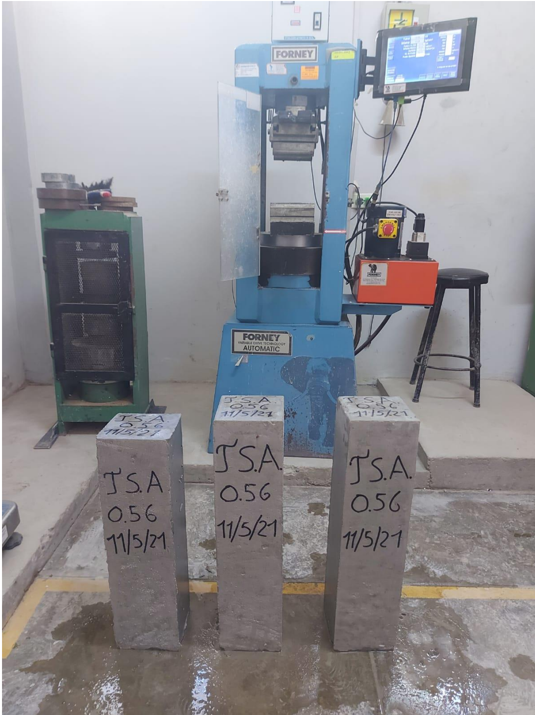
Ensayo de resistencia flexión.
