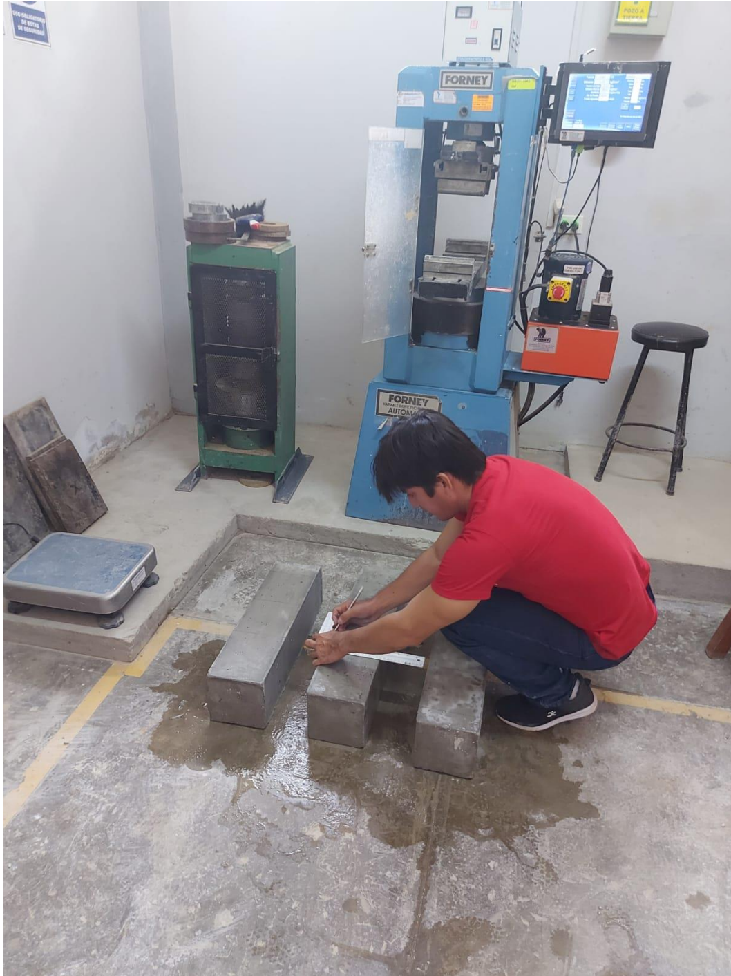
Ensayo de resistencia flexión.
