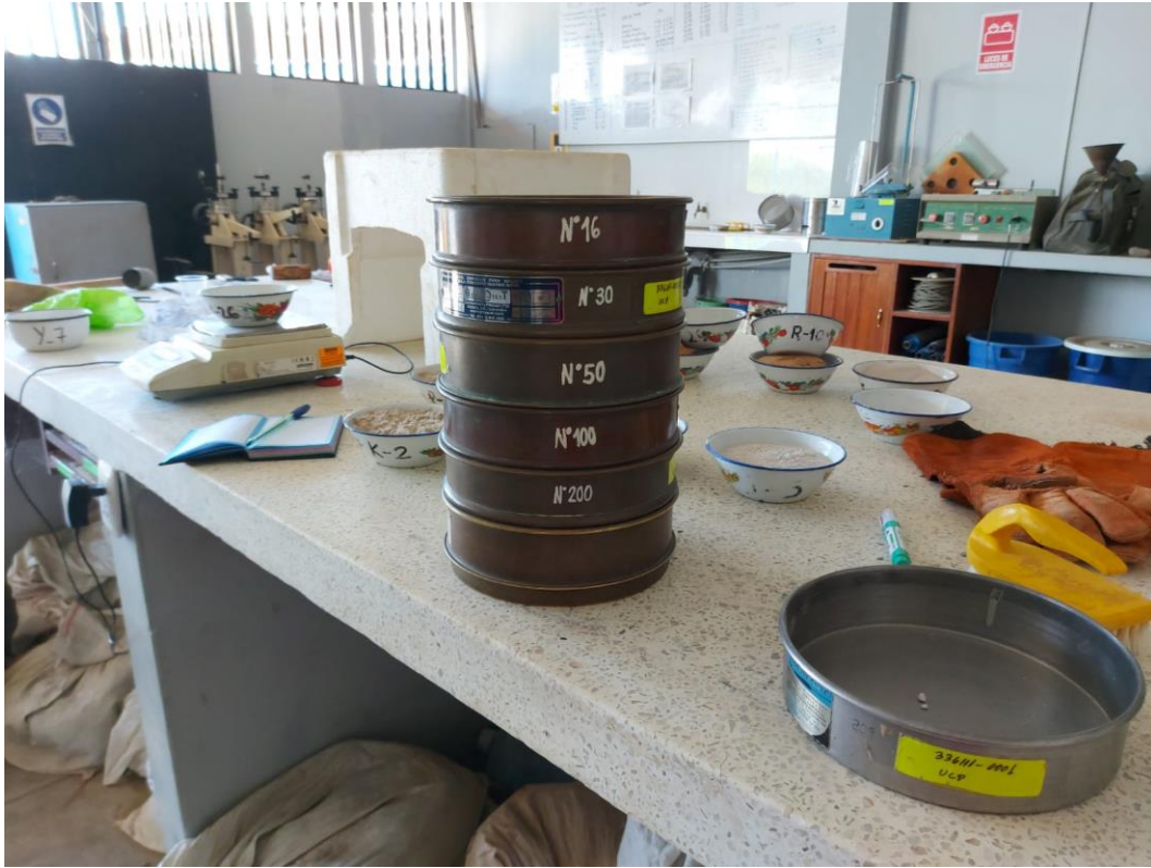
Juego de tamices para el ensayo de análisis del agregado fino.
