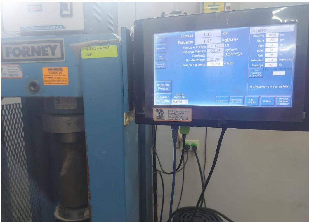
Ensayo de resistencia compresión.
