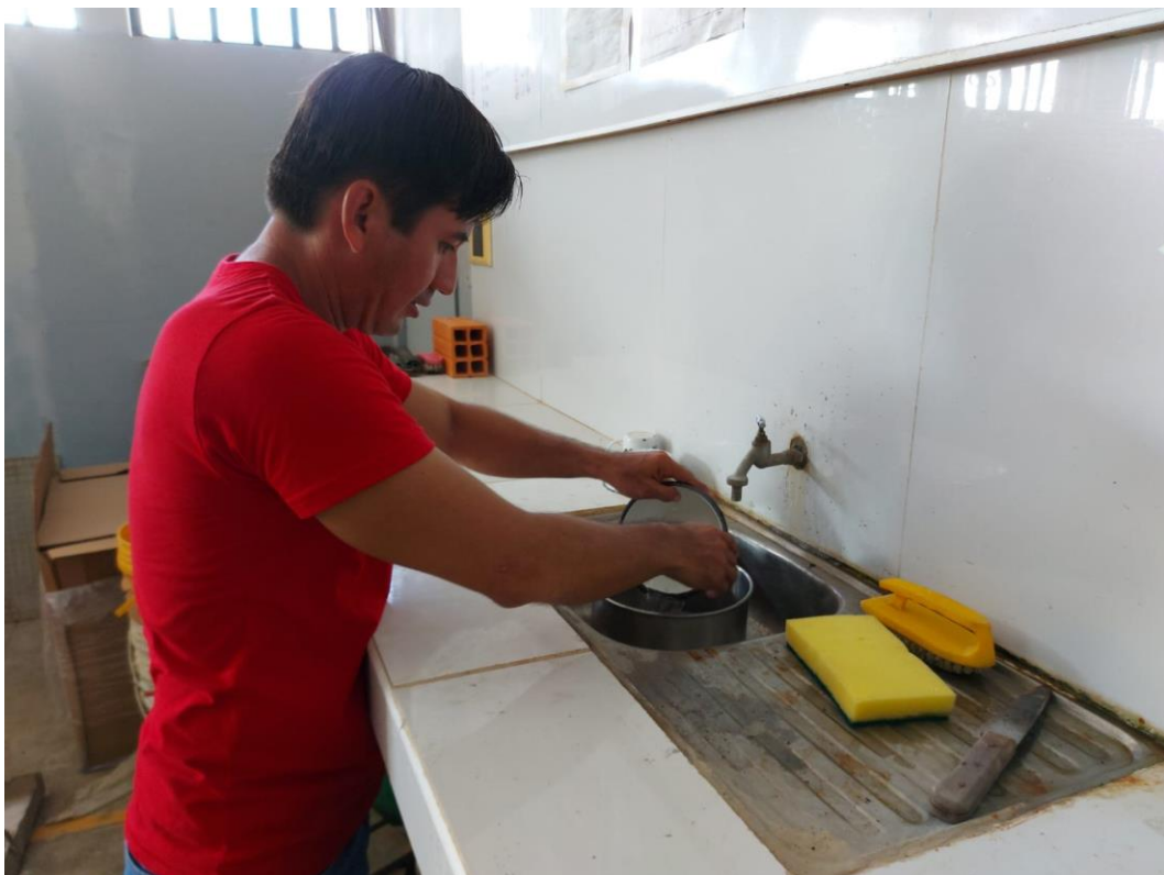
Lavado del agregado fino para ensayo del porcentaje que pasa la malla no. 200.
