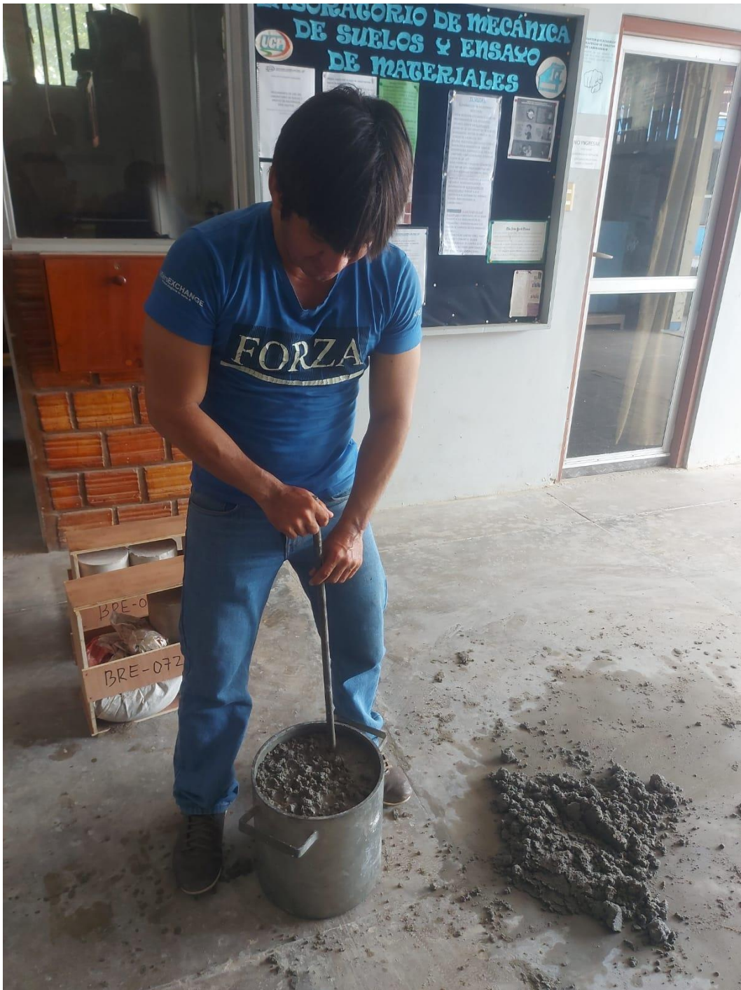
Ensayo de exudación. Compactación de la muestra.
