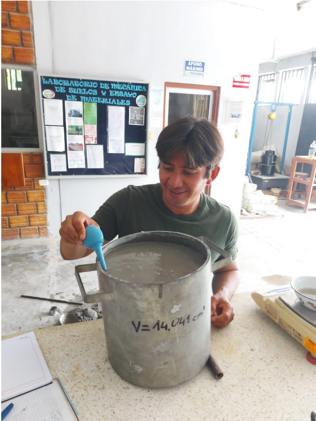
Ensayo de exudación. Recolección del agua de exudación.
