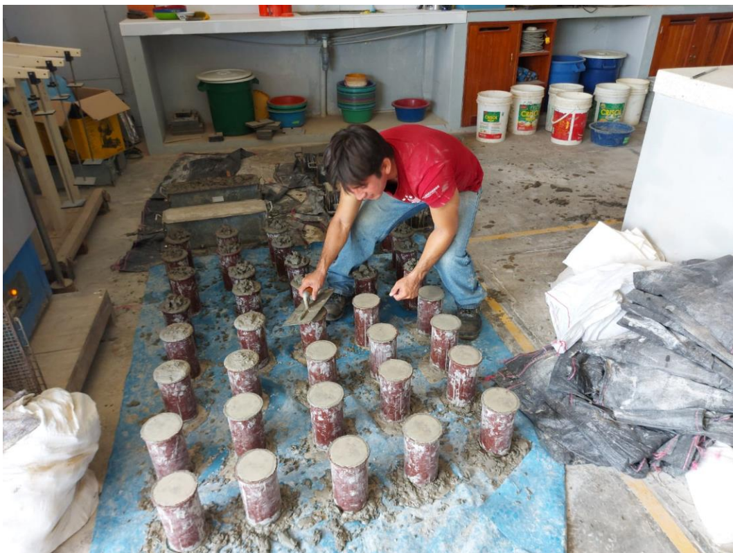
Preparación de las probetas.
