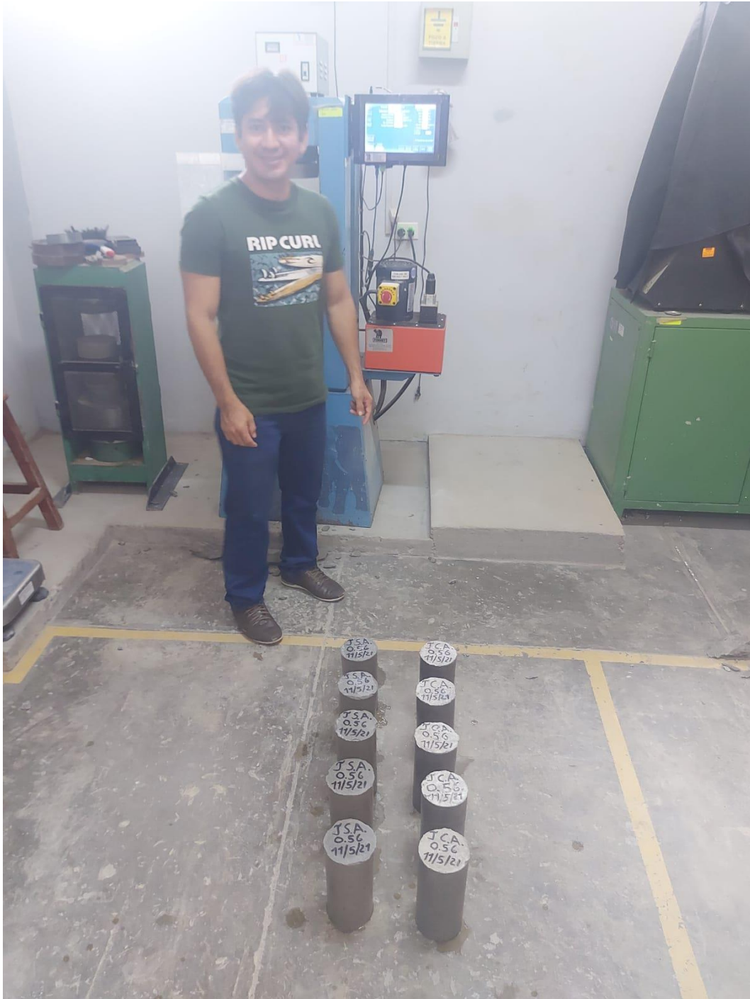
Ensayo de resistencia compresión.
