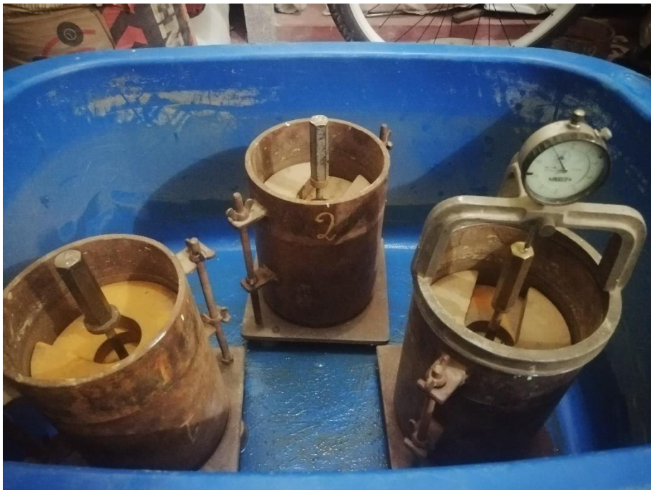
Imagen 13: colocación de las muestras en agua, para el curado de 4 días.
