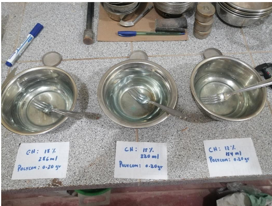
Imagen 11: Disolución del polímero en agua potable para su aplicación en el suelo seco, para ensayos de compactación
