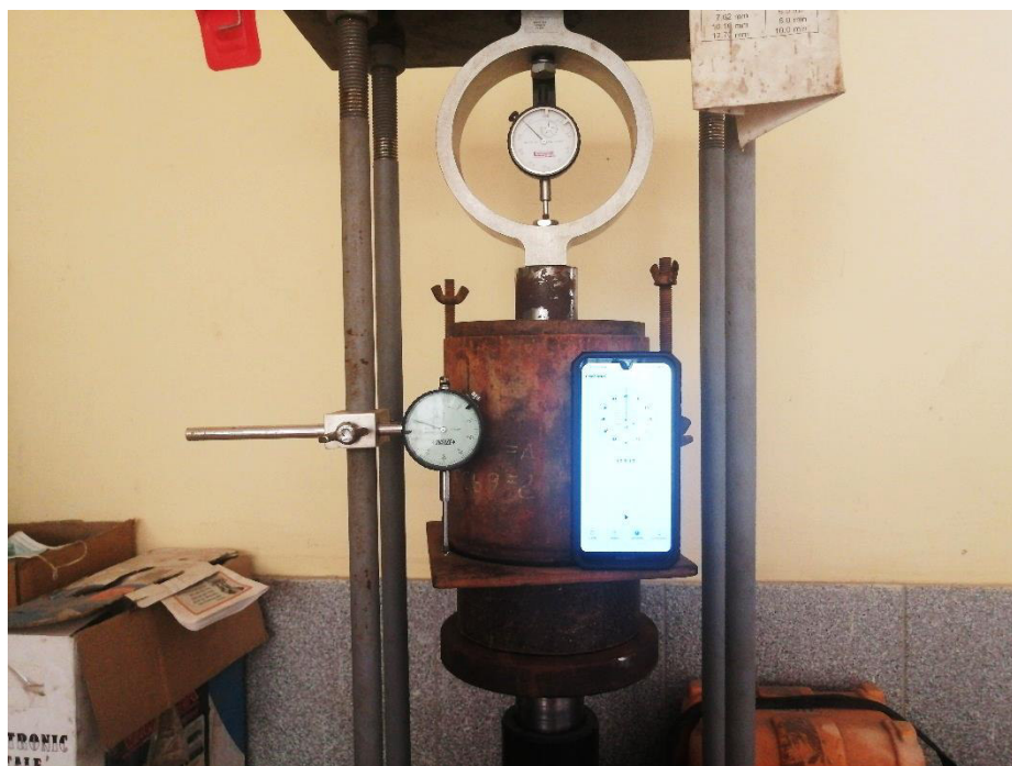
Imagen 15: Ensayo de penetración en la prensa de CBR.
