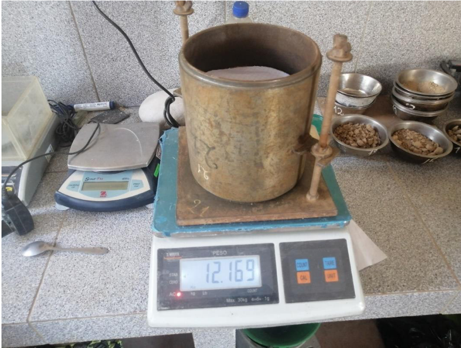
Imagen 12: moldeo de las muestras para ensayo de CBR.
