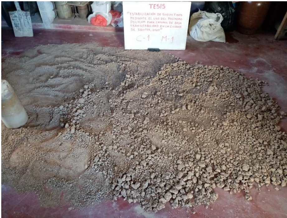
Imagen 10: molido de grumos de las muestras sobre una superficie limpia, para ensayos de compactación
