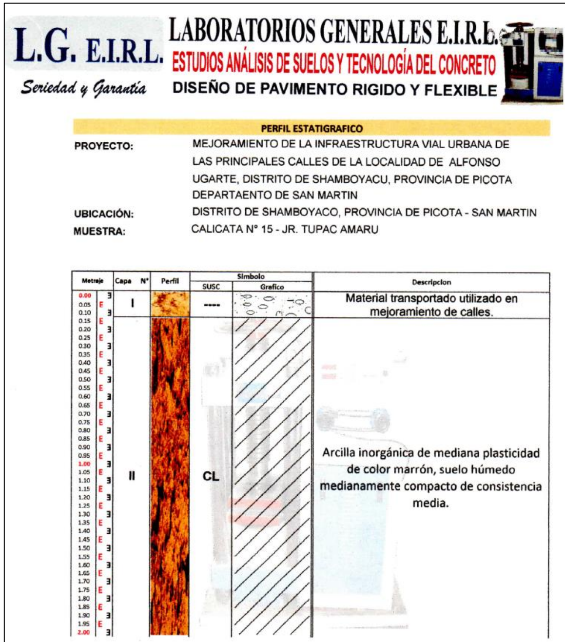
Figura 37: Perfil Estratigráfico Calicata N°15 – Jr. Tupac Amaru
