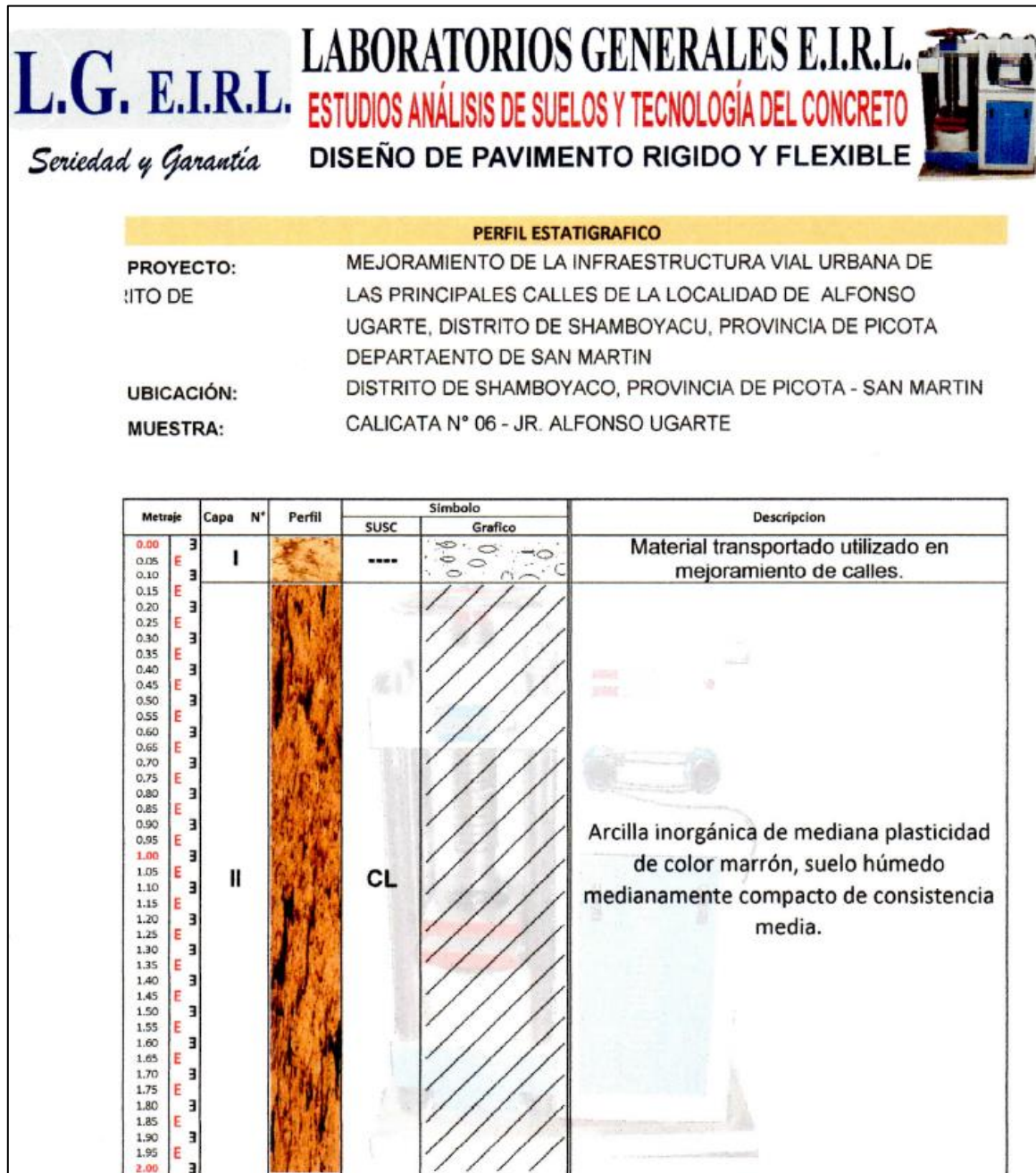
Figura 28: Perfil Estratigráfico Calicata N°06 – Jr. Alfonso Ugarte
