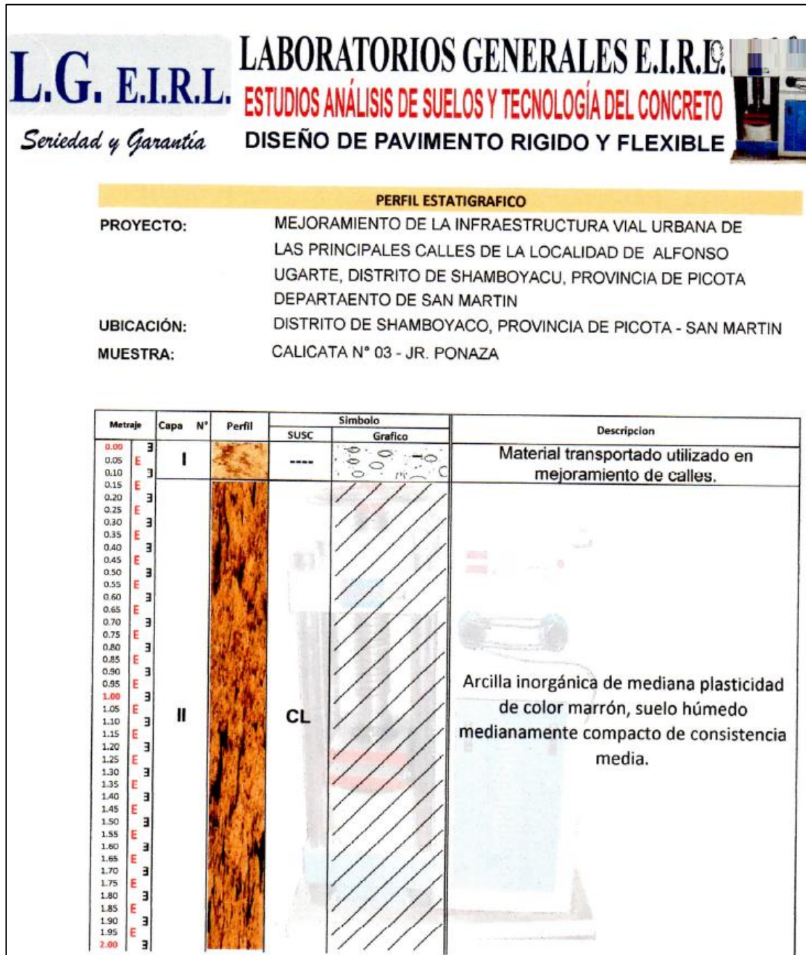
Figura 25: Perfil Estratigráfico Calicata N°03 – Jr. Ponaza
