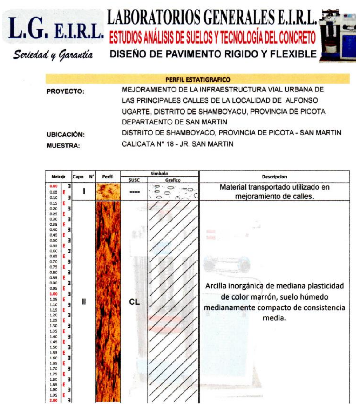
Figura 40: Perfil Estratigráfico Calicata N°18 – Jr. San Martín
