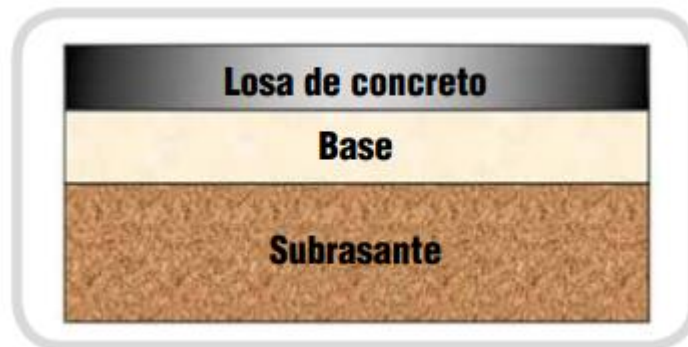
Figura 10: Estructura de un pavimento rígido
