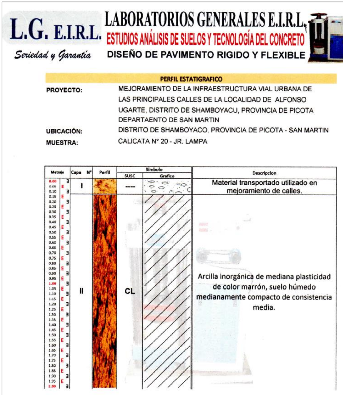
Figura 42: Perfil Estratigráfico Calicata N°20 – Jr. Lampa
