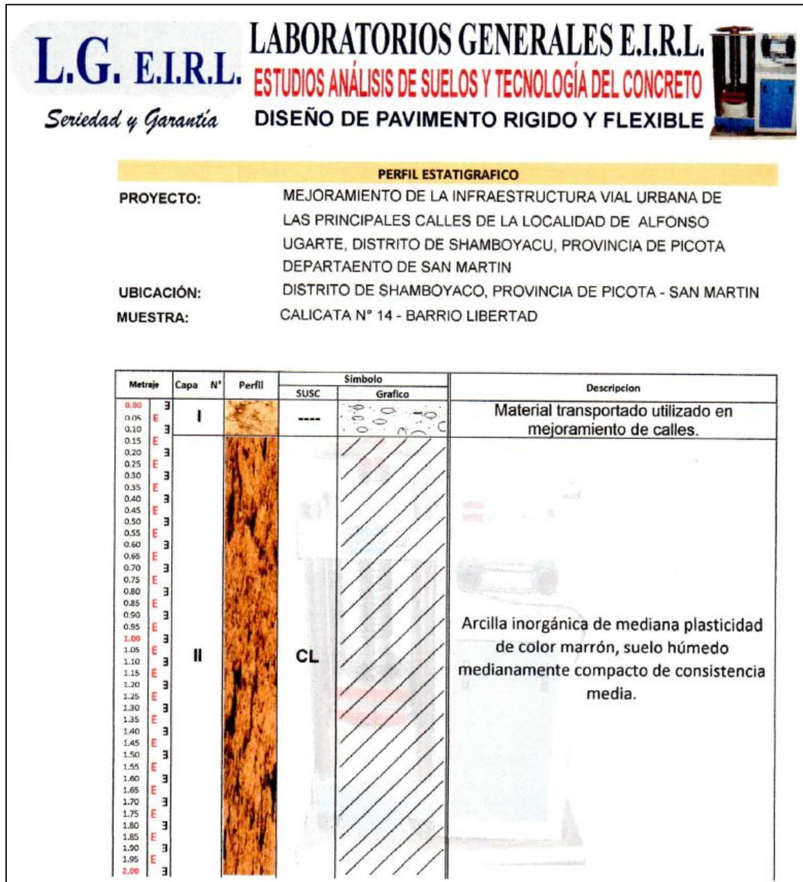
Figura 36: Perfil Estratigráfico Calicata N°14 – Jr. Barrio Libertad
