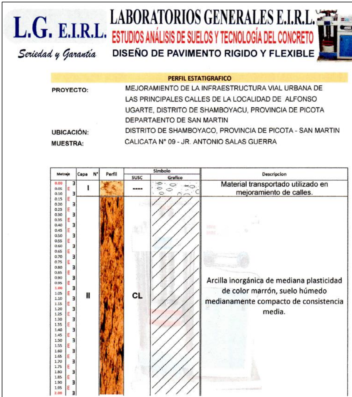
Figura 31: Perfil Estratigráfico Calicata N°09 – Jr. Antonio Salas Guerra
