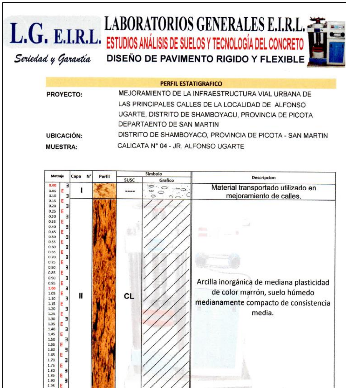
Figura 26: Perfil Estratigráfico Calicata N°04 – Jr. Alfonso Ugarte
