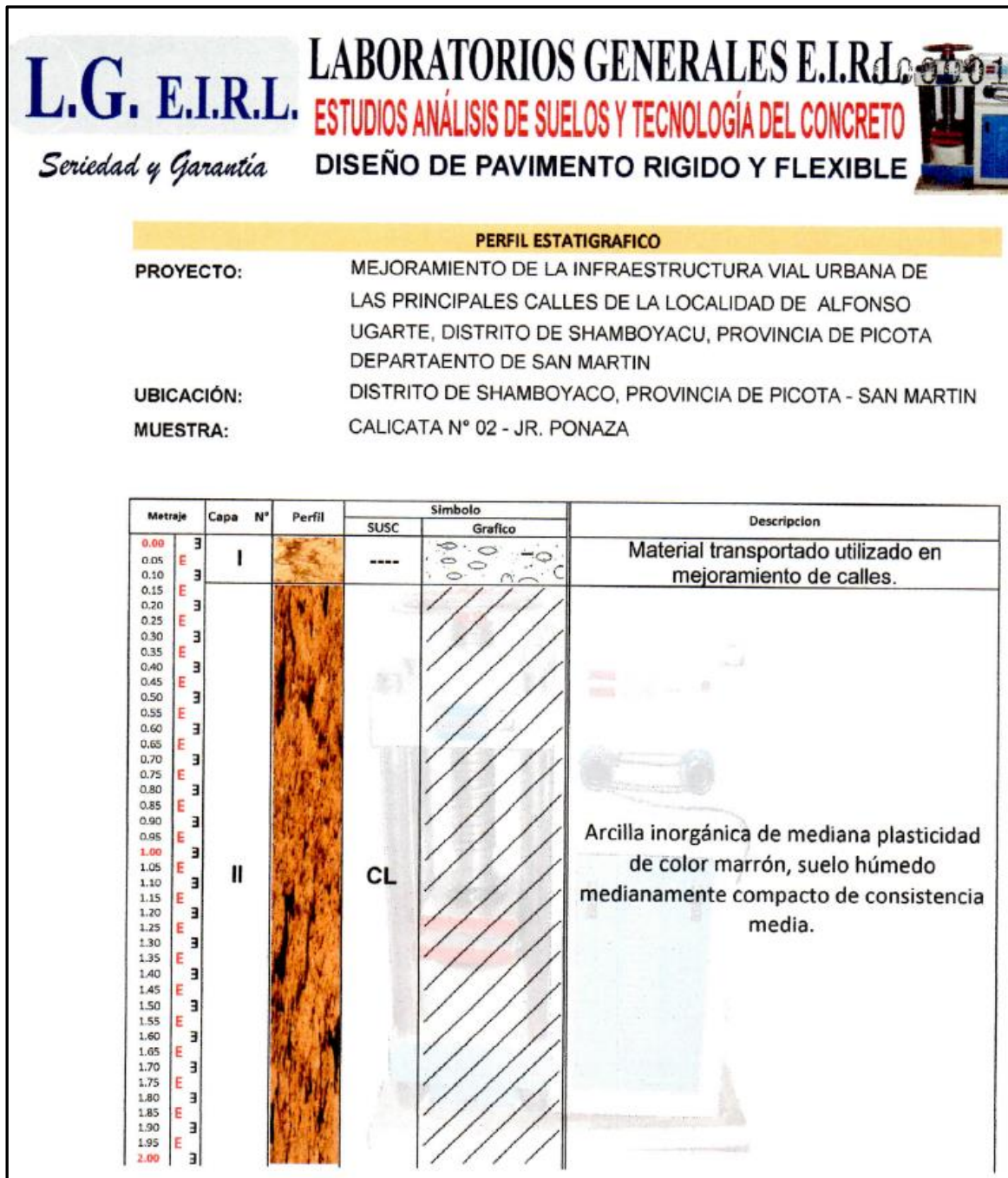
Figura 24: Perfil Estratigráfico Calicata N°02 - Jr. Ponaza
