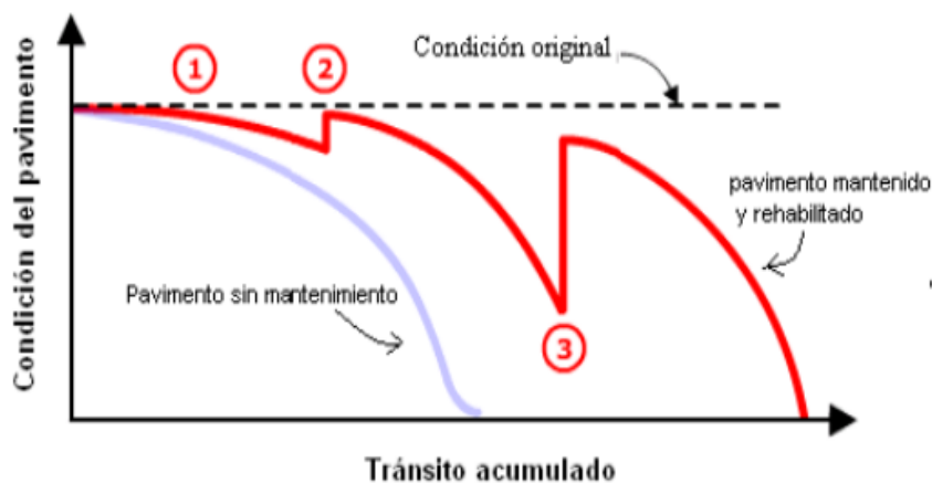
Figura 7: Ciclo de vida de los pavimentos con mantenimiento y rehabilitación
