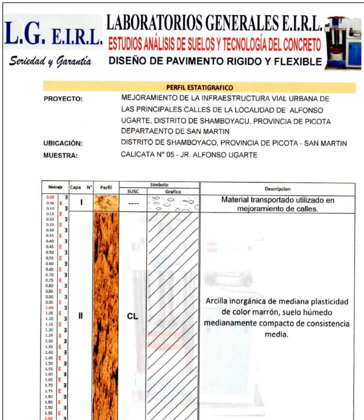
Figura 27: Perfil Estratigráfico Calicata N°05 – Jr. Alfonso Ugarte
