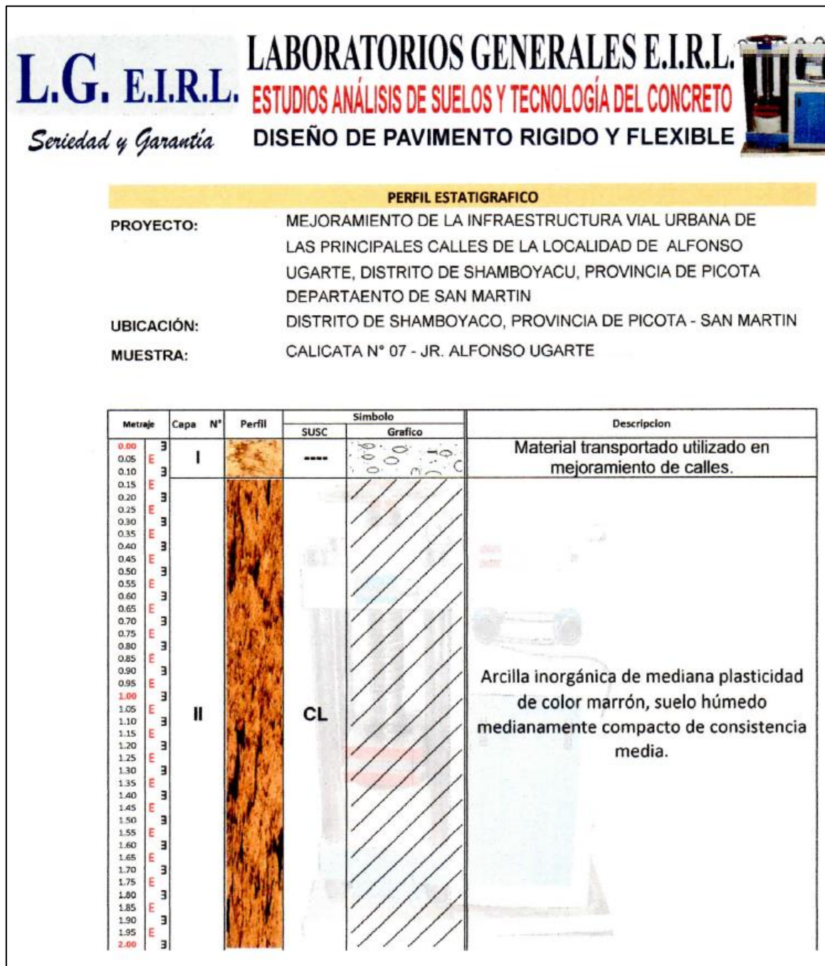
Figura 29: Perfil Estratigráfico Calicata N°07 – Jr. Alfonso Ugarte
