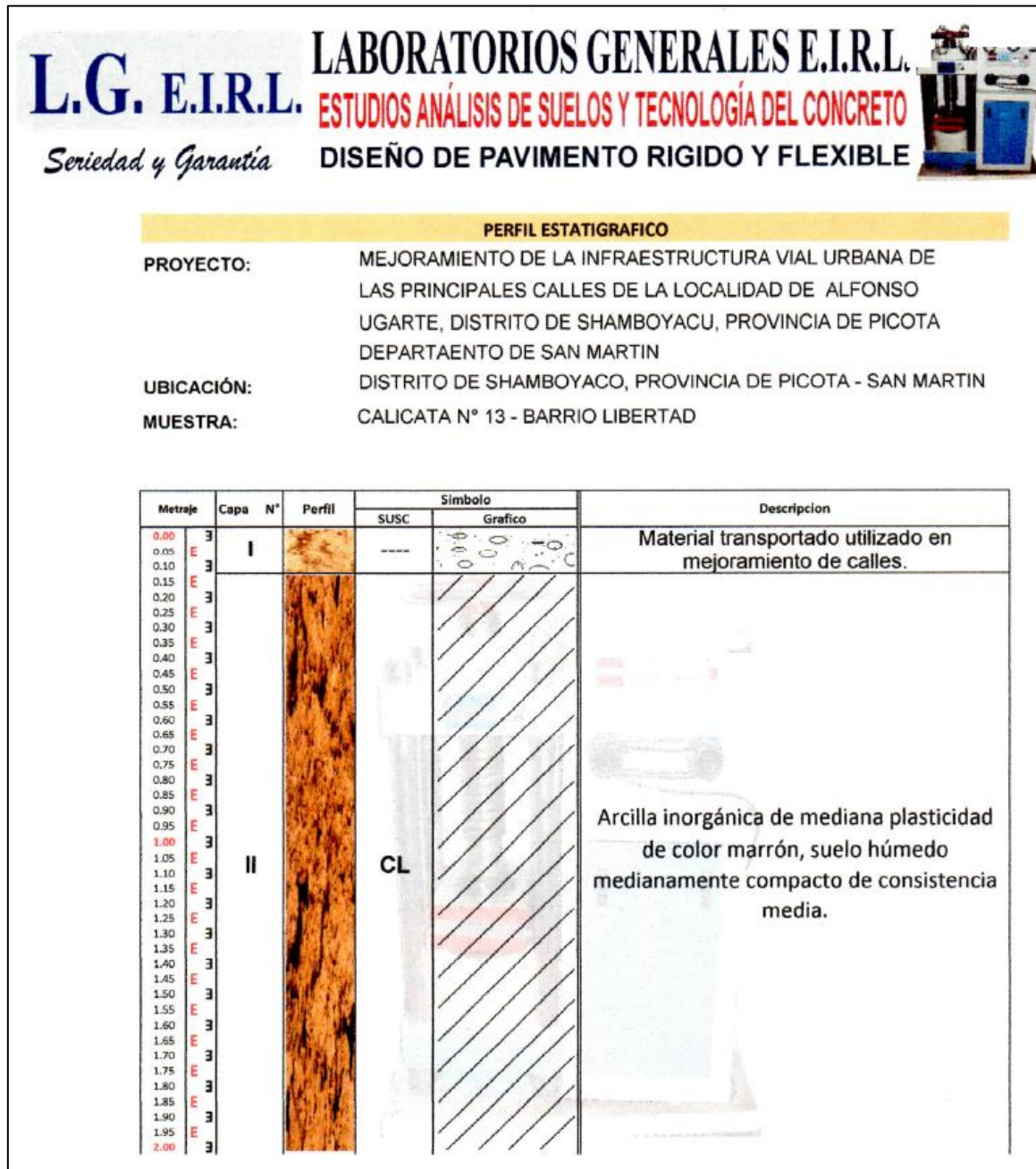
Figura 35: Perfil Estratigráfico Calicata N°13 – Jr. Barrio Libertad
