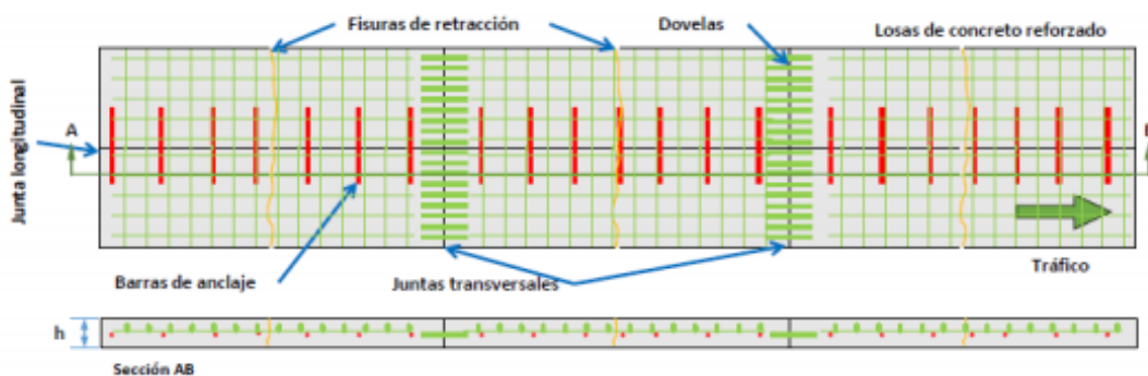
Ilustración 12 . Pavimento de concreto reforzado con conectores
