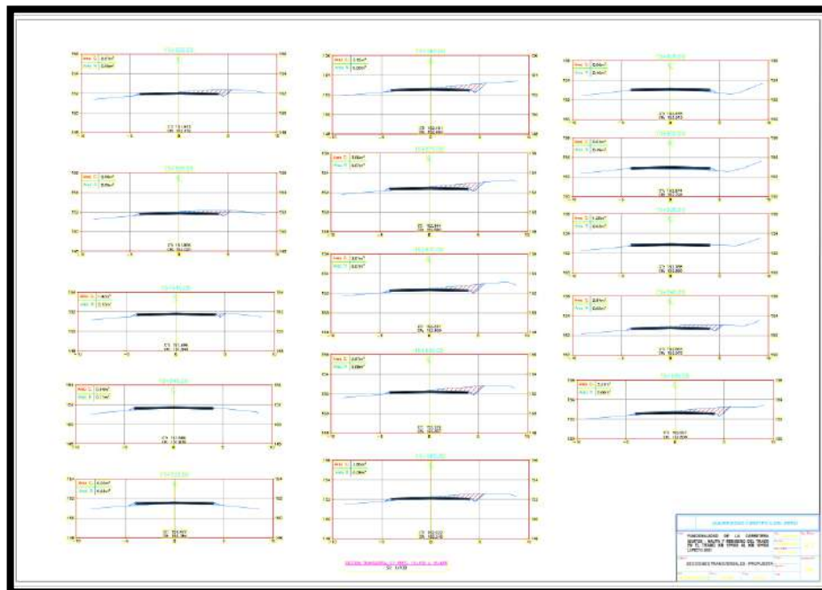
Imagen 30: Secciones Transversales correspondiente al nuevo diseño geométrico del tramo km 15+535 al km 15+605
