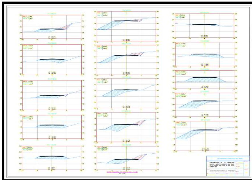
Imagen 26: Secciones Transversales correspondiente al nuevo diseño geométrico del tramo km 15+150 al km 15+280
