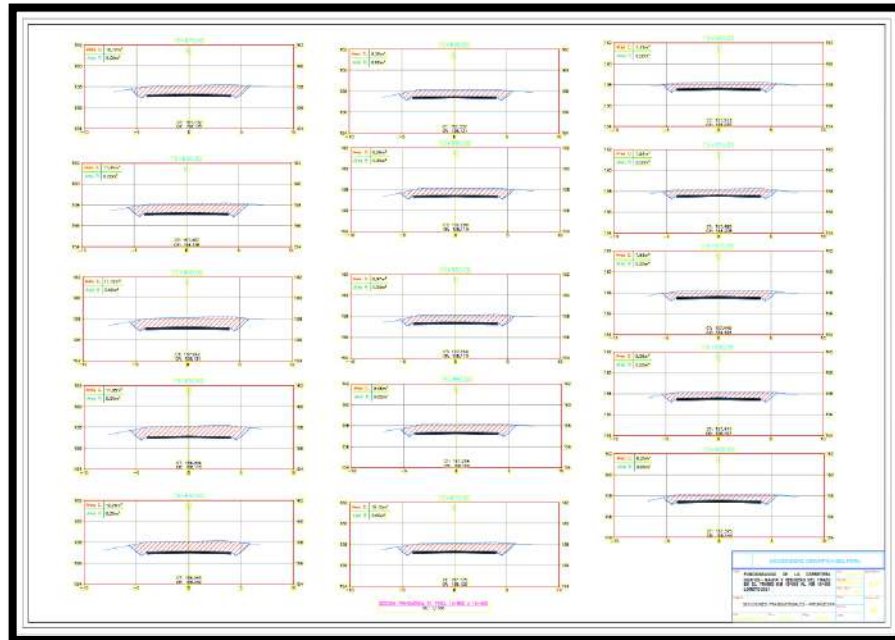
Imagen 35: Secciones Transversales correspondiente al nuevo diseño geométrico del tramo km 15+850 al km 15+920
