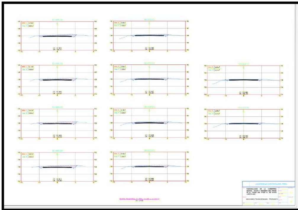
Imagen 37: Secciones Transversales correspondiente al nuevo diseño geométrico del tramo km 15+980 al km 16+000
