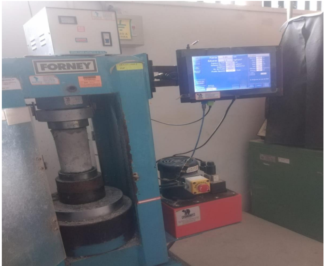
Ensayo de resistencia a la compresión.
