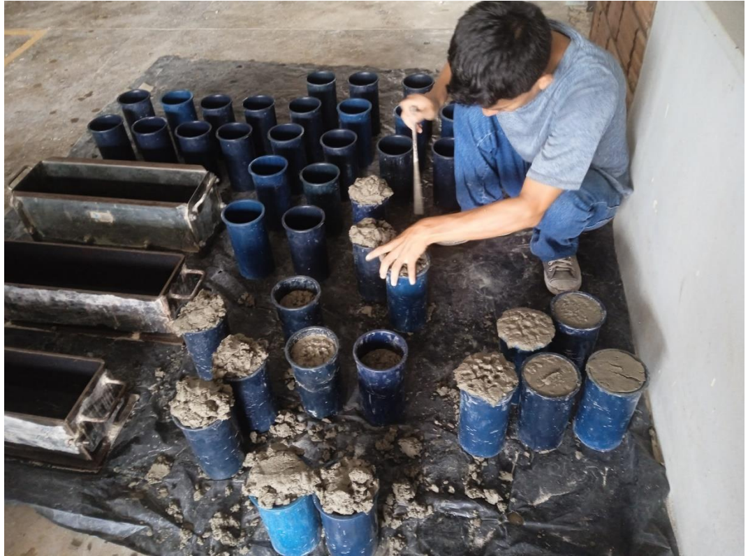
Moldeo del concreto
