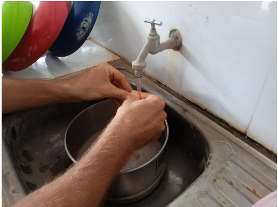
Ensayo del pasante de la malla n°200 – el lavado
