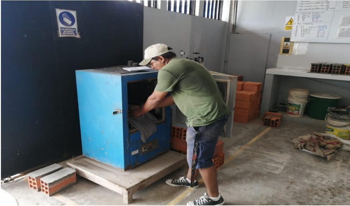
Foto 11. Unidades de ladrillos puestas en el horno para obtener el peso seco de las mismas.
