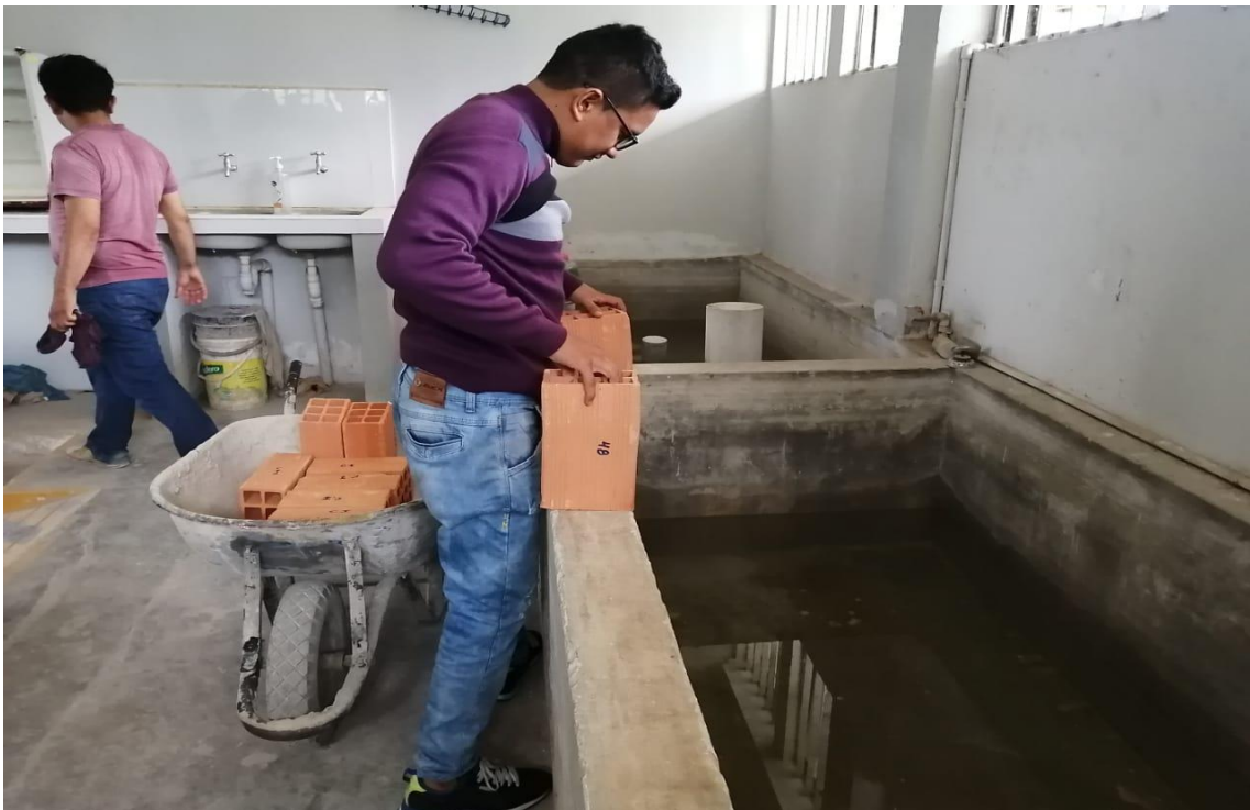
Foto 8. Se sumergió los ladrillos, por muestras de cada ladrillera.
