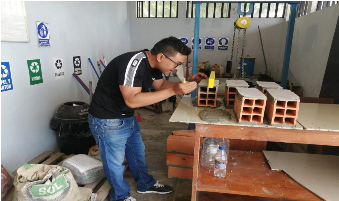
Foto 9. Preparación de capa nivelante, previa a rotura de ensayo de compresión.
