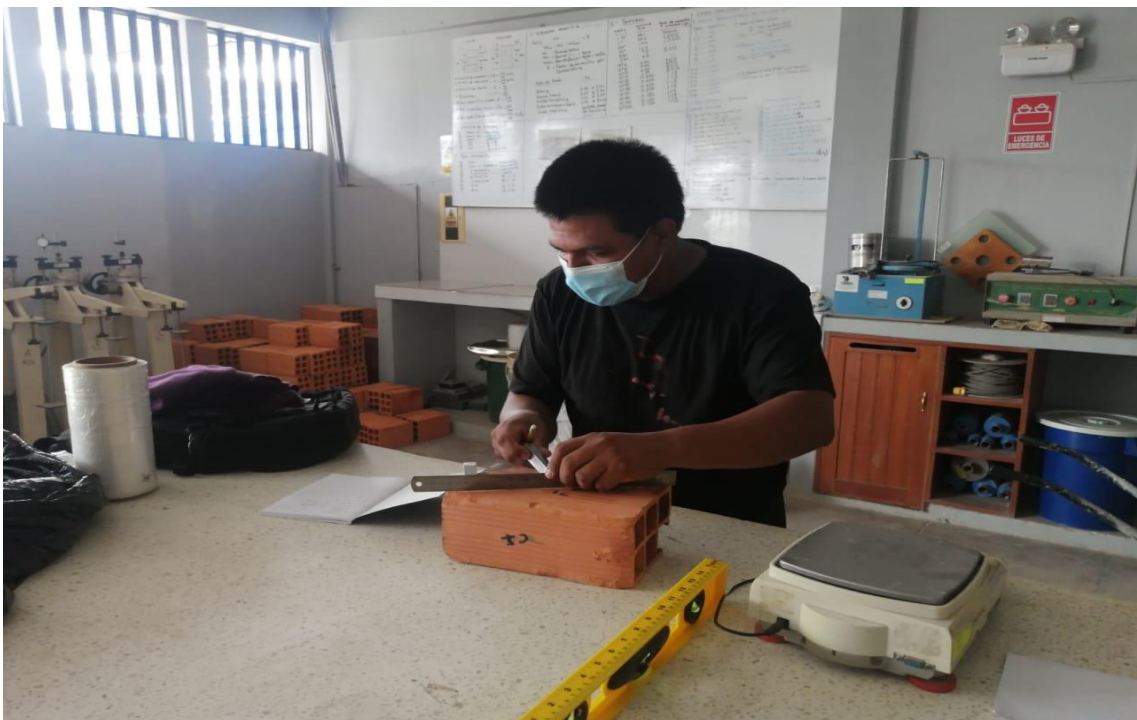
Foto 4. Tomando nota de las medidas de los ladrillos para el ensayo de Variación Dimensional. Se realizó midiendo 50 unidades de cada ladrillera, así como el diseñado por los tesistas. Se anotó cada medida en una tabla que luego fue vaciada en una ficha de datos.
