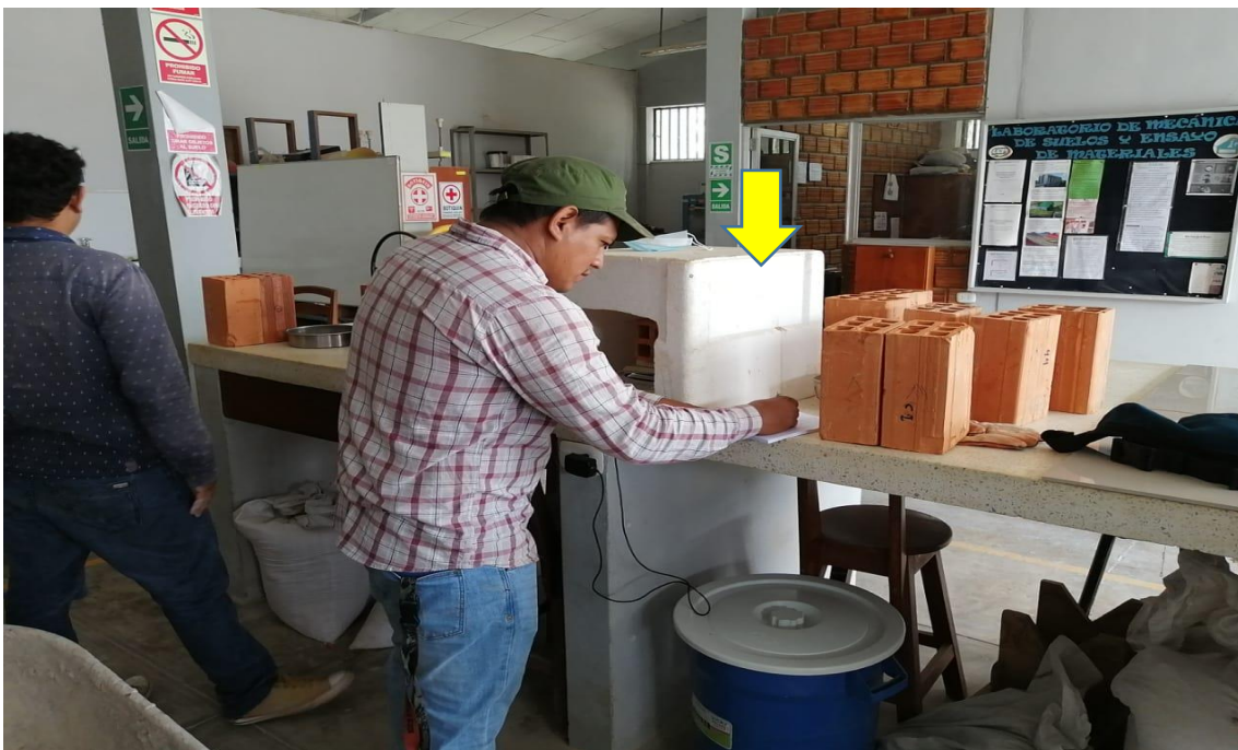
Foto 6. Luego de secar los ladrillos en el horno. Se pesan en una balanza digital, proporcionada por el laboratorio, debidamente calibrada. La caja de Tecnopor que se aprecia, sirve para evitar corrientes de aire en el lugar, que puedan modificar el peso. Esto se realiza a fin de obtener el peso seco más exacto posible.
