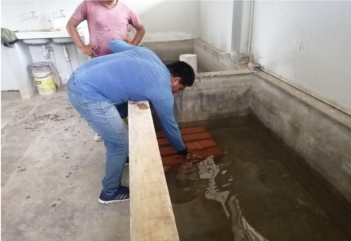
Foto 7. Sumergiendo ladrillos en agua para observar su porcentaje de absorción.
