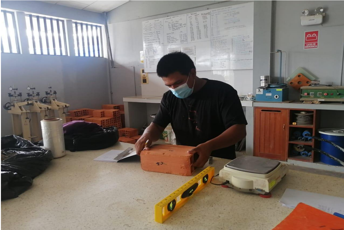
Foto 3. Tomando medidas de ladrillos.
