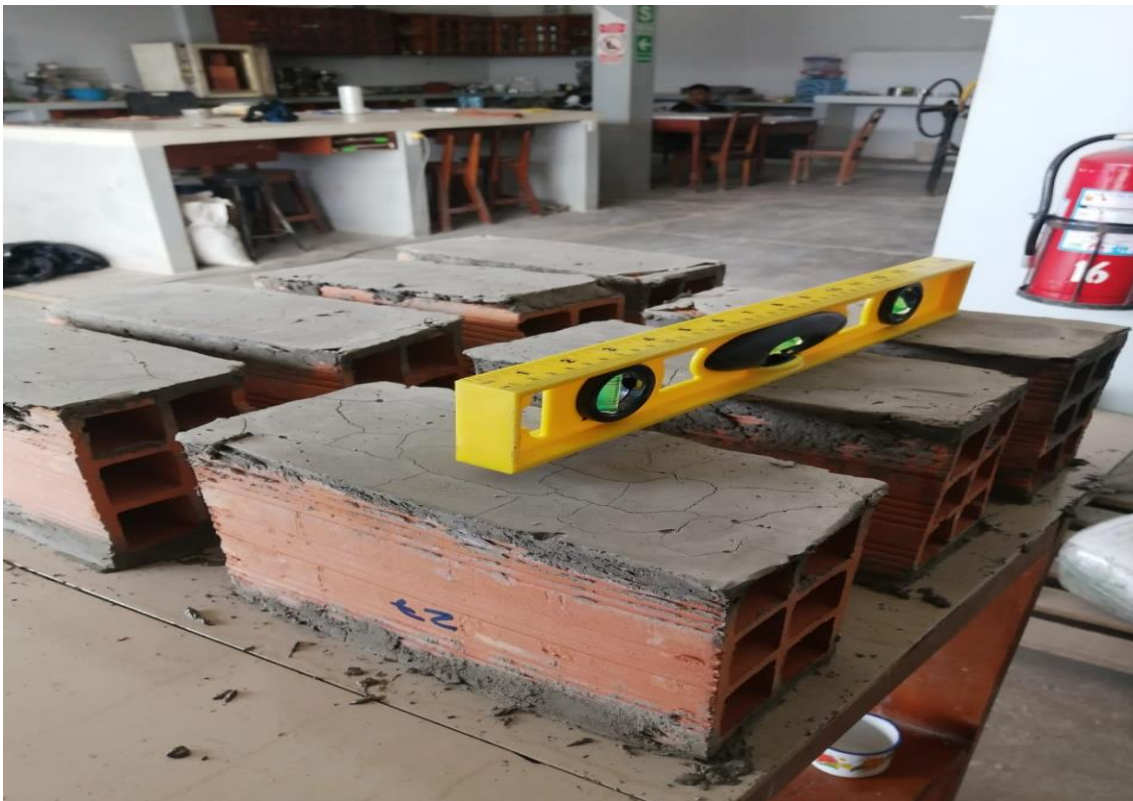
Foto 10. Muestras de ladrillos con capa nivelante, previa a rotura de ensayo de compresión.
