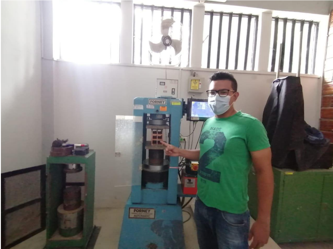
Foto 13. Ensayo de resistencia a la compresión de las unidades de ladrillos.
