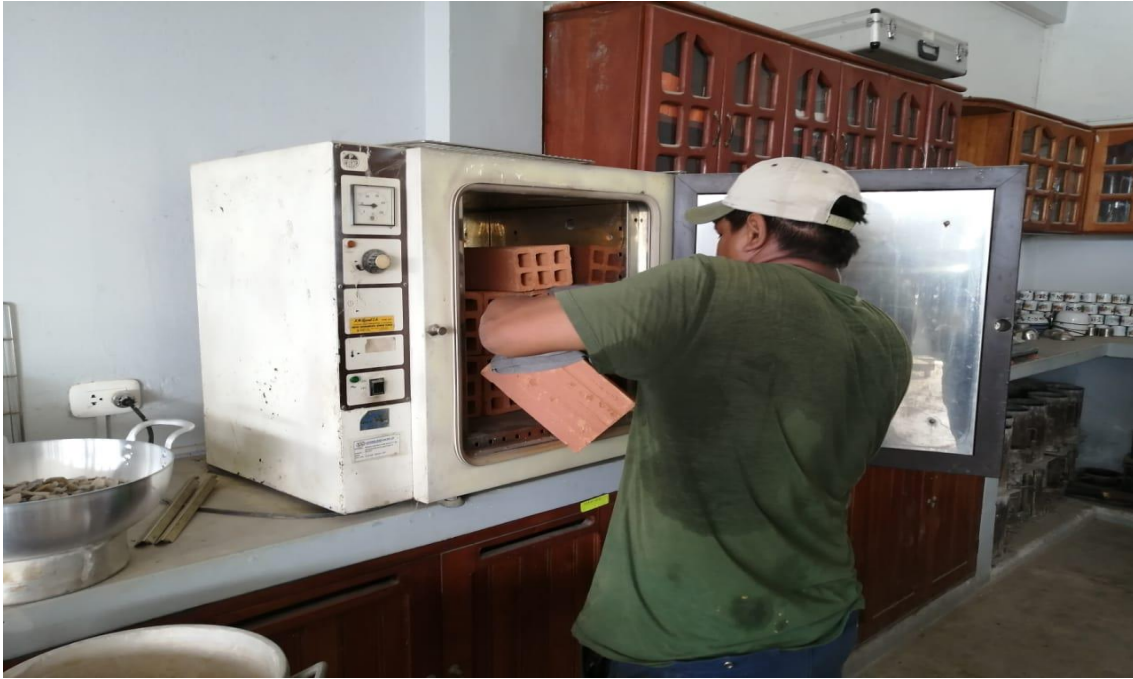
Foto 5. Colocando unidades de ladrillo en horno para determinar peso específico y porcentaje de absorción.
