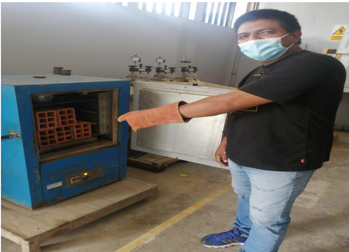
Foto 12. Unidades de ladrillos retiradas del horno luego de 24 horas.
