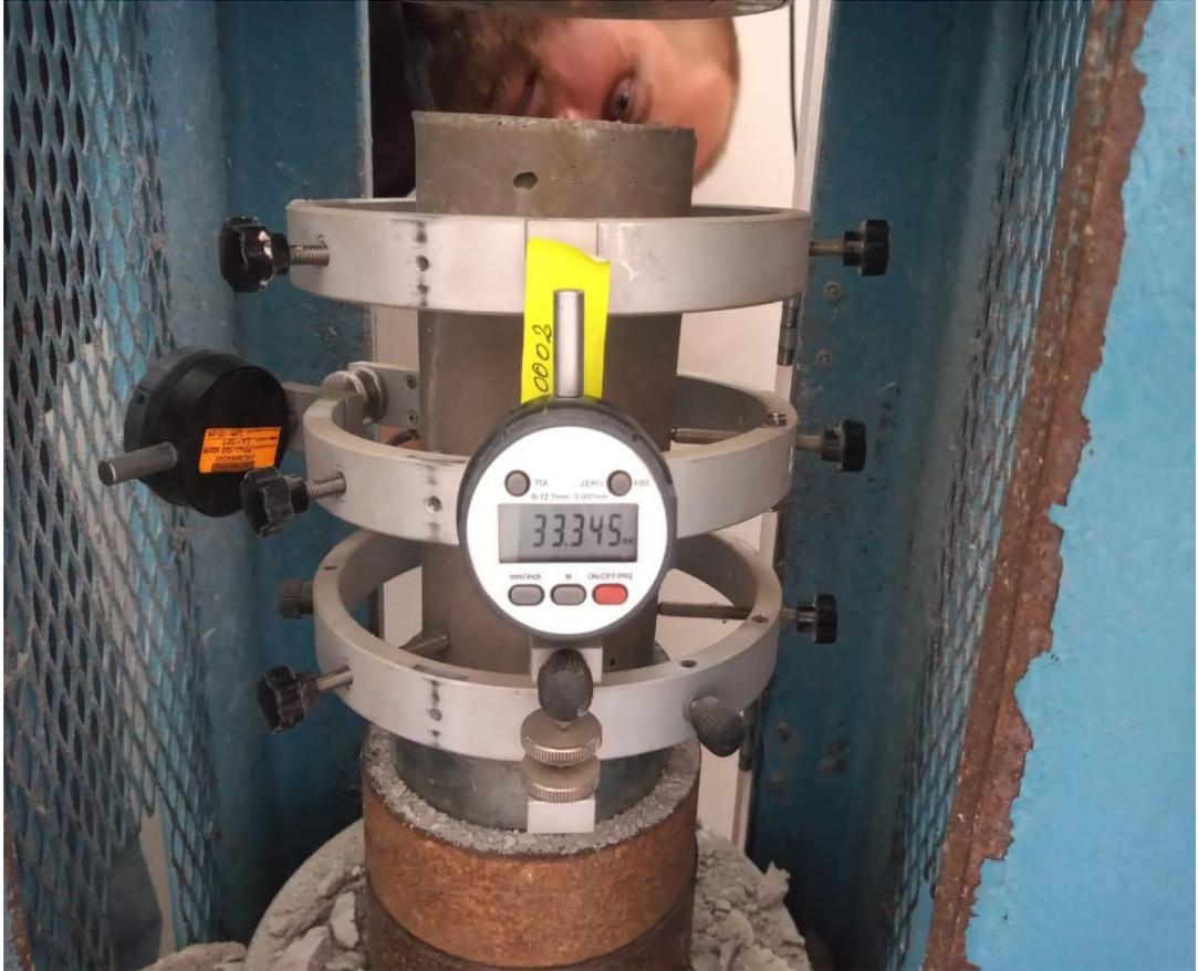
Ensayo de Módulo de elasticidad y Módulo de Poisson, colocación del compresómetro y extensómetro con las medidas de la norma y conectamos ambos a la prensa.
