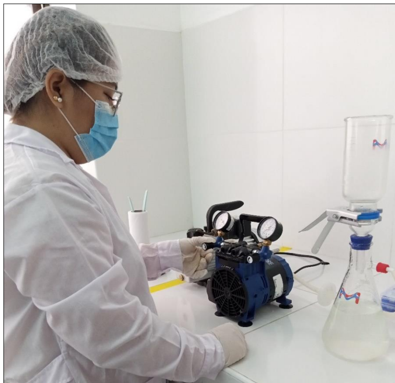
Proceso de filtración al vacío.
