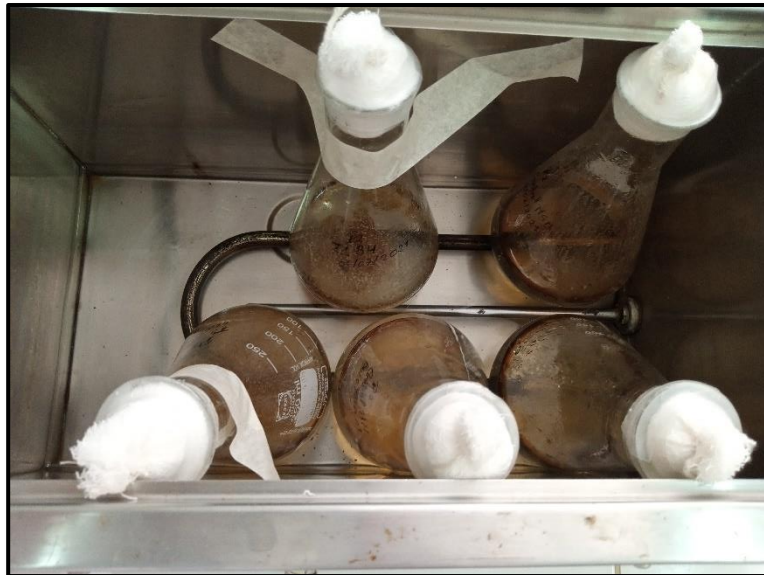
Ensayo utilizando un baño María a 50°C.
