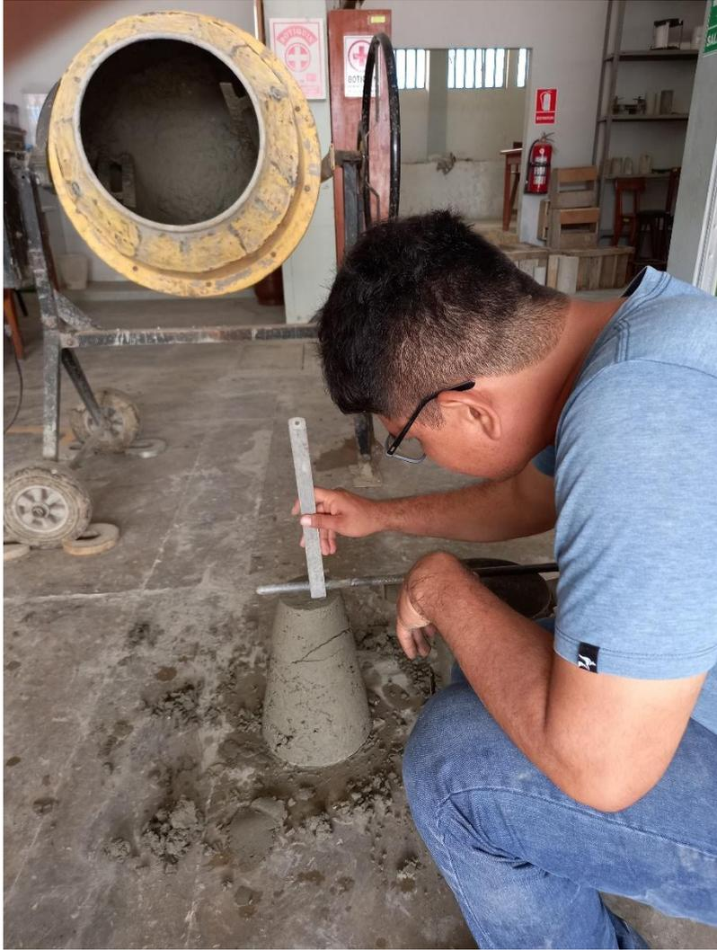
Ensayo de asentamiento (slump)
