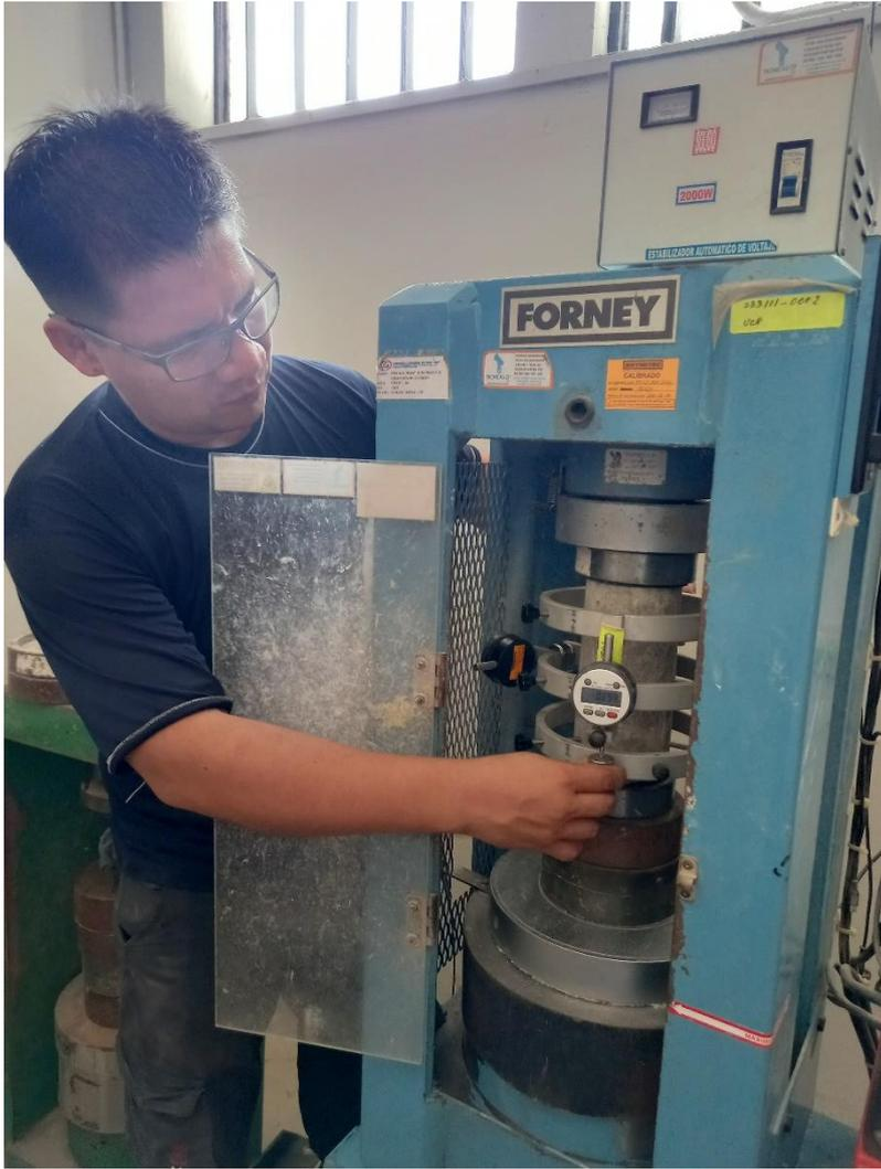
Ensayo de módulo elástico y de Poisson
