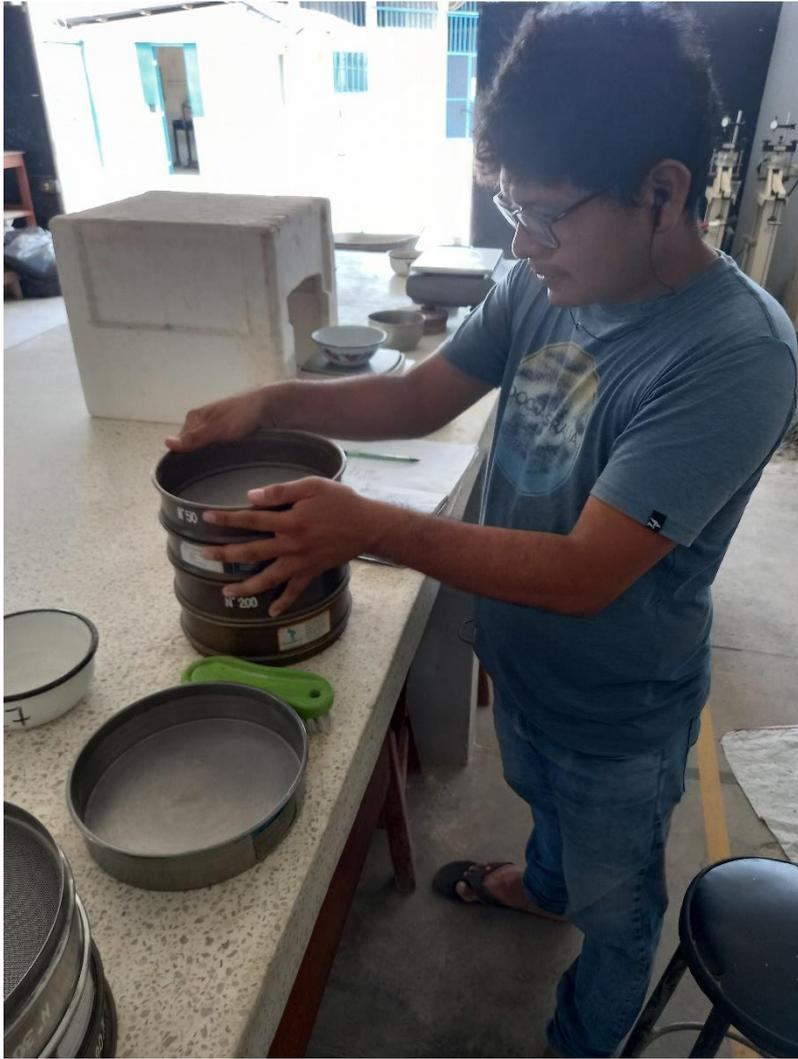
Granulometría del agregado fino – el tamizado
