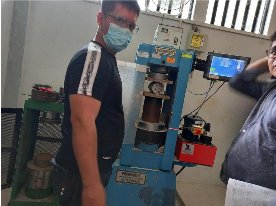
Ensayo de tracción indirecta.
