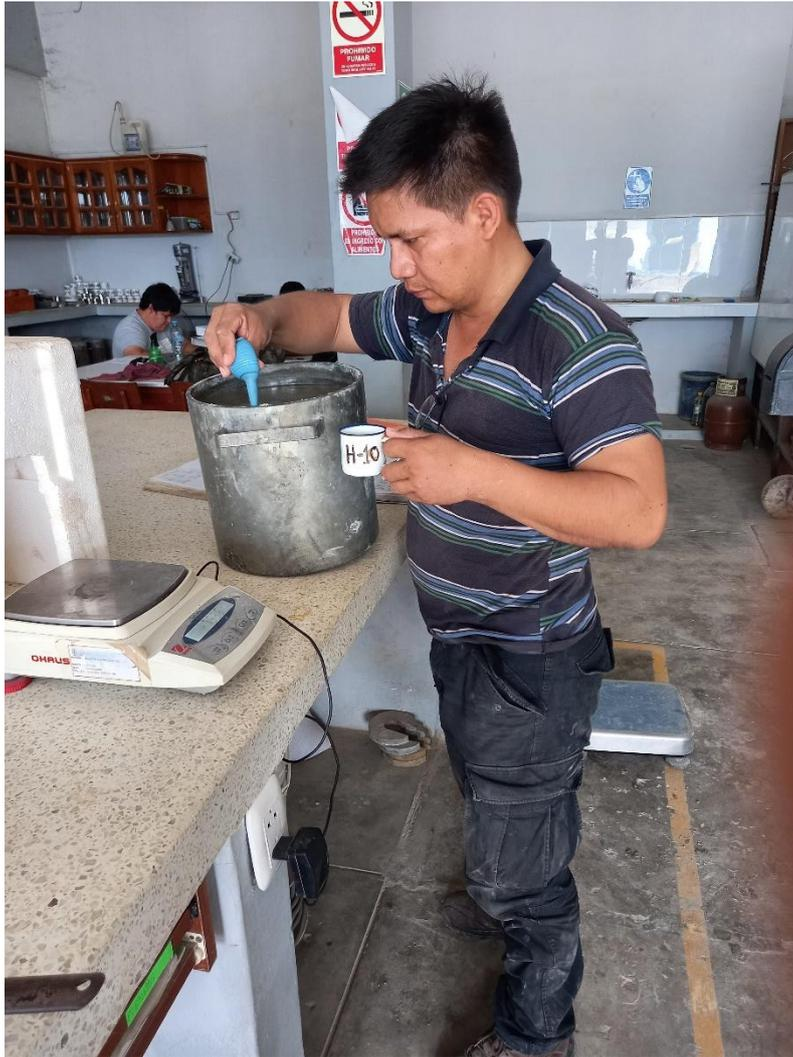
Ensayo de exudación.
