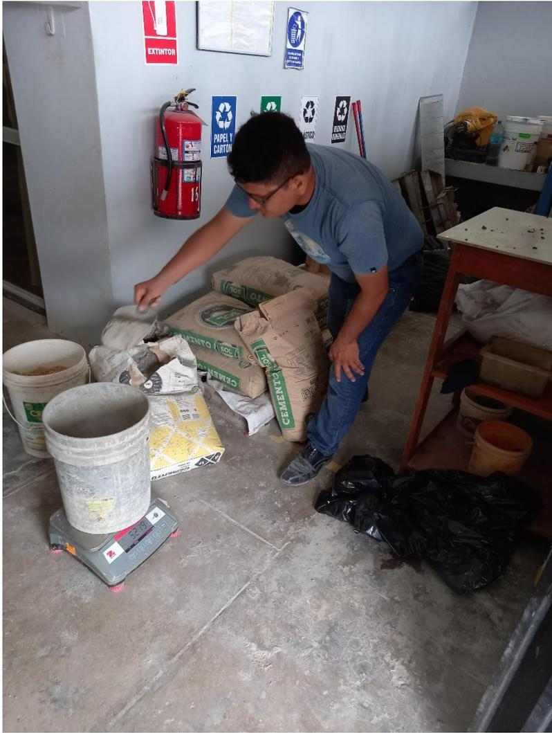
Dosificación del cemento para el diseño
