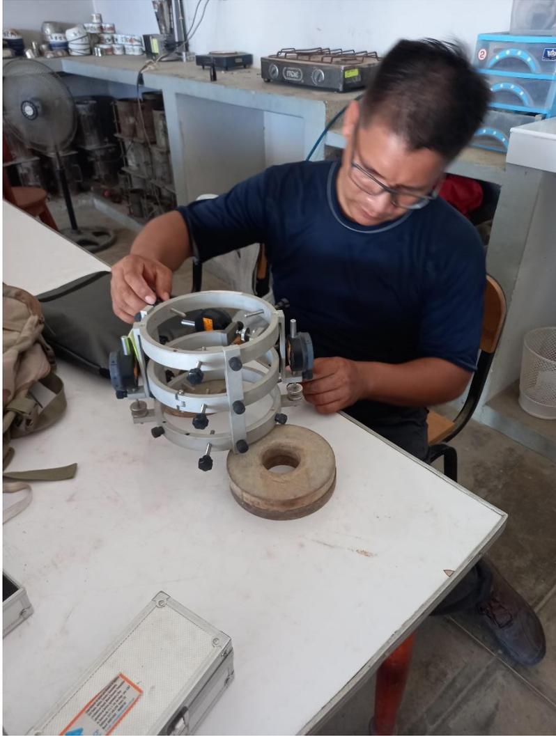
Ensayo de módulo elástico y de Poisson
