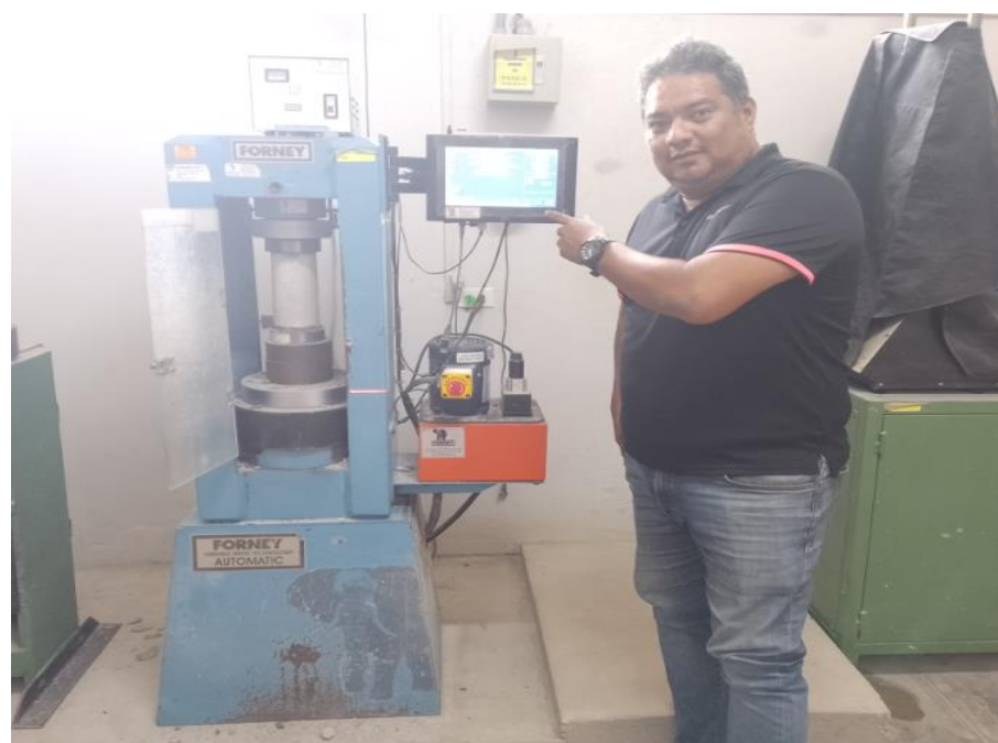
Fotografía 16: Ensayos de resistencia a la compresión.
