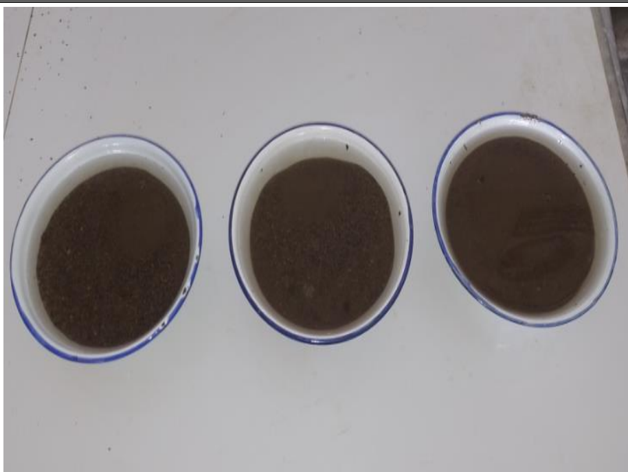
Fotografía 7: Muestras en agua durante 24 horas.
