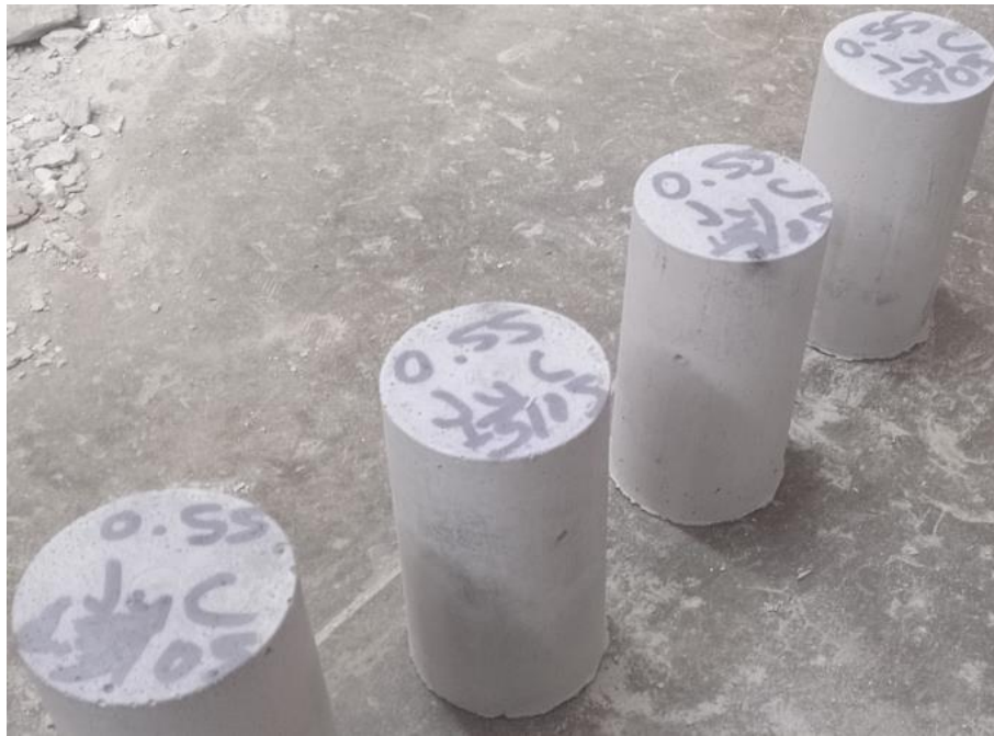
Fotografía 15: Probetas para ser sometidas a ensayos de resistencia a la compresión.
