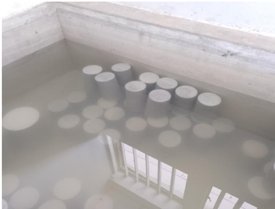
Fotografía 14: Curado de probetas cilíndricas.
