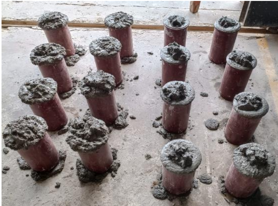
Fotografía 13: Colocación del concreto en las probetas cilíndricas.
