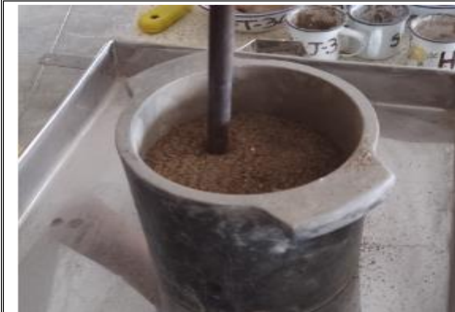
Fotografía 6: Colocación de la muestra en molde y varillado para el peso unitario compactado.
