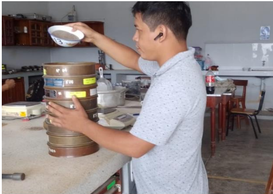
Fotografía 4: Análisis granulométrico por tamizado.
