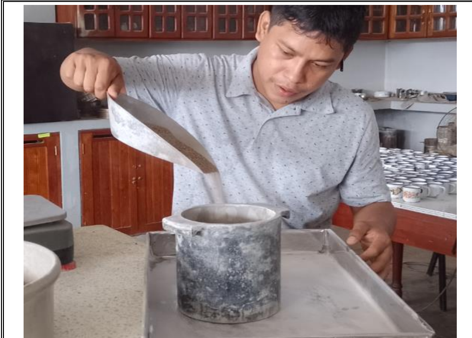
Fotografía 5: Colocación de la muestra en molde y enrase para el peso unitario suelto.
