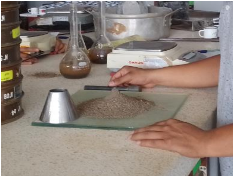
Fotografía 8: Verificación de la arena si está completamente seca.
