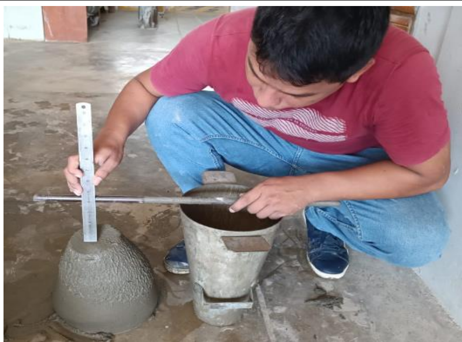
Fotografía 11: Medición del asentamiento (slump) para verificar la consistencia de la mezcla.
