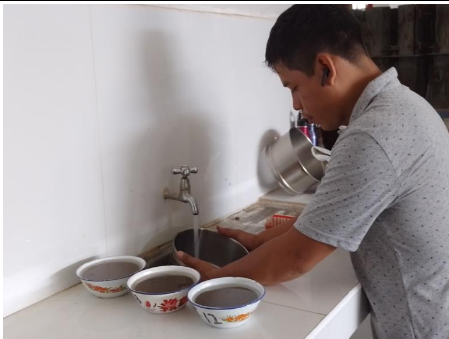
Fotografía 9: lavado de la muestra en el tamiz N° 200.
