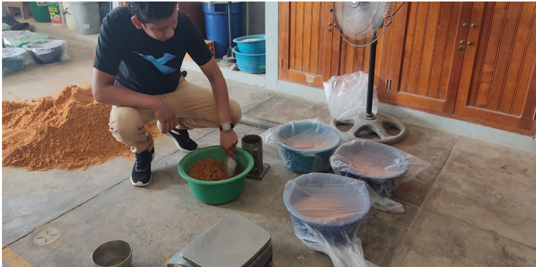
Pesado de suelo natural mezclado con 0.5% de cemento portland y 0.3% Terrasil para los ensayos Proctor
