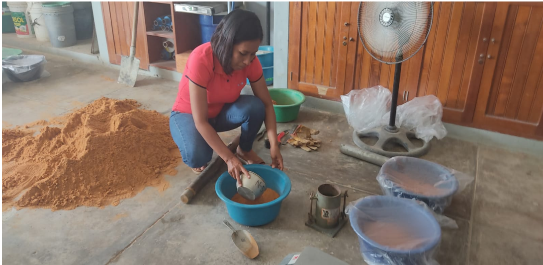
Mezclado del agua con el material natural para realización del ensayo Proctor Laboratorio de Mecánica de Suelos y Ensayos de materiales UCP
