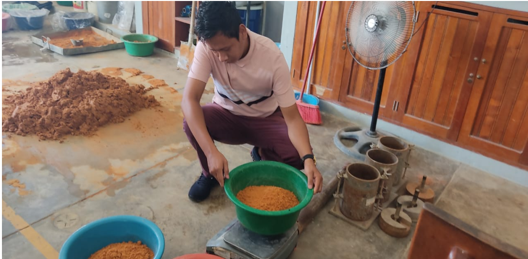
Pesado de suelo natural para la realización de ensayo Proctor Laboratorio de Mecánica de Suelos y Ensayos de materiales UCP
