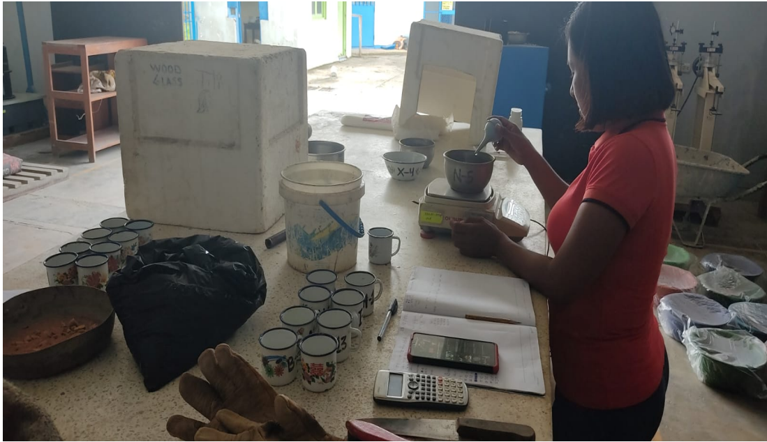
Control de peso del agua para aplicar a material en los ensayos de Proctor Laboratorio de Mecánica de Suelos y Ensayos de materiales UCP
