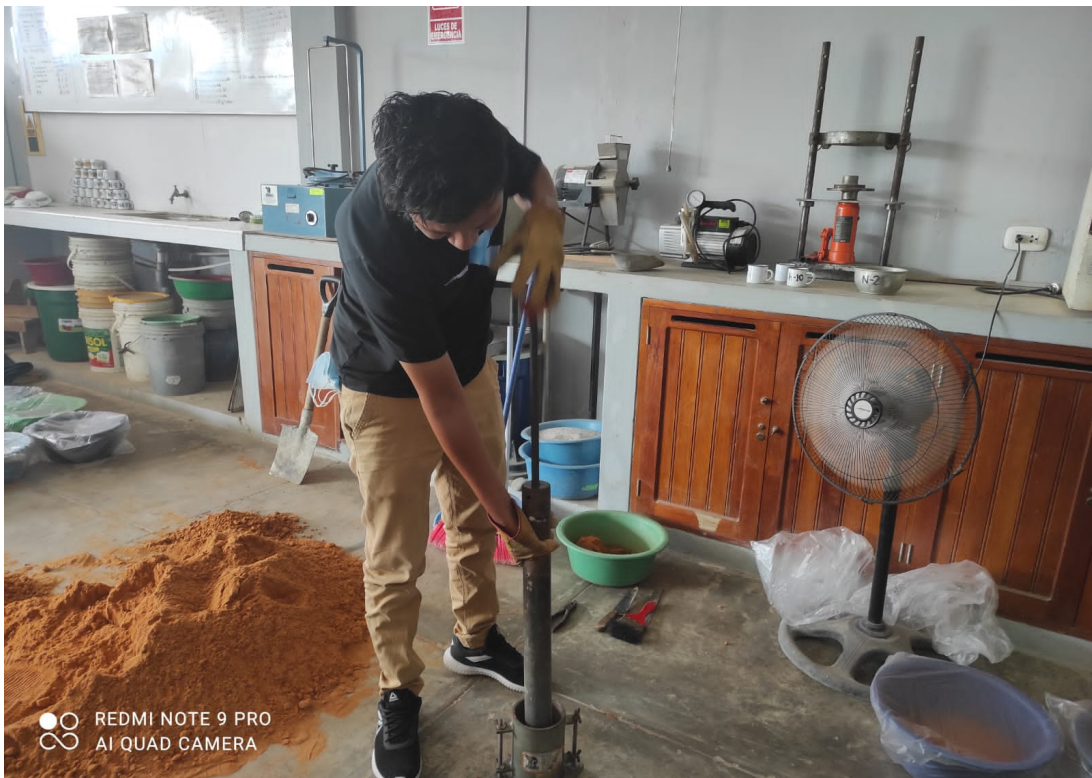
Compactación correspondiente de muestra suelo natural para los ensayos Proctor
