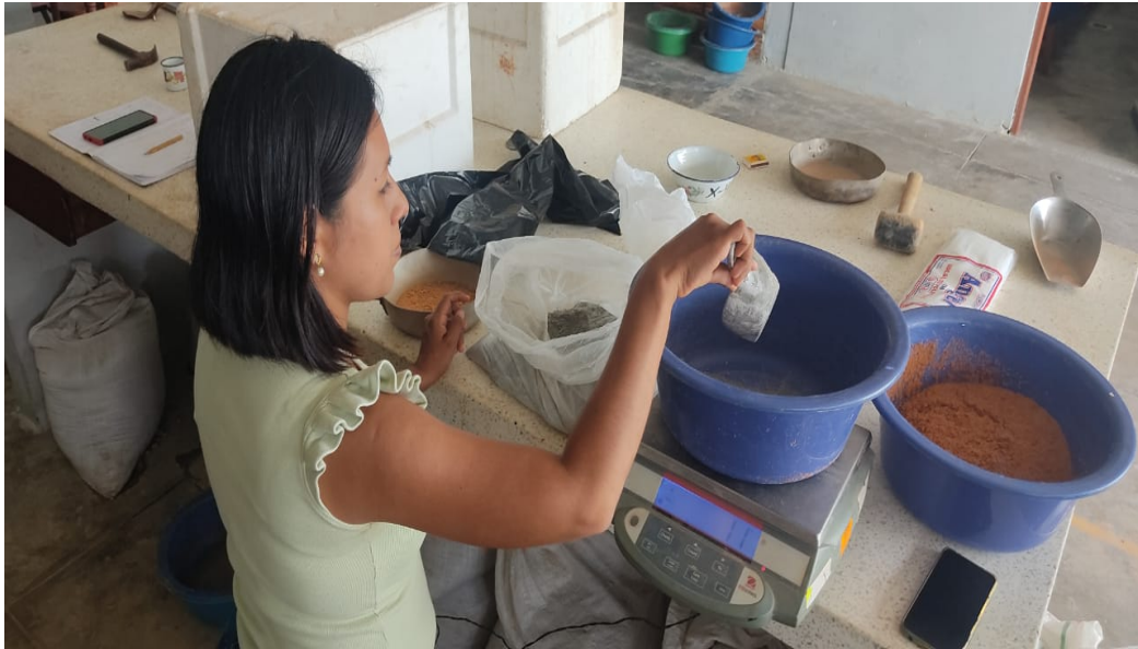
Pesado de material areno limoso arcilloso para ensayos Proctor Laboratorio de Mecánica de Suelos y Ensayos de materiales UCP
