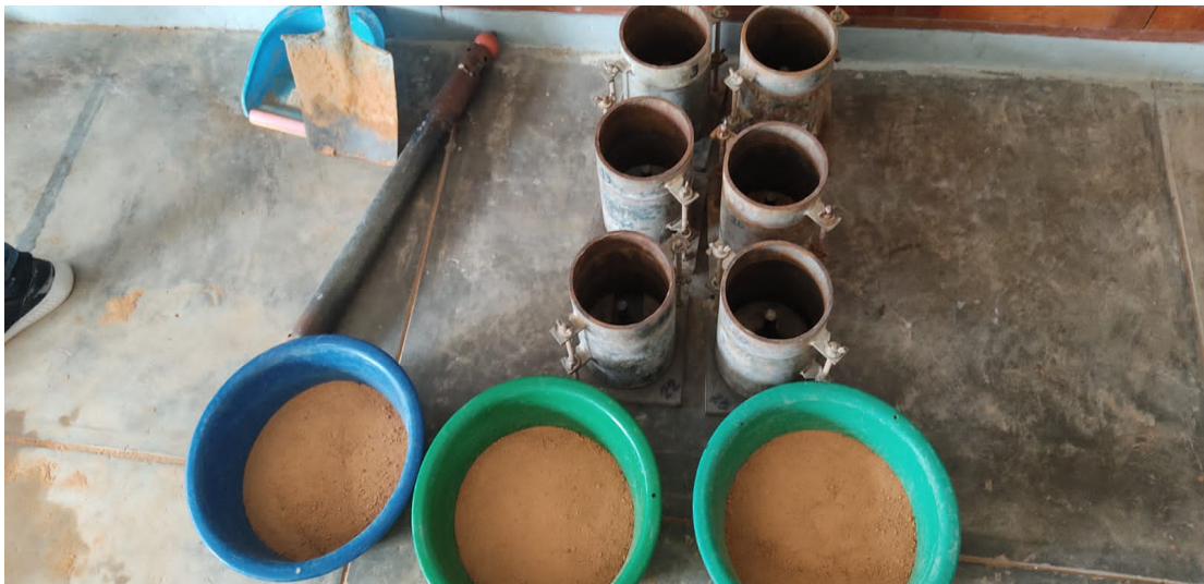
Muestra de suelo natural para realizar los ensayos Proctor Laboratorio de Mecánica de Suelos y Ensayos de materiales UCP
