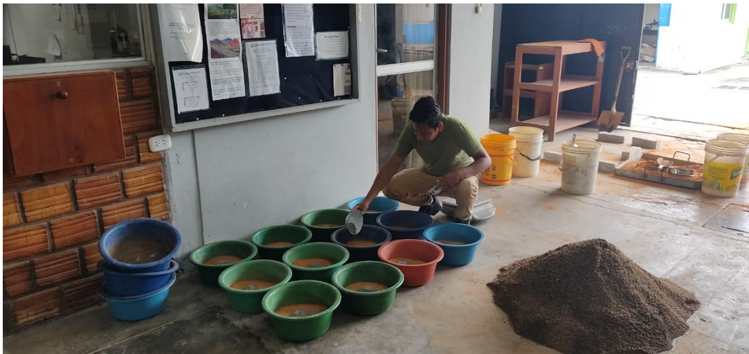
Agregado de 0.5% de cemento portland al suelo natural para los ensayos Proctor
