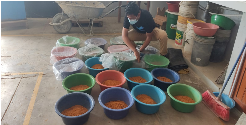
Cubrimiento de las muestras como prevención de absorción de humedad Laboratorio de Mecánica de Suelos y Ensayos de materiales UCP
