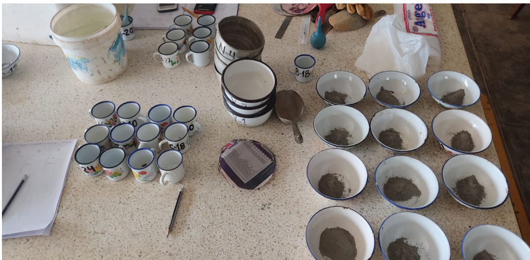
Pesado de cemento de mezclado con el suelo natural para los ensayos Proctor Laboratorio de Mecánica de Suelos y Ensayos de materiales UCP
