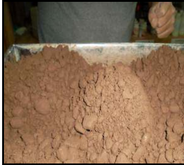
Ilustración 6: Preparado de muestra de la Cantera Propuesta para ensayo de Proctor Modificado
