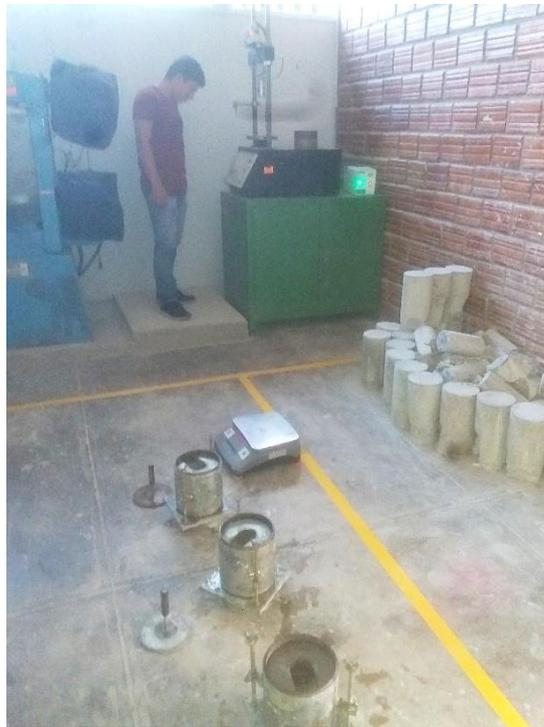
**Figura 25. Moldes listos para ensayo de penetración**
