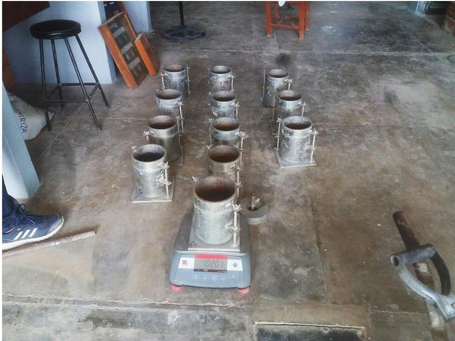
**Figura 21. Pesaje de moldes previo ensayo C.B.R**
