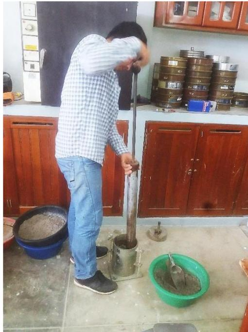
**Figura 22. Compactación para ensayo C.B.R.**
