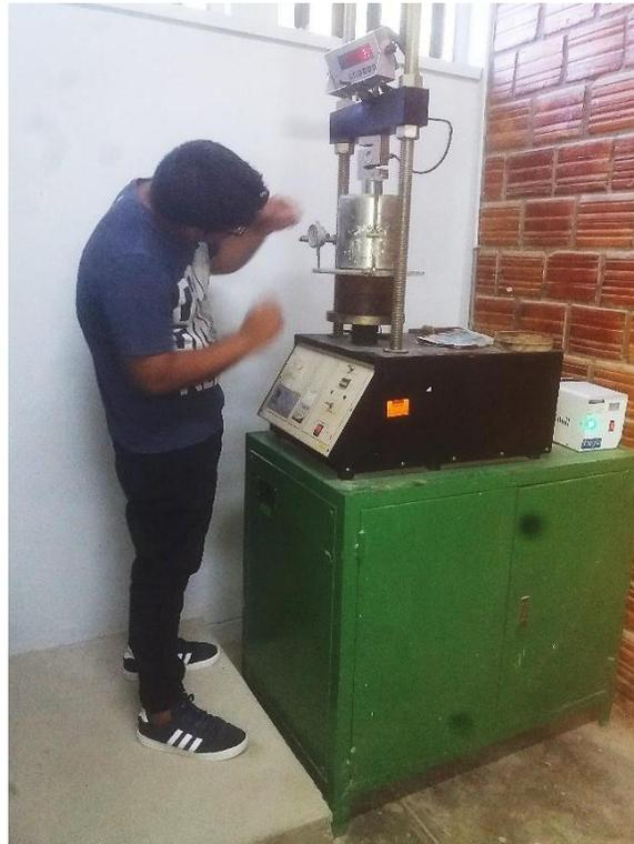
**Figura 26. Calibración de máquina de compresión equipada con un pistón de penetración CBR**
