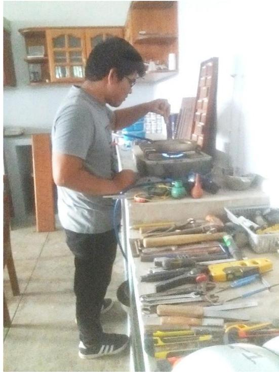
**Figura 18. Determinación de humedad previo ensayo Proctor modificado**
