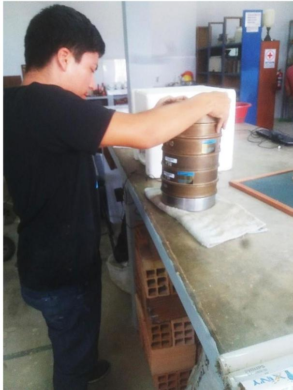
**Figura 17. Análisis granulométrico por tamizado**
