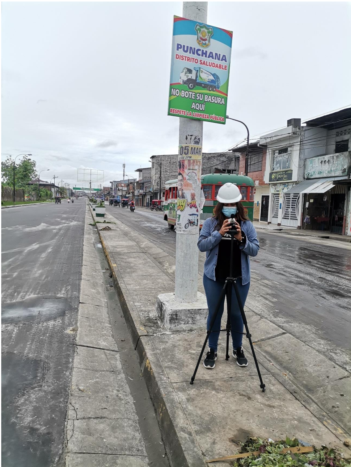
Figura 11. Monitoreo de la Avenida Navarro Cauper con el Sonómetro digital tipo 2 (TENMARS Modelo TM-103)
