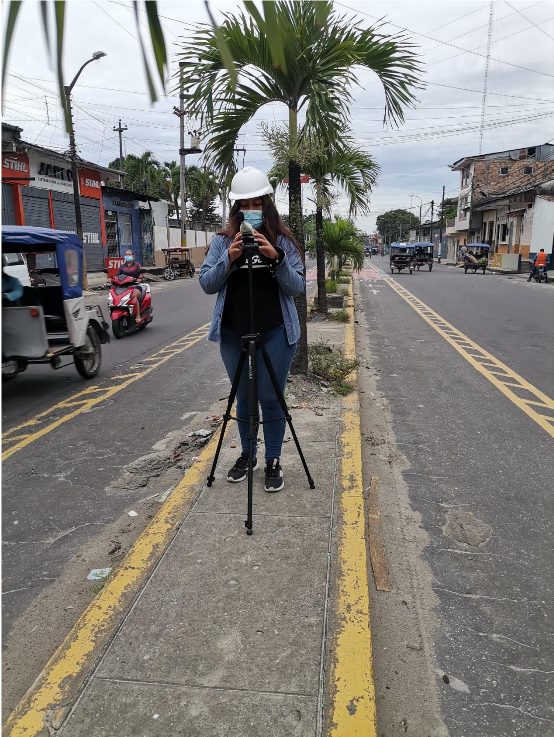
Figura 08. Monitoreo de la Avenida la Marina con el Sonómetro digital tipo 2 (TENMARS Modelo TM-103)
