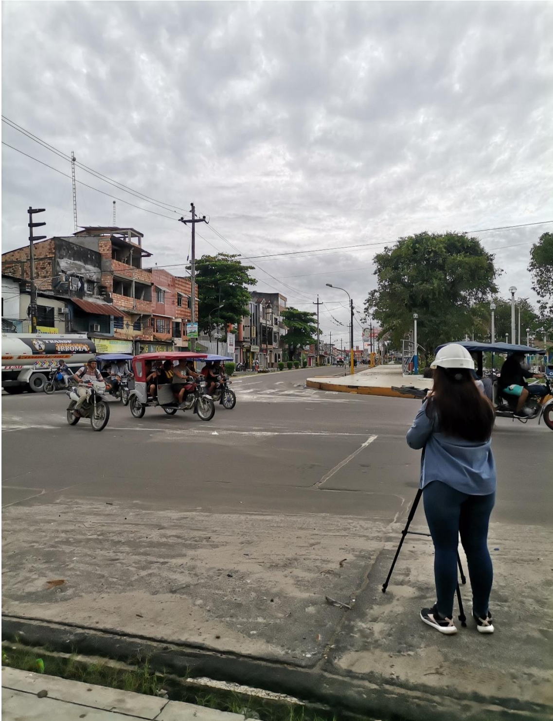
Figura 10. Monitoreo de la Avenida 28 de Julio con el Sonómetro digital tipo 2 (TENMARS Modelo TM-103)
