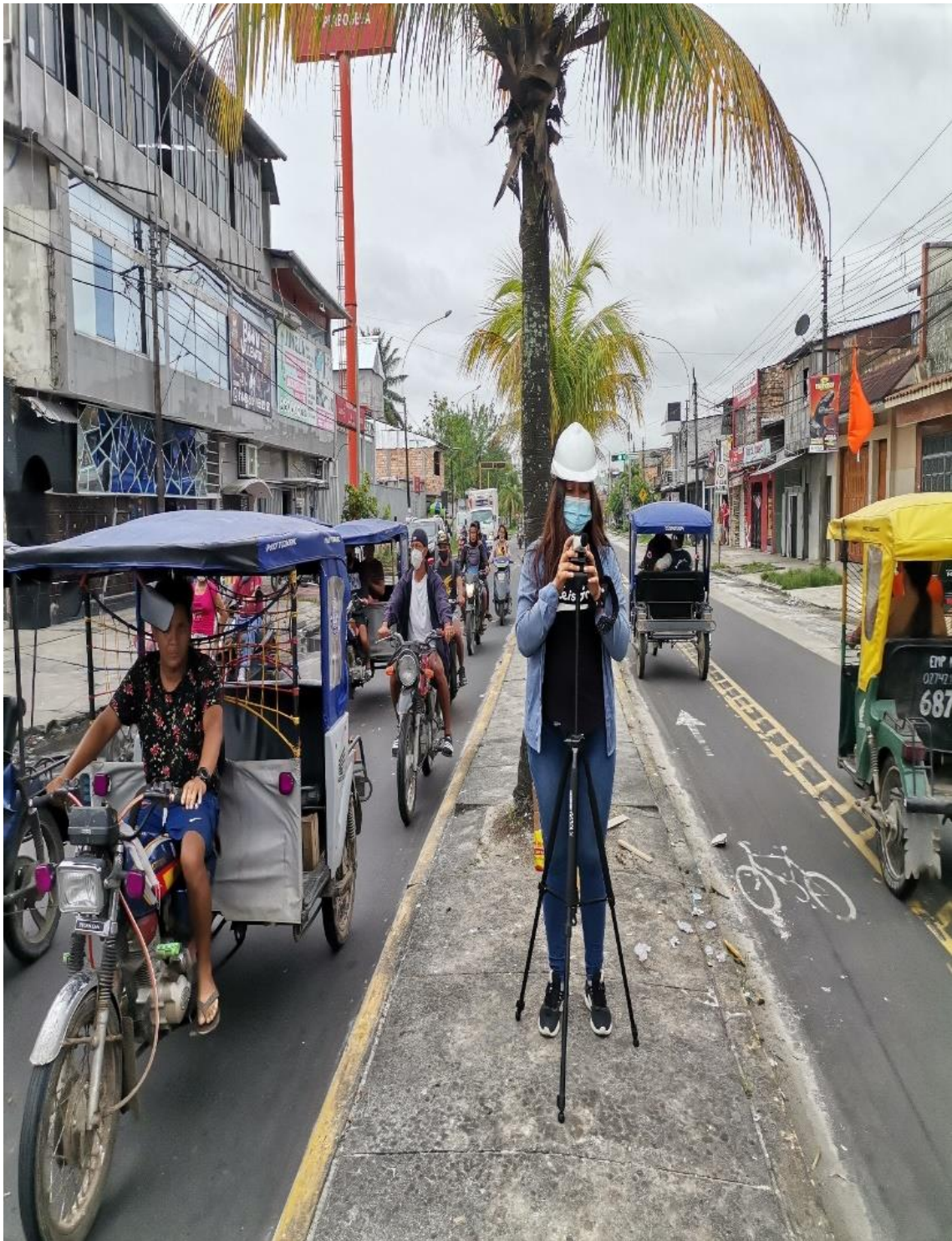
Figura 07. Monitoreo de la Avenida del Ejército con el Sonómetro digital tipo 2 (TENMARS Modelo TM-103)
