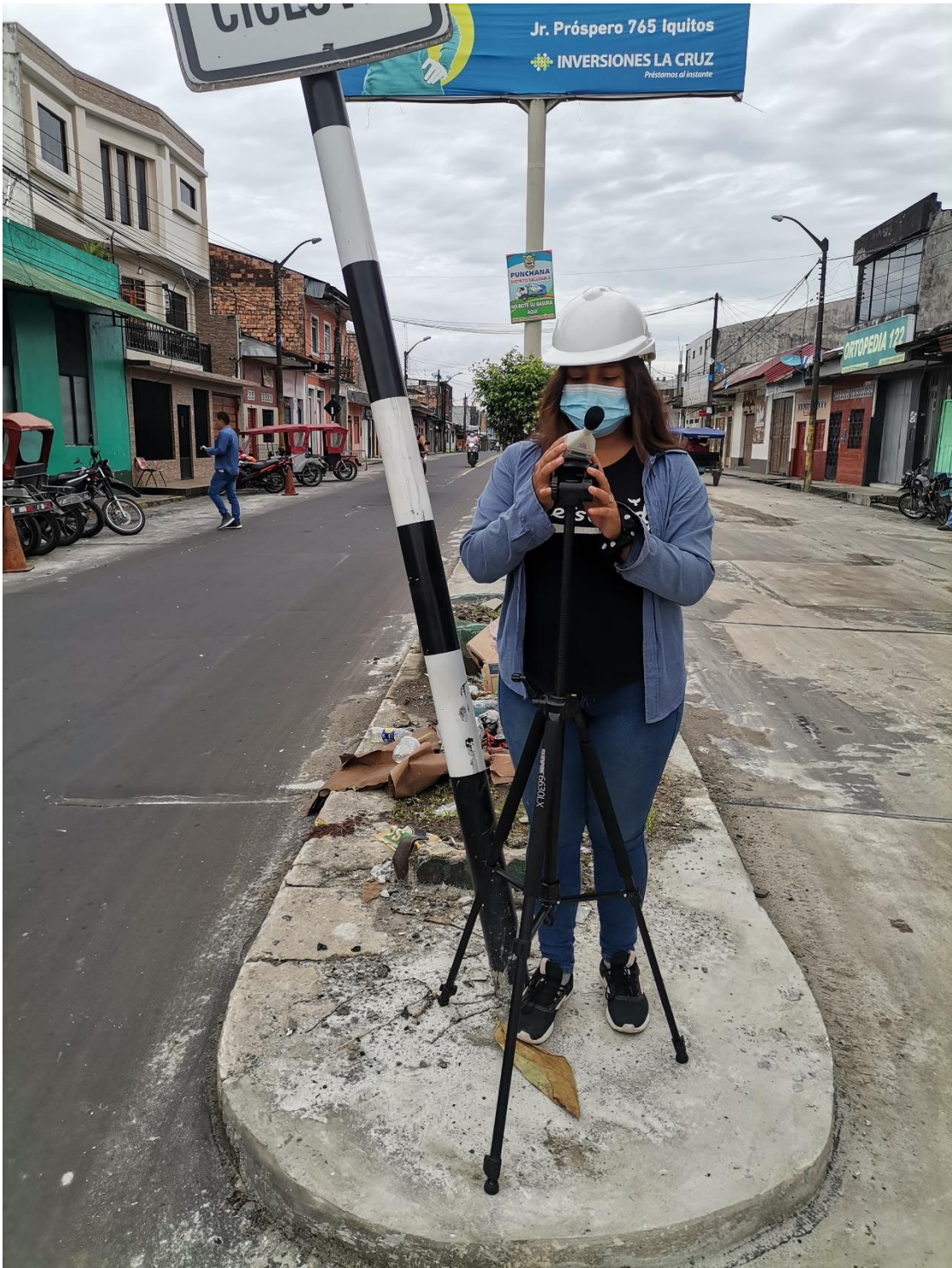
Figura 09. Monitoreo de la Avenida Augusto Freyre con el Sonómetro digital tipo 2 (TENMARS Modelo TM-103)
