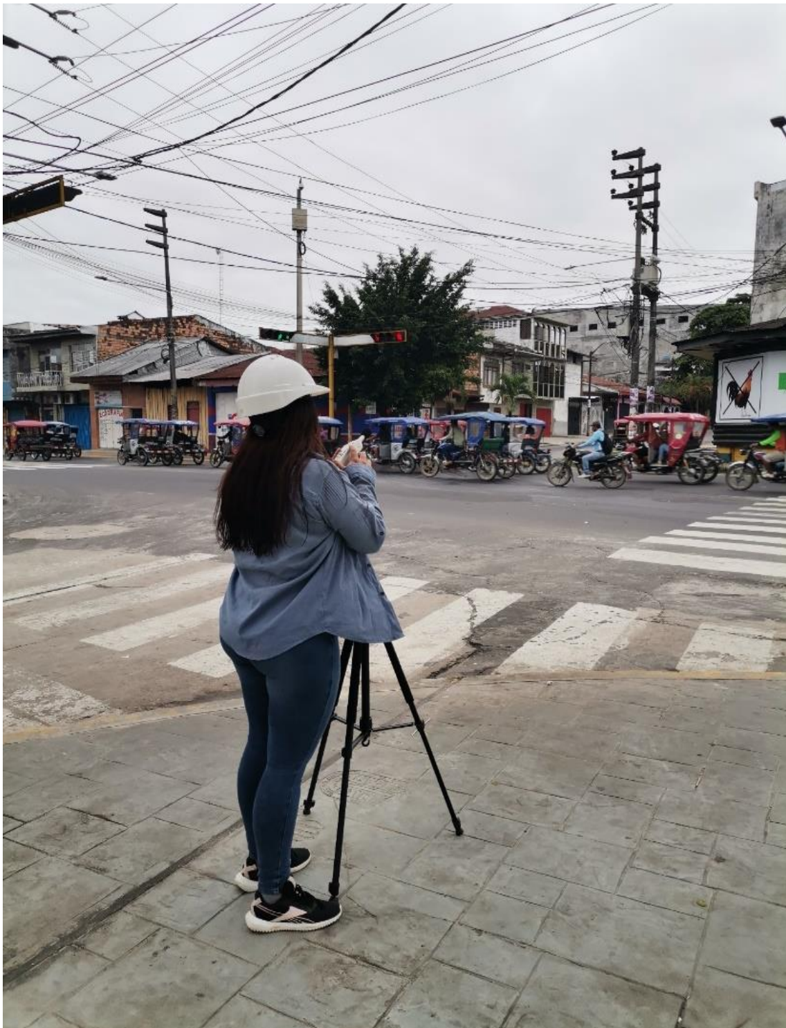
Figura 06. Monitoreo de la Avenida Quiñones con el Sonómetro digital tipo 2 (TENMARS Modelo TM-103)
