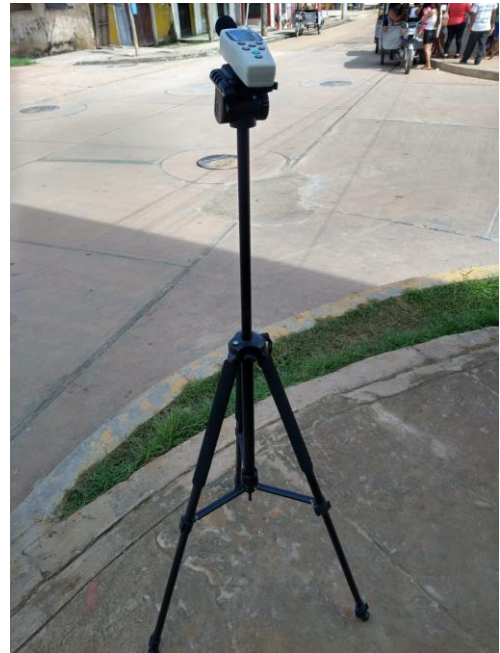
Figura 8. Instalación del Sonómetro TENMARS.
