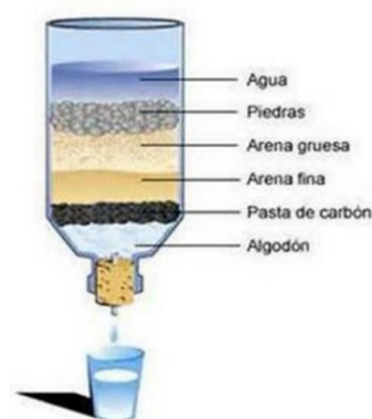
Figura Nº 37: Elaboración del filtro de agua (40)
