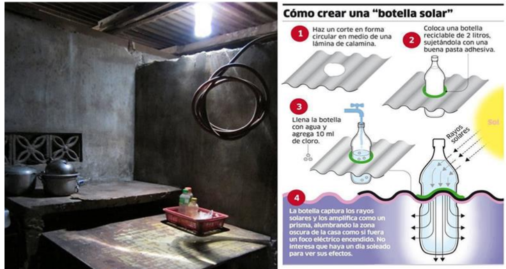
Figura N° 42: Creación de botella solar (46)
