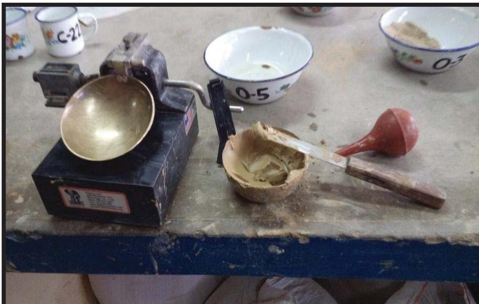
Realizando el ensayo de Casagrande
