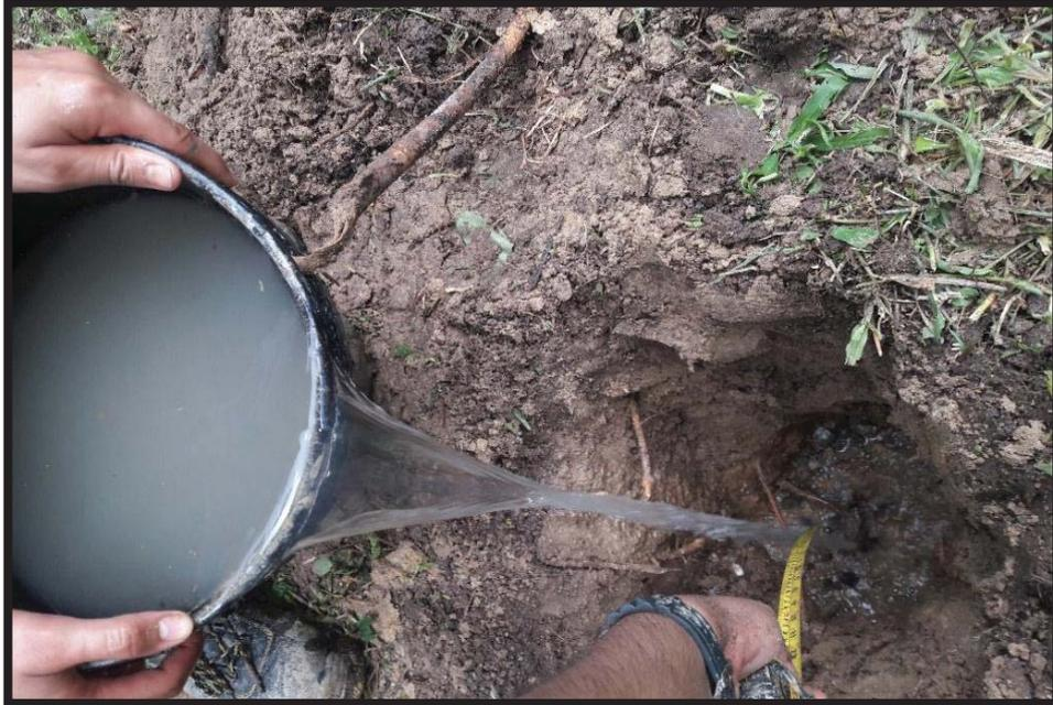
Vertimiento de volumen de agua para prueba de infiltración.
