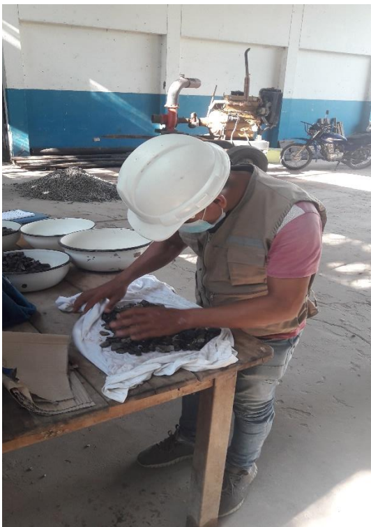
Figura 28: ensayo agregado grueso – peso específico y absorción
