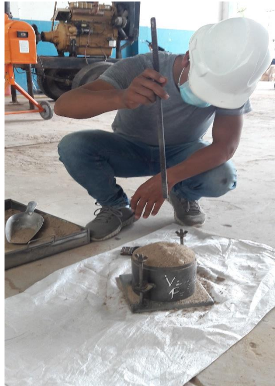
Figura 27: ensayo agregado fino – peso unitario suelto y compactado
