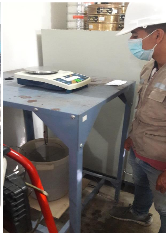
Figura 28: ensayo agregado grueso – peso específico y absorción
