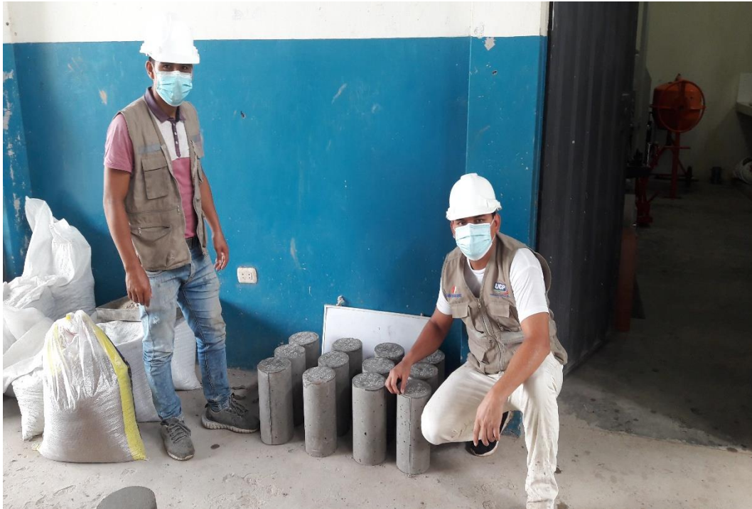
Figura 37: testigos de concretos curados por grupos
