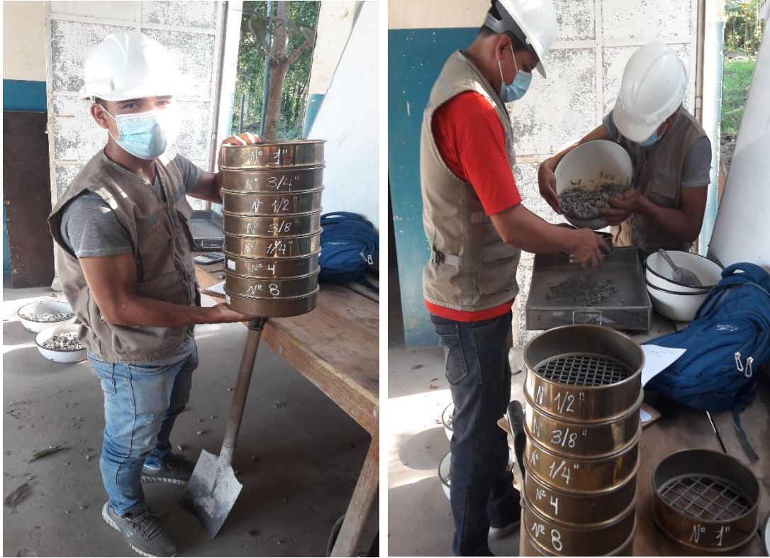
Figura 24: Ensayo de granulometría – agregado grueso
