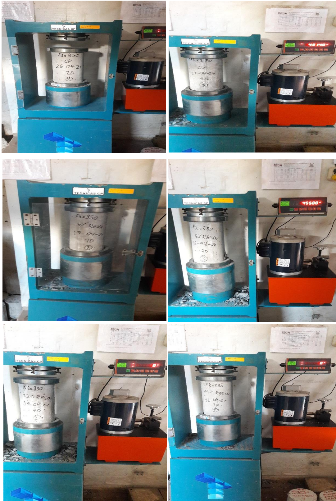
Figura 39: ensayo de rotura de probetas de concreto a 7 días (concreto patrón y adición del 5%, 10% y 15% resina de musa paradisiaca)
