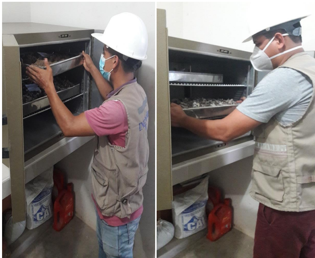
Figura 23: Ensayo de los agregados para humedad.
