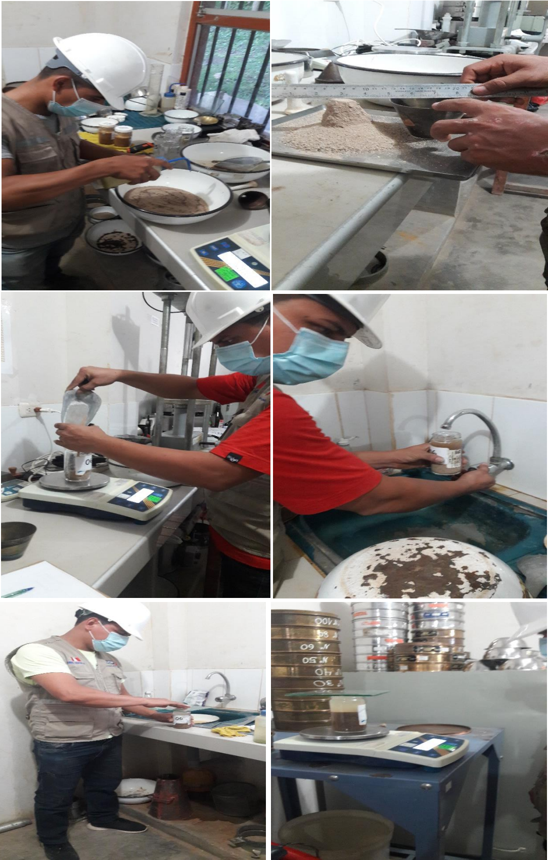
Figura 29: ensayo agregado fino – peso específico y absorción
