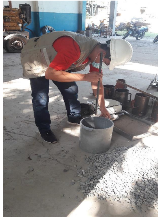
Figura 26: ensayo agregado grueso – peso unitario suelto y compactado
