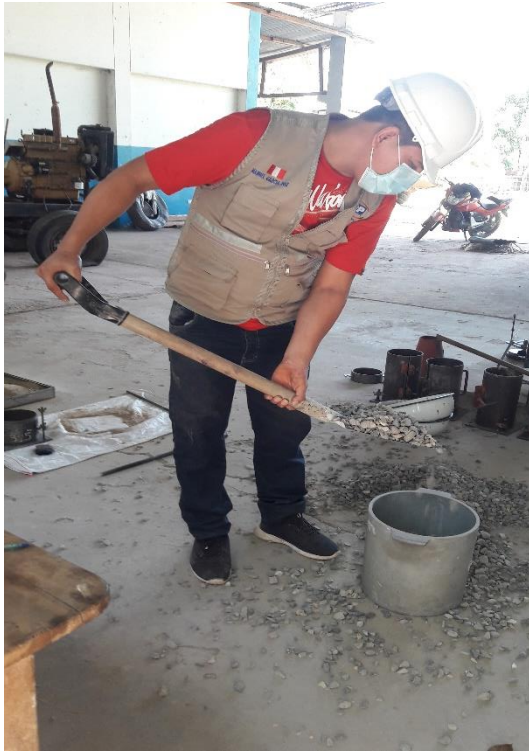
Figura 26: ensayo agregado grueso – peso unitario suelto y compactado
