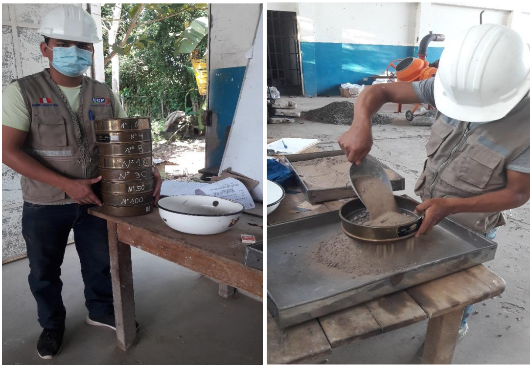
Figura 25: ensayo de granulometría – agregado fino
