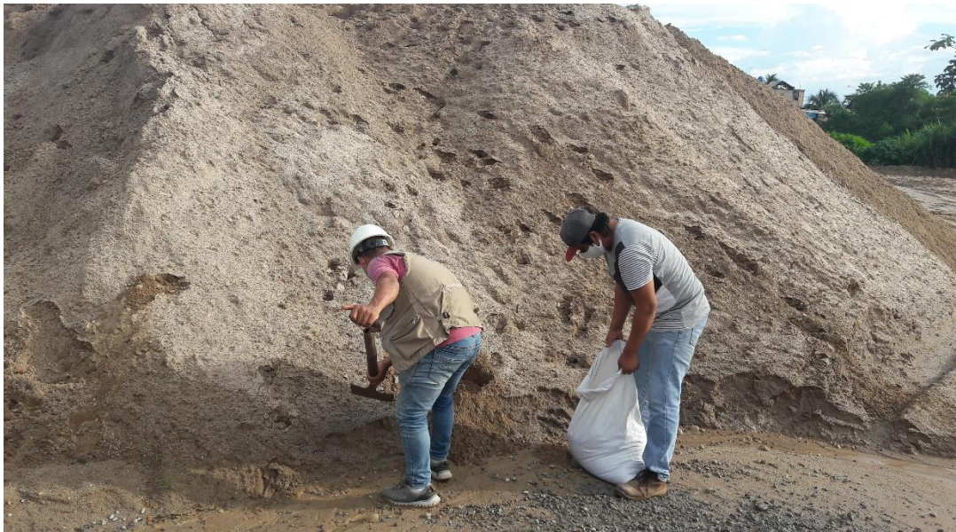
Figura 21: Extracción de material – agregado fino.
