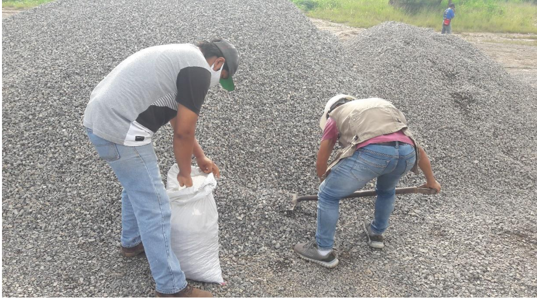
Figura 20: Extracción de material – agregado grueso.
