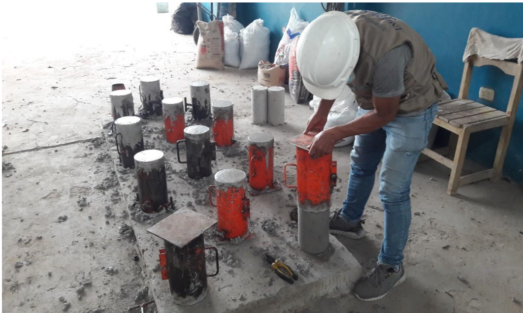
Figura 36: desencofrado de testigos de concreto
