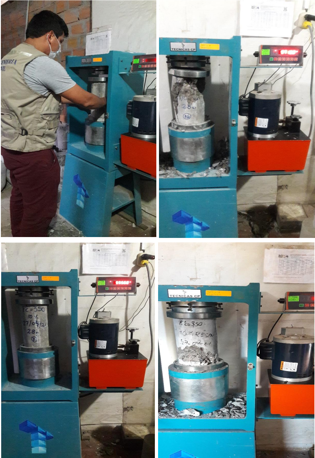
Figura 40: ensayo de rotura de probetas de concreto a 28 días (concreto patrón y adición del 5%, 10% y 15% resina de musa paradisiaca)
