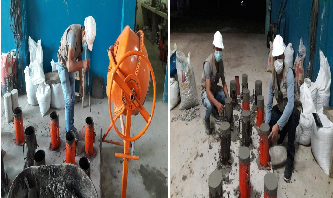
Figura 35: moldeados de testigos de concreto
