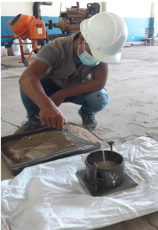
Figura 27: ensayo agregado fino – peso unitario suelto y compactado
