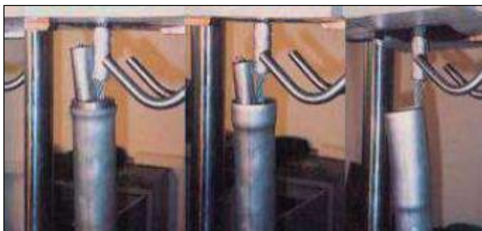
Figura 15: Sistema de frenado a base del ensanchamiento de un tubo de acero
