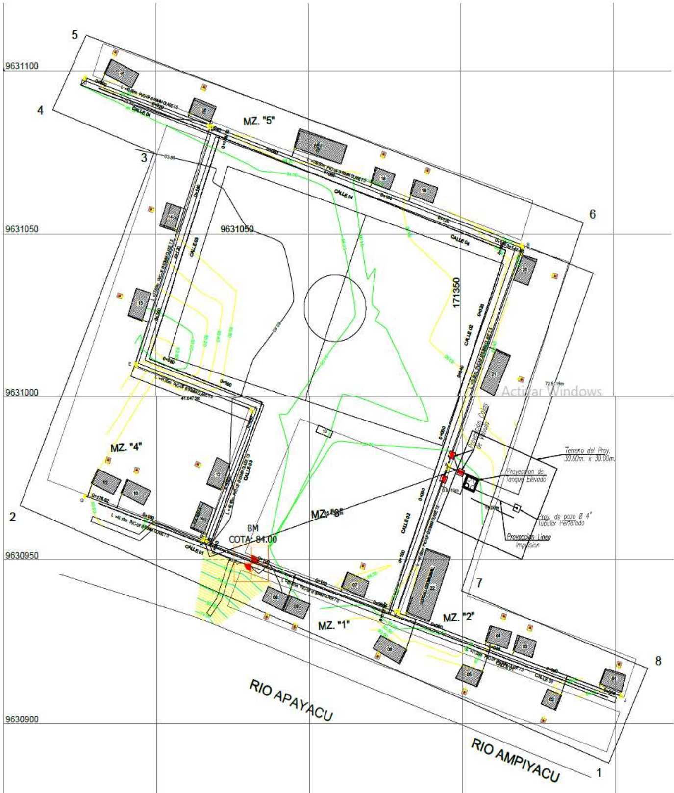
Figura N°05. Plano topográfico con curvas de nivel.
