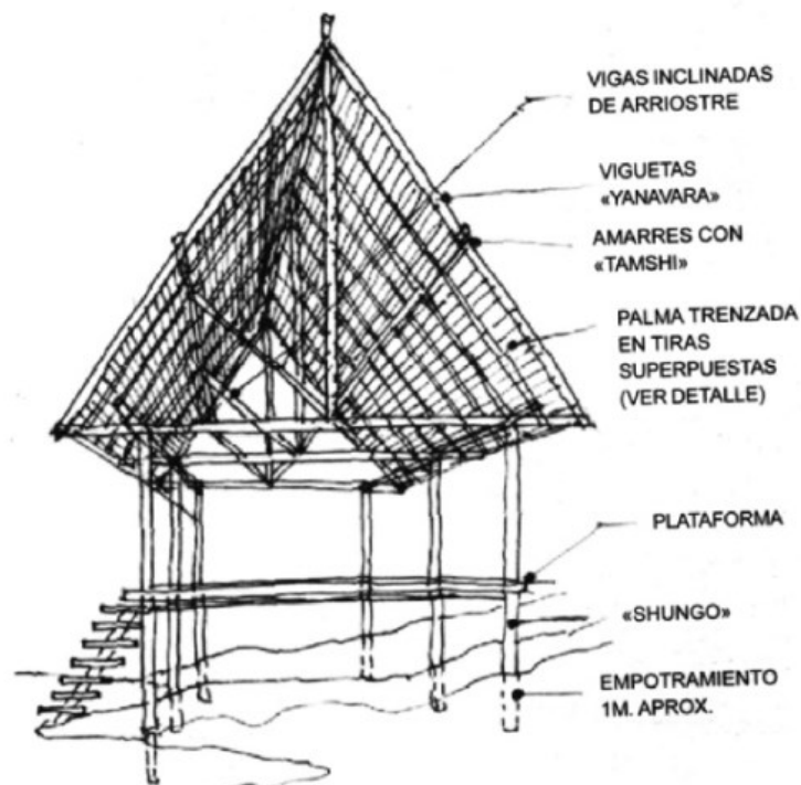
Figura N° 05. Estructura de una maloca
