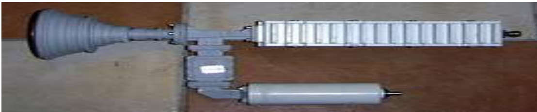
Figuras 4: transmisor(BUC) y el Receptor (LNB)
