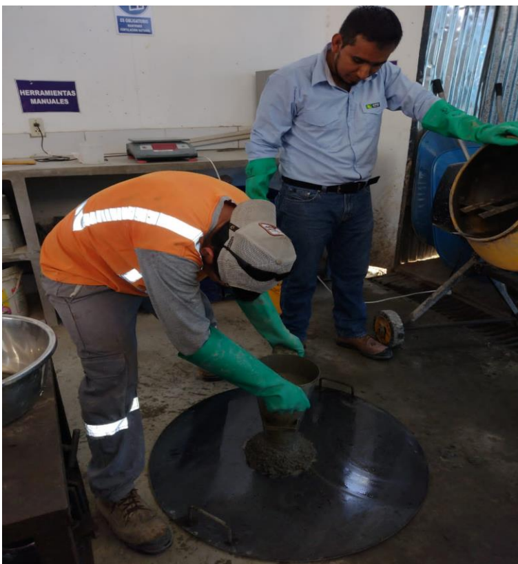
Imagen muestra el desarrollo del ensayo de flujo de asentamiento
