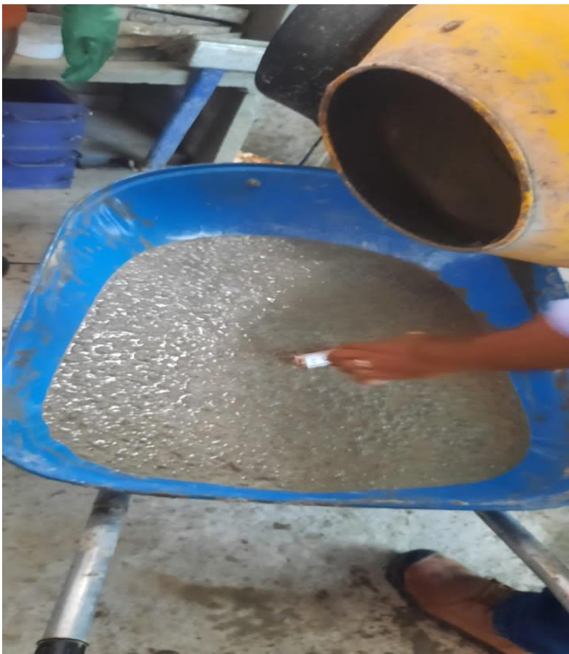
Imagen muestra la evaluación de la temperatura del concreto
