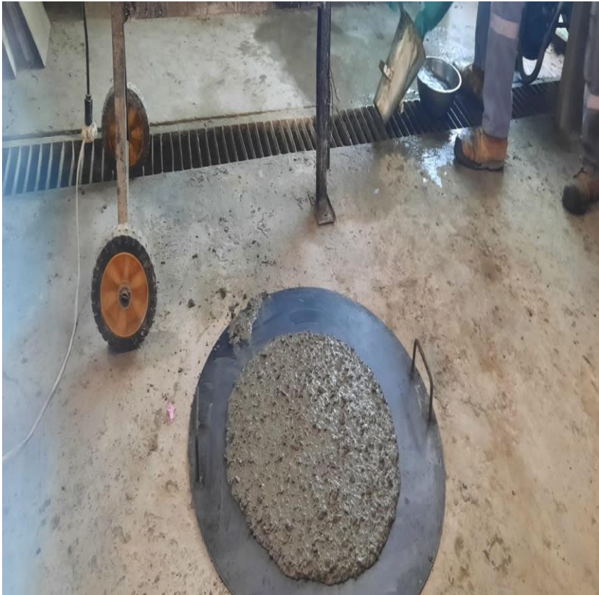
Imagen muestra la fluidez del concreto desarrollado
