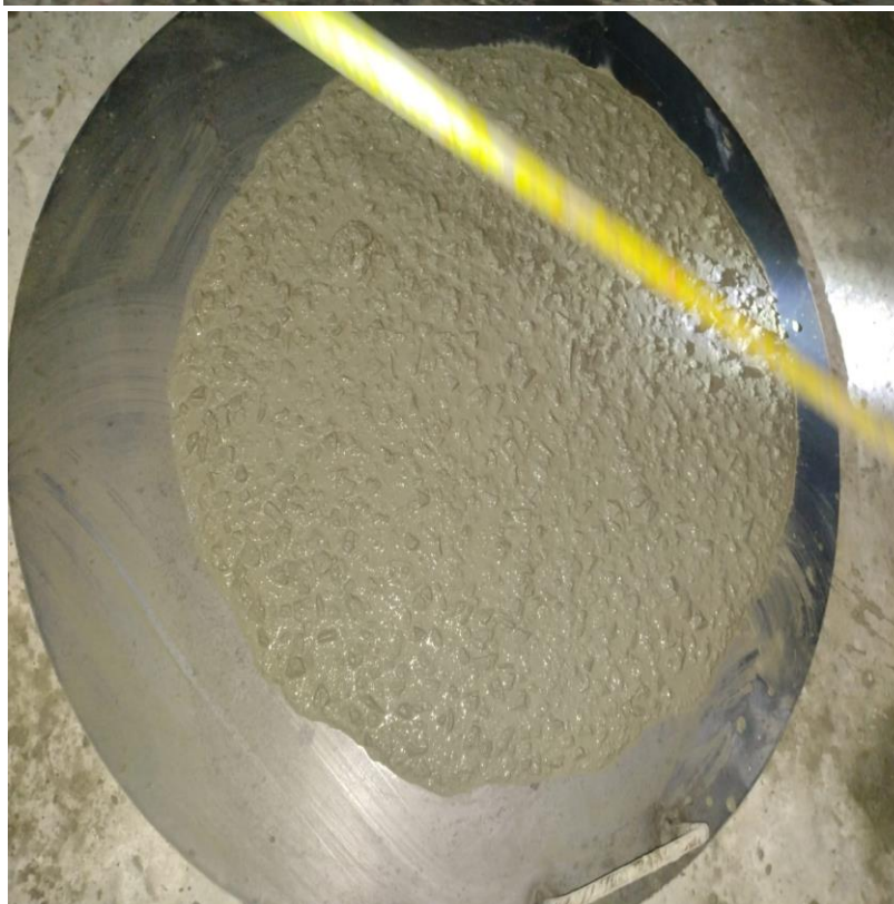
Imagen muestra el ensayo de flujo de asentamiento del concreto
