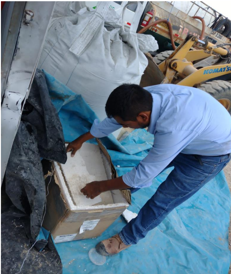
Imagen muestra el curado inicial de los especímenes o probetas de concreto
