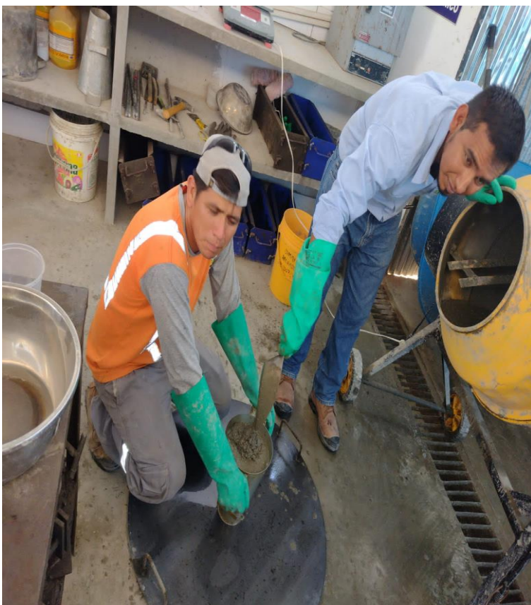
Imagen muestra el ensayo de flujo de asentamiento
