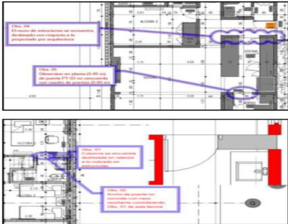
Figura 3. Detención de Interferencias en el Bim.
