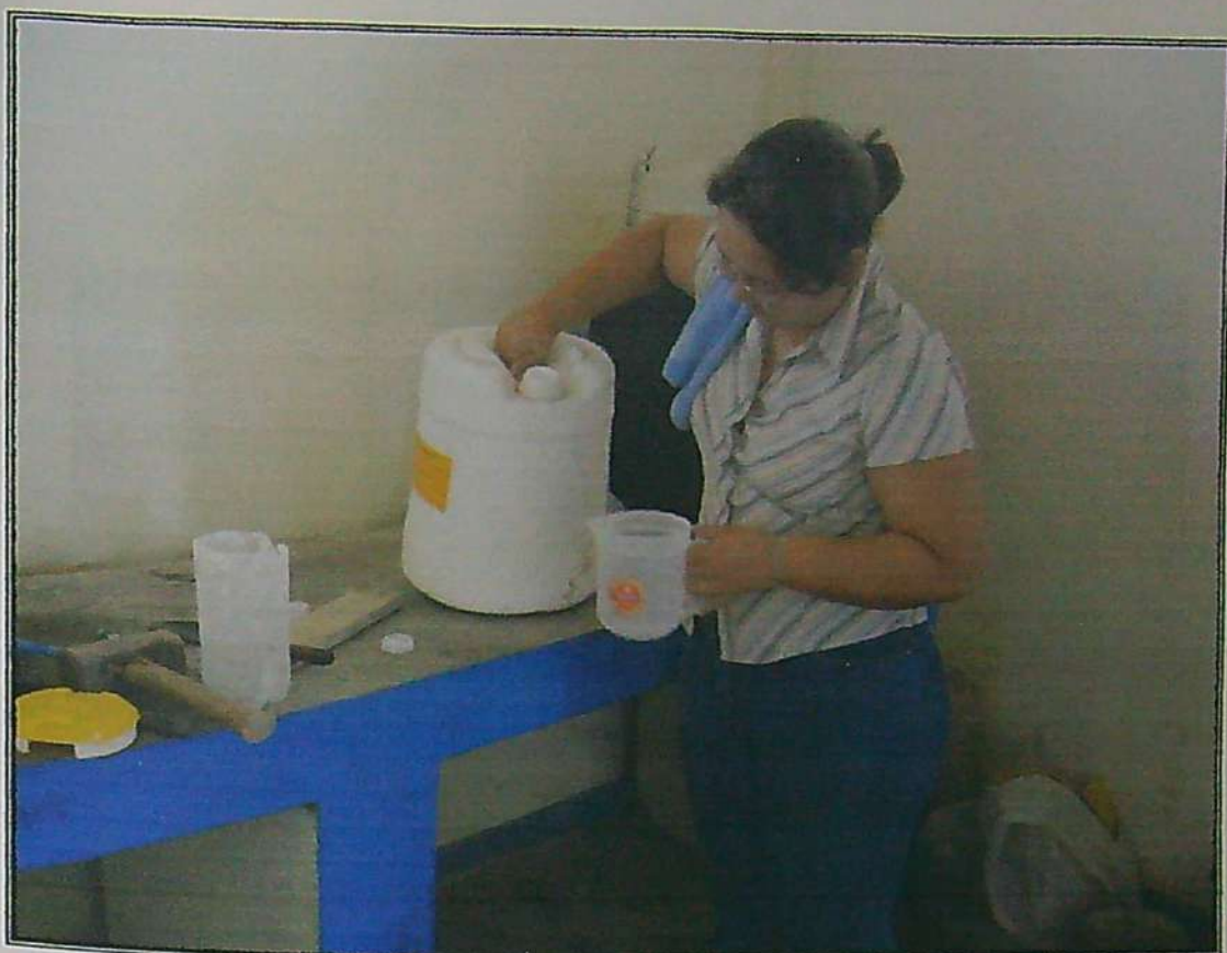
FOTO N° 16 Medición de la membrana plástica a aplicar.
