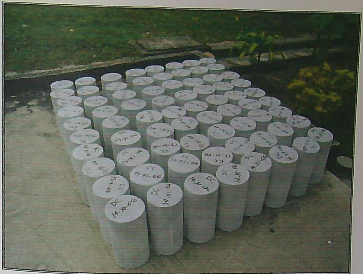
FOTO N° 19 Exposición de las probetas curadas con membrana plástica al medio ambiente.
