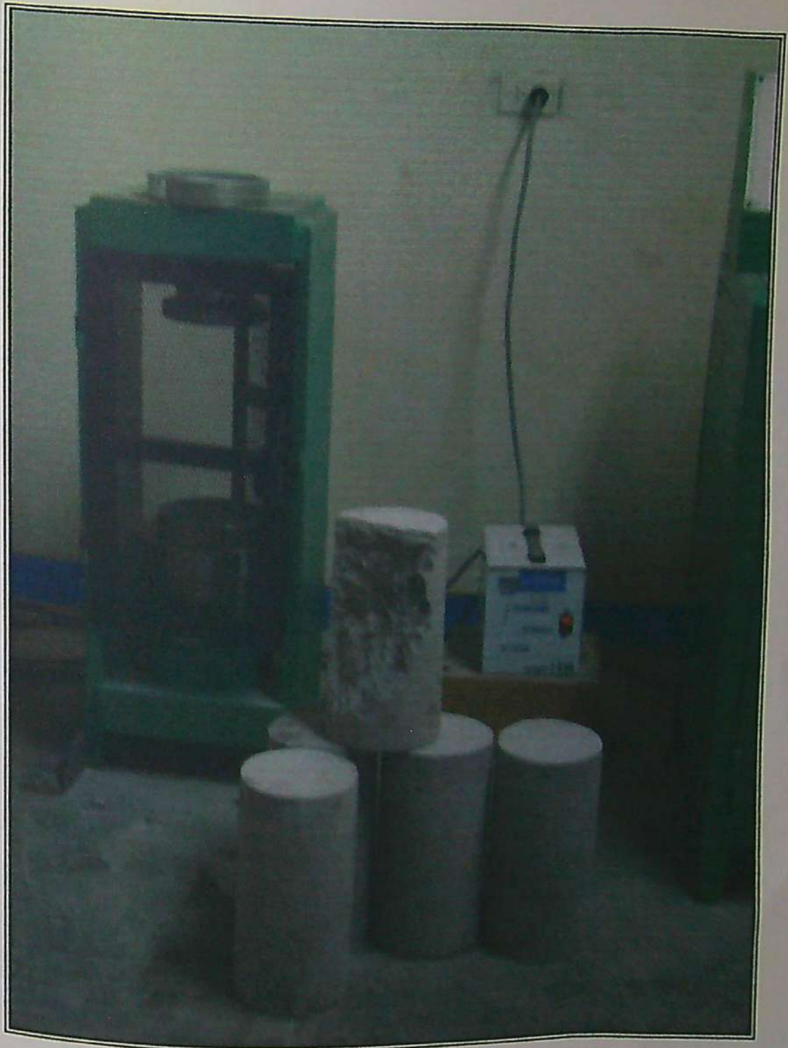
FOTO N° 23 Ensayo de Resistencia a la compresión, vista de probeta con falla por rotura..
