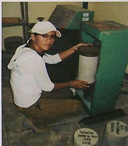
FOTOGRAFÍA N° 23: En la foto puede apreciarse de forma más notoria la forma de rotura que sufrieron las probetas con concreto cemento – arena reforzadas con fibras. Nótese que no hay fallas del tipo explosivas.
