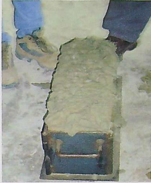
FOTOGRAFÍA N° 28: Llenado total del molde la viga a ensayar a flexión. La base b de la viga osciló entre 15.5 a 15.6 centímetros, la altura h de la viga osciló entre 15.4 a 15.8 centímetros; en tanto que la longitud de la viga fue en todos los casos igual a: L = 48.69 centímetros.
