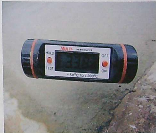
FOTOGRAFÍA N° 54: Medición de la temperatura del concreto en la parte superficial de las losas.
