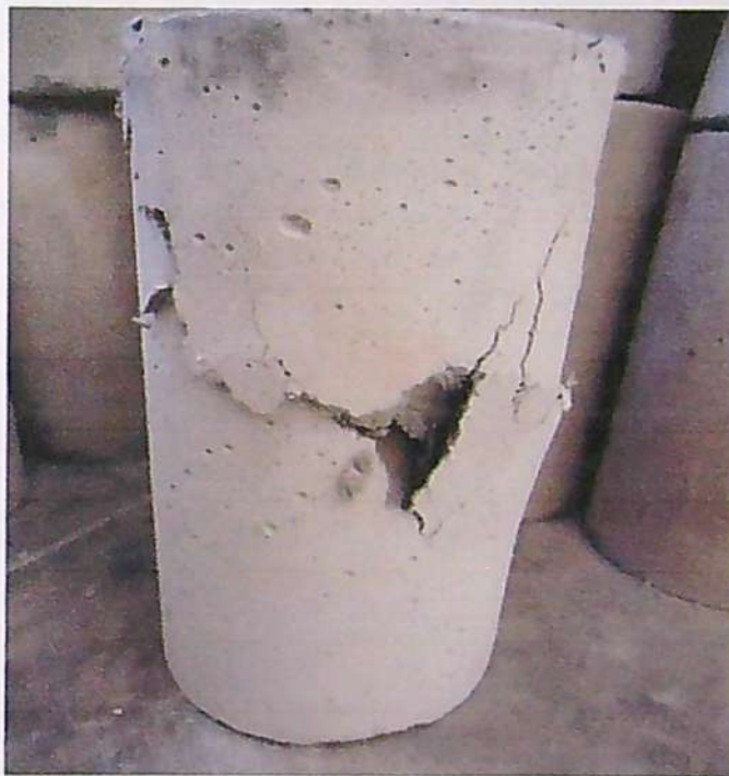
FOTOGRAFÍA N° 25: Nótese la falla del tipo dúctil en una probeta de concreto cemento-arena reforzada con fibras de acero y de polipropileno. Nótese la acción de las fibras de contener la falla y retardar la aparición de fisuras.
