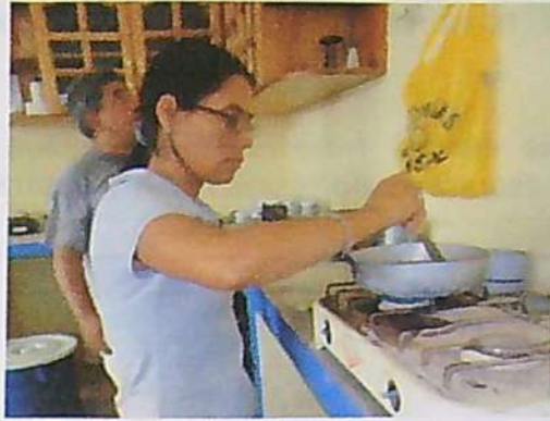
FOTOGRAFÍA N° 07: Secado de la arena en laboratorio para obtener su contenido de humedad.
