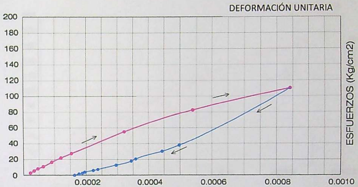
Gráfico N° 09 : Curva del módulo de elasticidad del concreto cemento-arena reforzado con fibras f'c = 175 \text{ kg/cm}^2 , a los 28 días.
