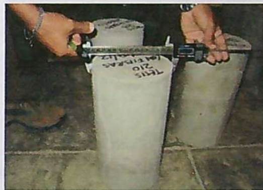
FOTOGRAFÍA N° 17: Medición del diámetro de las probetas para el cálculo del área sometida a presión.
