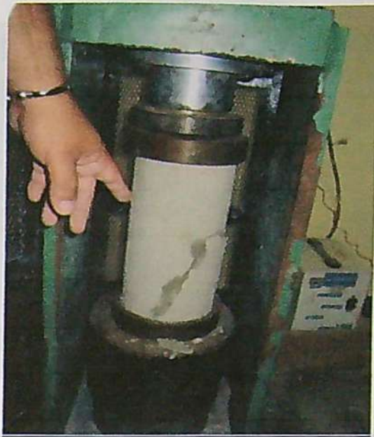
FOTOGRAFÍA N° 22: En la foto puede apreciarse que una probeta de concreto cemento – arena reforzada con fibras presenta agrietamiento al ser sometida a compresión, agrietamiento que sin embargo es controlado por las fibras de acero. La falla no es del tipo frágil, sino del tipo dúctil.
