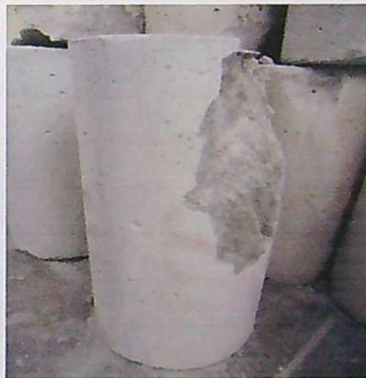
FOTOGRAFÍA N° 19: Falla típica de una probeta de concreto cemento – arena simple sin refuerzo de fibras. Se trata de una falla explosiva de tipo cortante con desprendimiento de la superficie de concreto.
