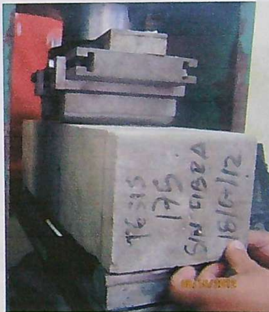
FOTOGRAFÍA N° 33: Viga sin refuerzo de fibras de calidad estructural f_c=175 Kg/cm 2 , colocándose en el equipo de ensayo.
