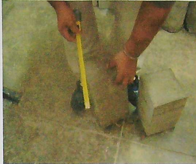
FOTOGRAFÍA N° 38: Toma de lectura de datos de la geometría que mostró la viga sin refuerzo de fibras. Se observa que el eje neutro sube hasta la zona en compresión de la viga provocando una falla violenta.
