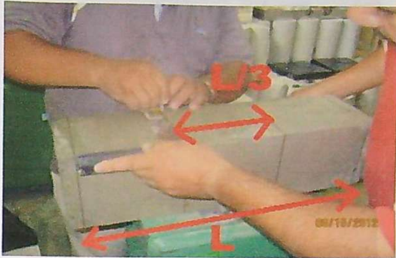
FOTOGRAFÍA N° 30: Señalización de los tercios de luz para ubicar las cargas P/2 .
