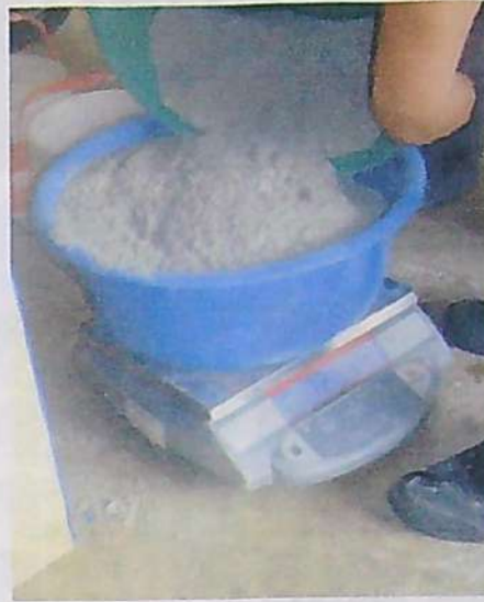
FOTOGRAFÍA N° 02: Pesado del cemento en balanza digital para la preparación de la mezcla en laboratorio.
