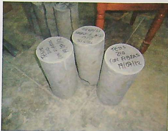
FOTOGRAFÍA N° 24: Vista de probetas reforzadas con fibras luego de ser sometidas al ensayo de compresión. Nótese que las probetas no muestran fallas violentas, sino más bien, su falla ha ido acompañada con el desarrollo de deformaciones, habiendo sido controladas las fisuras por las fibras de acero que fueron adicionadas.
