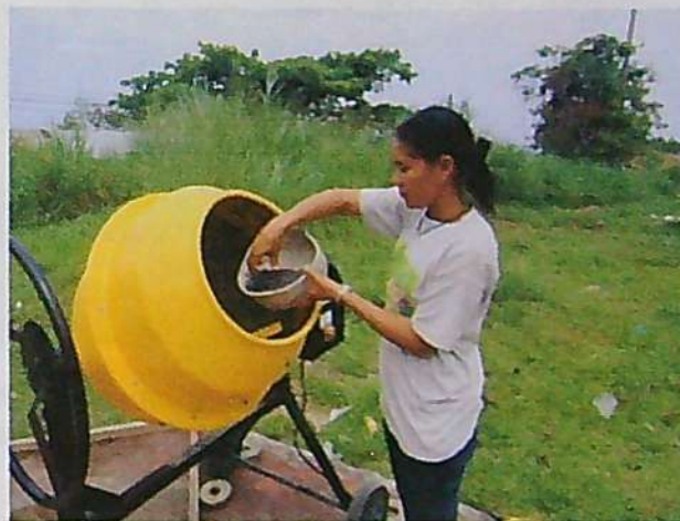
FOTOGRAFÍA N° 50: Preparación de la mezcla a usar en el ensayo de fisuración. En la vista se aprecia la incorporación de fibras de acero en el trompo eléctrico.
