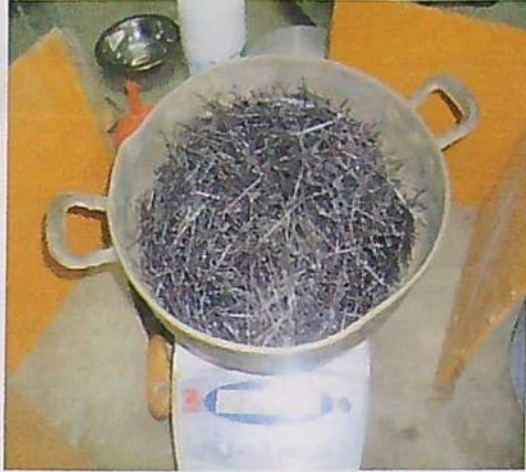
FOTOGRAFÍA N° 08: Pesado de las fibras de acero Wirand FF1 en balanza digital para la preparación de la mezcla según diseño.
