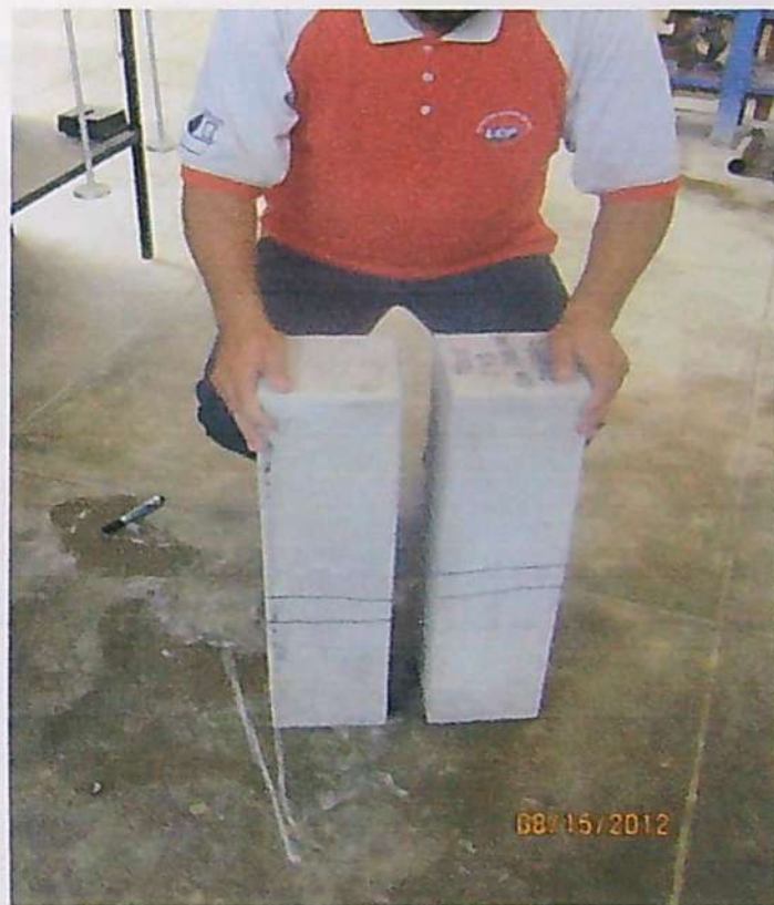
FOTOGRAFÍA N° 41: Vista de dos vigas reforzadas con fibras inmediatamente después de ocurrida la falla por flexión. Nótese las fisuras producidas en el tercio central.
