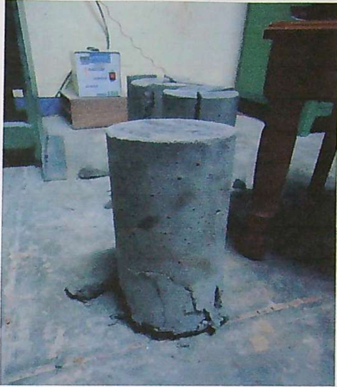
FOTOGRAFÍA N° 26: Otra falla del tipo dúctil en una probeta de concreto cemento-arena reforzada con fibras de acero y de polipropileno. Nótese el poco desprendimiento del concreto.
