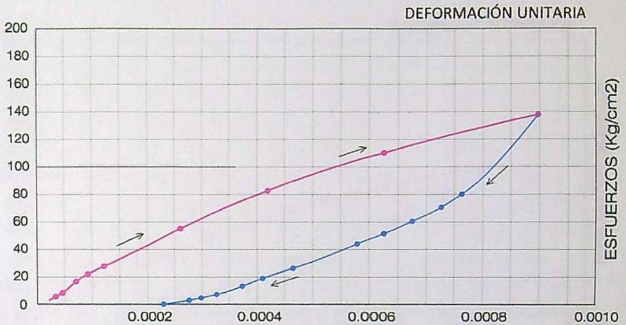
Gráfico N° 08 : Curva del módulo de elasticidad del concreto cemento-arena sin refuerzo de fibras f'c = 175 \text{ kg/cm}^2 , a los 28 días.
