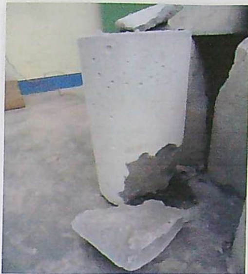
FOTOGRAFÍA N° 20: Vista de otra probeta de concreto cemento – arena simple sin refuerzo de fibras que ha fallado por rotura en su base.
