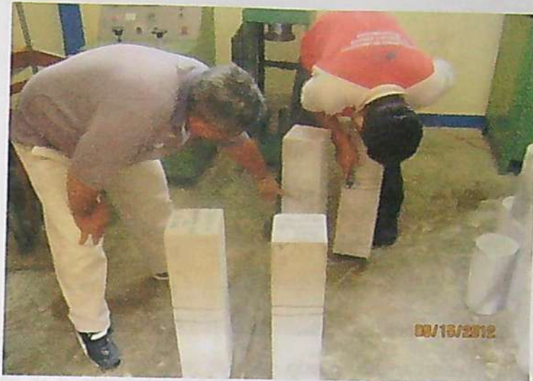
FOTOGRAFÍA N° 42: Señalización de las fallas por flexión en diversas vigas reforzadas con fibras. Todas las fisuras ocurrieron en el tercio central. Nótese que las vigas no se han partido en dos, a diferencia de la falla en vigas sin refuerzo de fibras.
