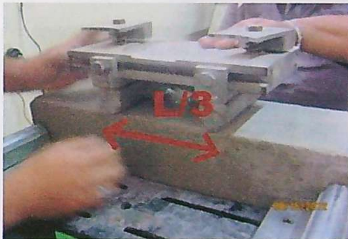
FOTOGRAFÍA N° 31: Equipo a usar en el ensayo a flexión. Colocación de los cabezales encima de la viga a ensayar justamente encima de los tercios de luz.
