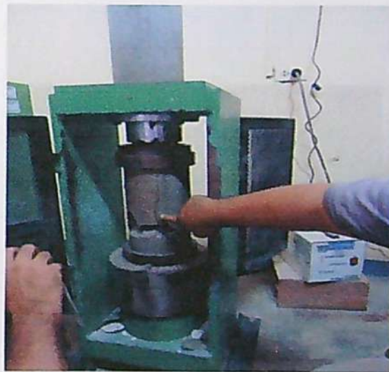
FOTOGRAFÍA N° 21: En la foto puede apreciarse que la probeta con concreto cemento – arena simple sin refuerzo de fibras presenta una falla por aplastamiento en compresión al ser sometida a presión uniaxial.
