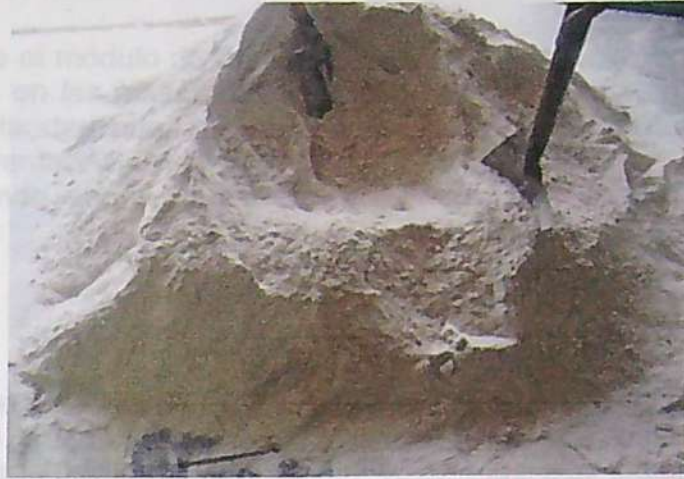
FOTOGRAFÍA N° 05: Arena blanca usada en el presente trabajo de investigación, proveniente de la cantera Chuquival, que presenta las siguientes características: Clasificación en AASHTO A-3(0), SUCS SP-SM y Módulo de Fineza de 1.50.
