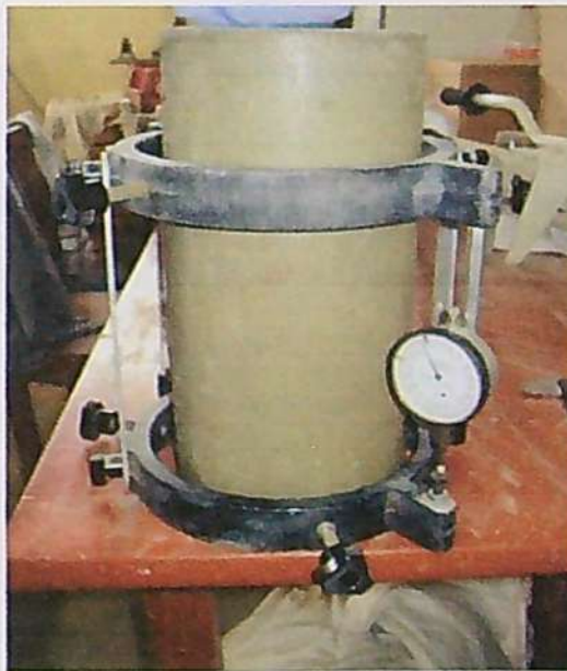
FOTOGRAFÍA N° 48: Colocación de dos anillos y un micrómetro para la realización del ensayo de módulo de elasticidad.
