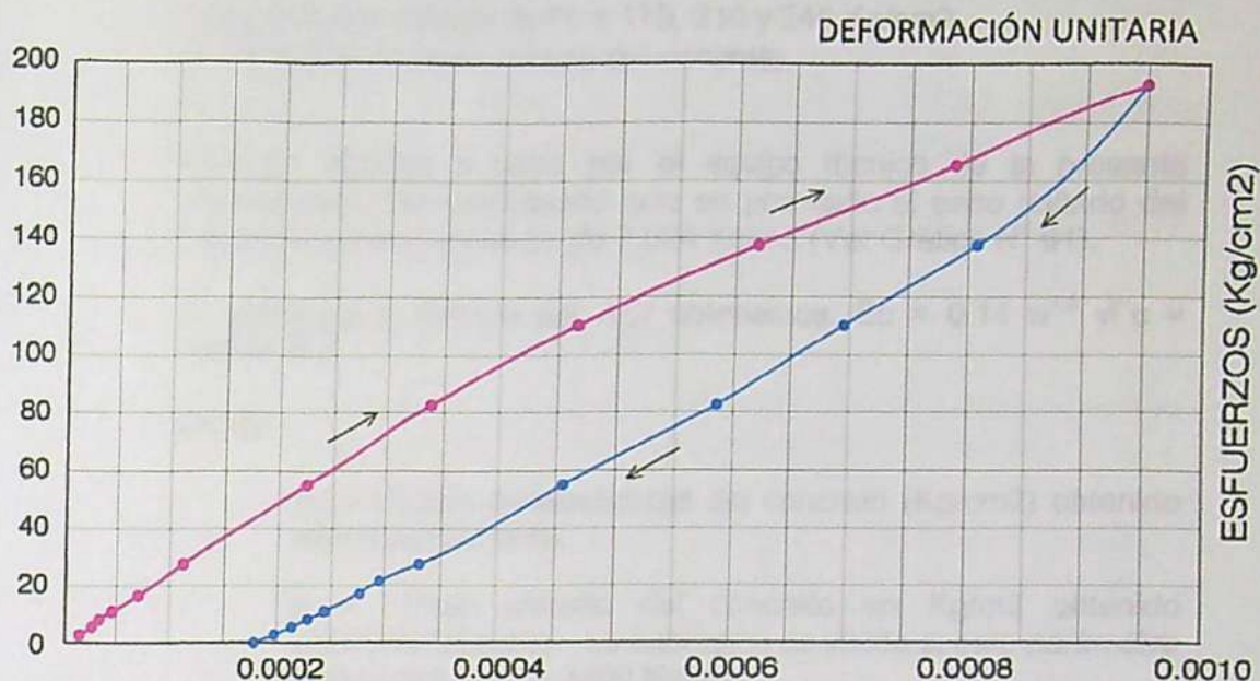
Gráfico N° 13 : Curva del módulo de elasticidad del concreto cemento-arena reforzado con fibras f'c = 245 \text{ kg/cm}^2 , a los 28 días.
