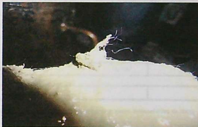
FOTOGRAFÍA N° 11: Vista del concreto con la fibra de polipropileno ya incorporada en su cuerpo. Nótese los delgados de filamentos que controlarán el fisuramiento del concreto en su estado de hidratación y endurecido.
