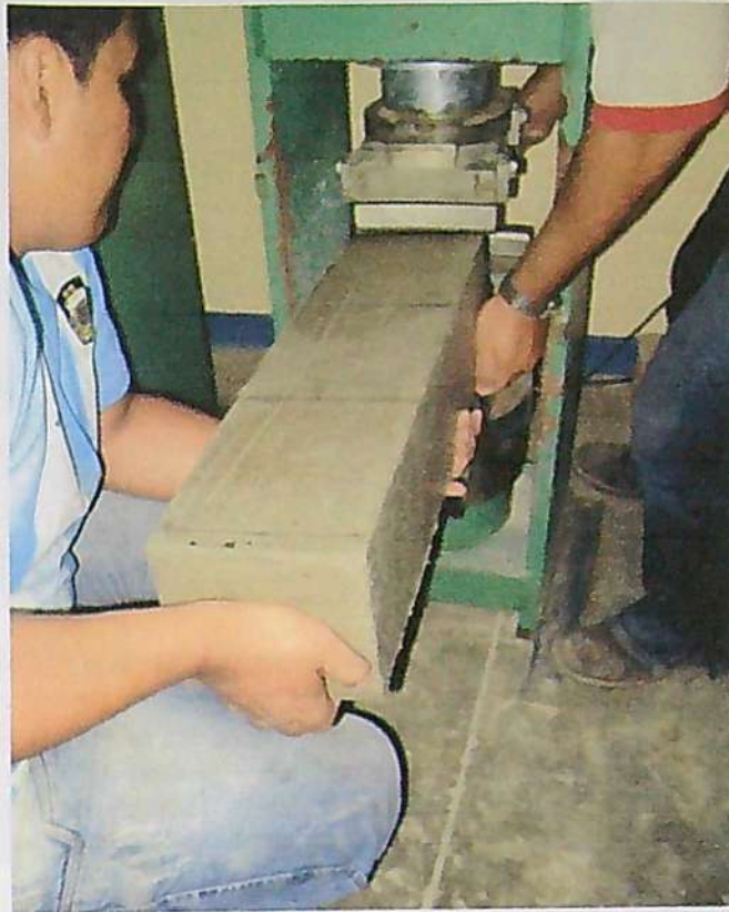
FOTOGRAFÍA N° 32: Colocación de la viga a ensayar en el equipo de carga.
