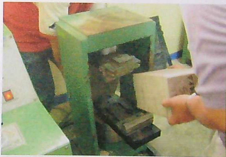
FOTOGRAFÍA N° 37: Retiro de la viga fallada del equipo de ensayo. La viga sin refuerzo de fibras fue partida en dos. Se alcanzó una carga P de 2.956 Kg y se obtuvo un MR de 39 Kg/cm 2 .
