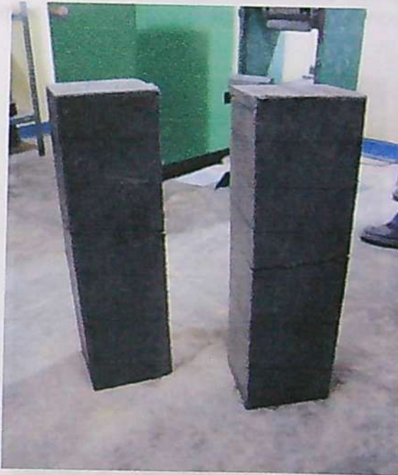
FOTOGRAFÍA N° 47: Vigas reforzadas con fibras al final del ensayo a flexión. Nótese que las vigas han tenido una falla dúctil, la cual es deseable desde el punto de vista de la integridad estructural del elemento.
