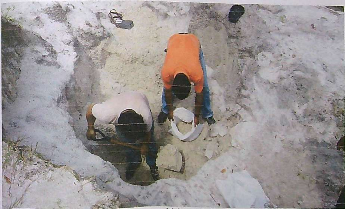
Foto 10: Extrayendo material de cantera del Centro Poblado Menor Astoria para ser transportado a Iquitos para el análisis de laboratorio en el Laboratorio de Mecánica de Suelos y Ensayo de Materiales de la UCP.
