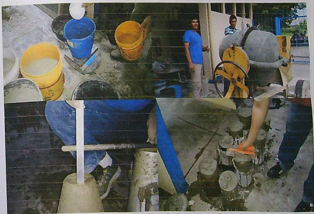
Foto 36: Elaboración del concreto, elaboración de testigos y determinación de Slump.
