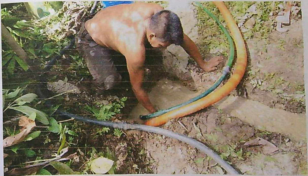
Foto 30: Verificación de los estratos y espesores del suelo, estrato 2, arena blanca.
