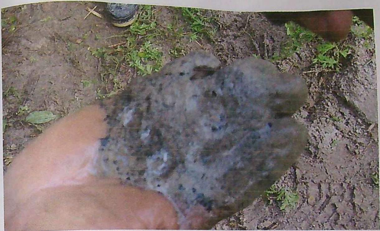
Foto 33: Verificación del último estrato en el cual la broca sufrió daños al momento de la perforación, por lo tanto se finalizó la perforación por la solidez de dicho estrato.
