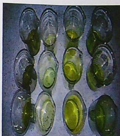
Contenido lipídico (fase clorofórmica) a 4, 6 y 8 minutos de exposición al CO 2 . En vasos precipitados con peso conocido.
