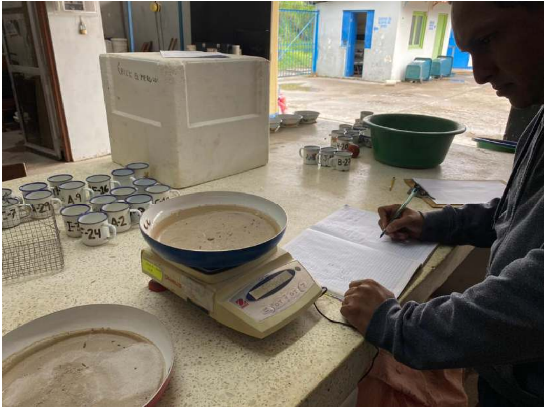
IMAGEN N° 5 Ensayos de los agregados ( pesado del agregado seco).
