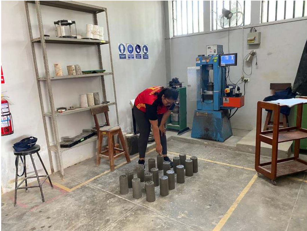
IMAGEN N° 7 Rotura de las probetas en el laboratorio de suelos de la UCP.
