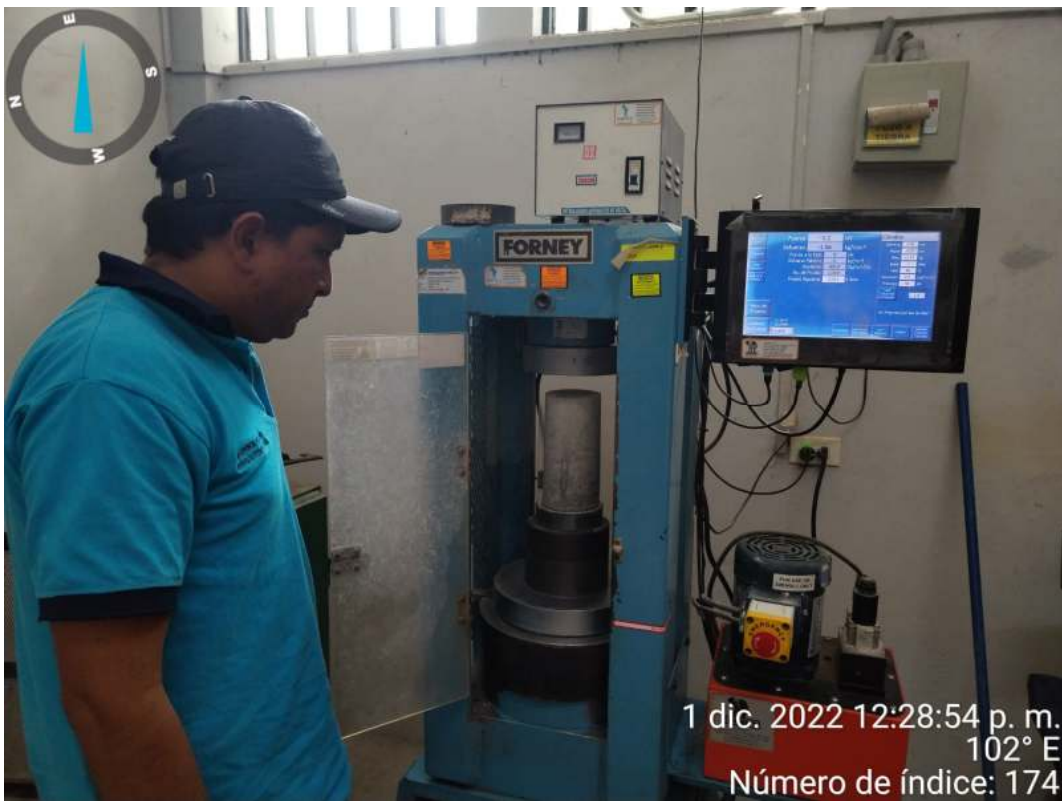
IMAGEN N° 10 Rotura de probetas en laboratorio de suelos de la UCP.
