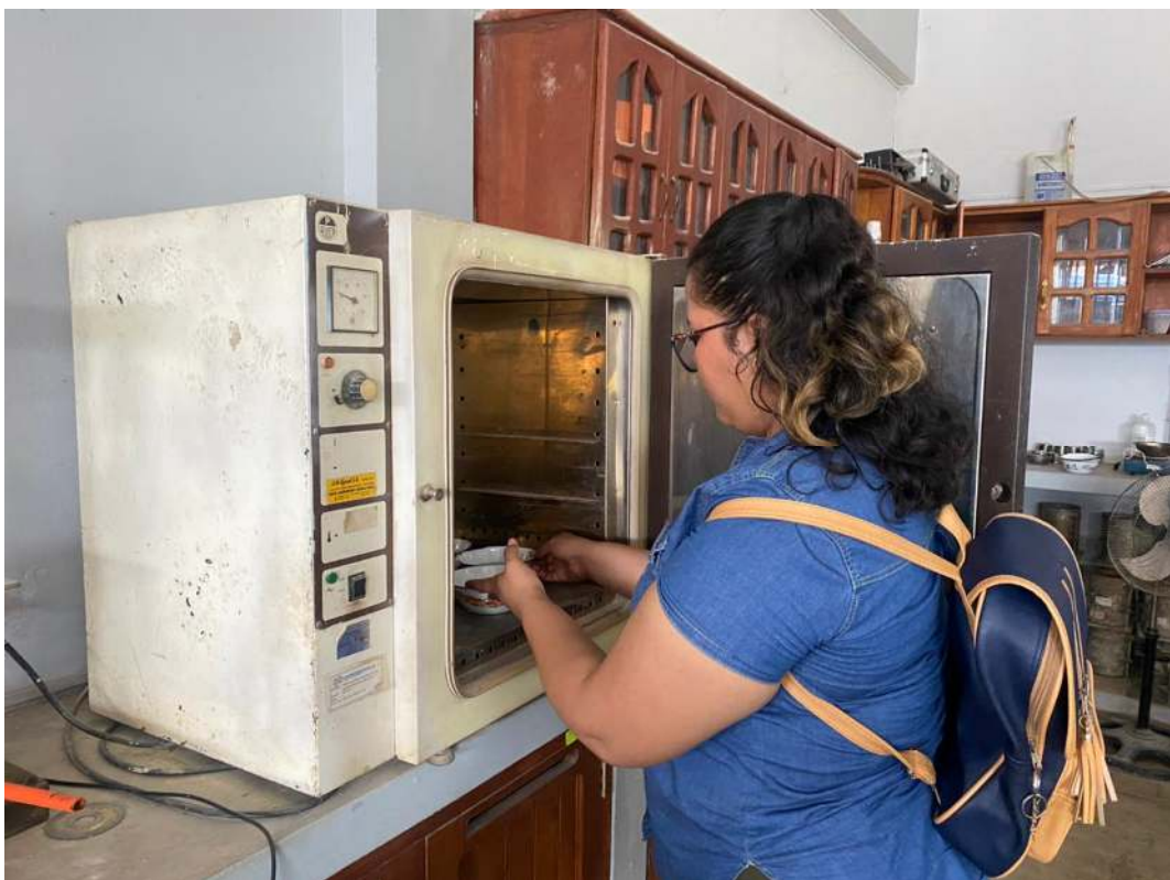
IMAGEN N° 6 Ensayo de los agregados ( secado del agregado)
