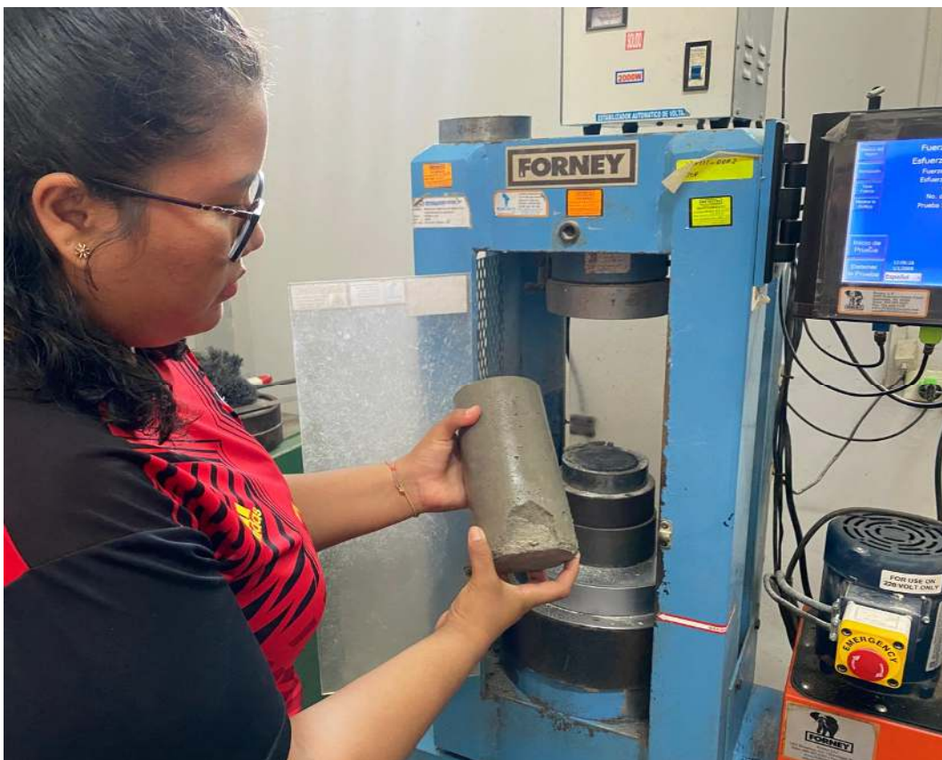
IMAGEN N° 8 Prueba de resistencia a la compresión en el laboratorio de suelos de la UCP.
