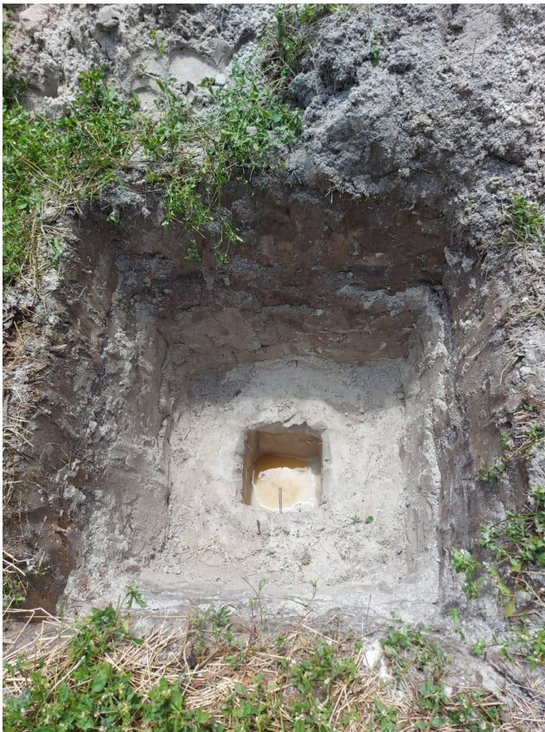
FOTO N°44: C-2 TEST DE PERCOLACIÓN
