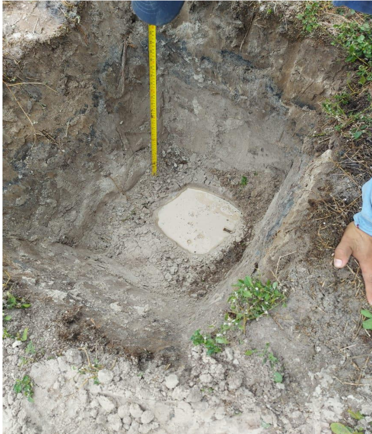
FOTO N°42: C-3 TEST DE PERCOLACIÓN
