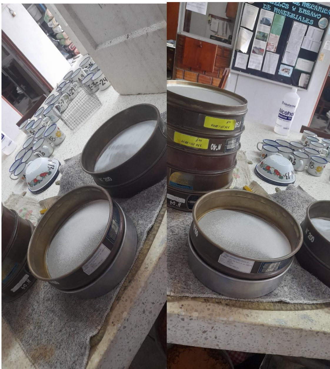
FOTO N°56: TAMIZADO DE LAS MUESTRAS SECAS EN LABORATORIO
