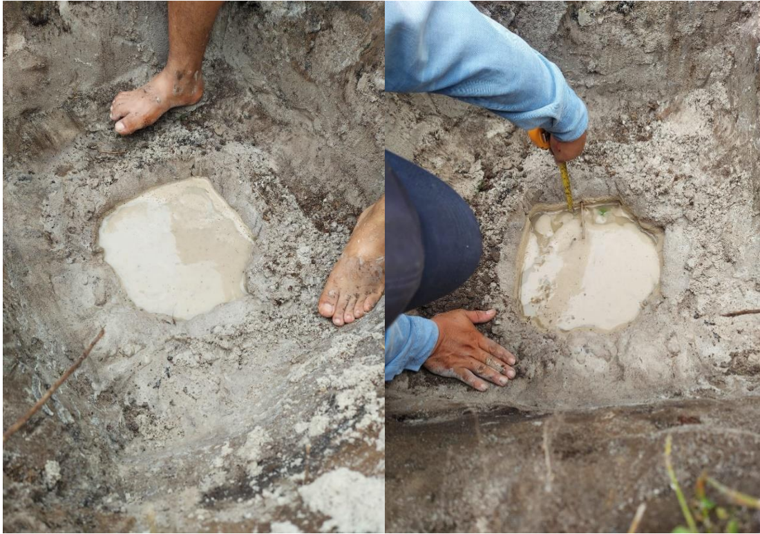
FOTO N°38: C-1 TEST DE PERCOLACIÓN
