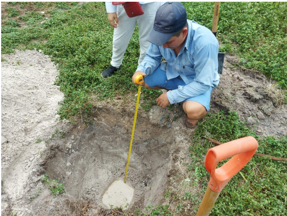
FOTO N°43: C-3 TEST DE PERCOLACIÓN
