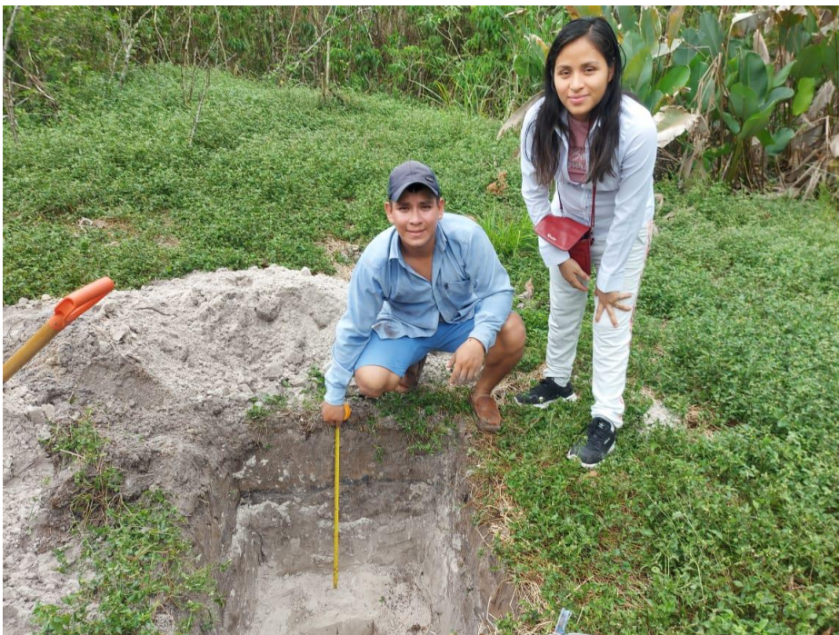
FOTO N°41: C-2 TEST DE PERCOLACIÓN
