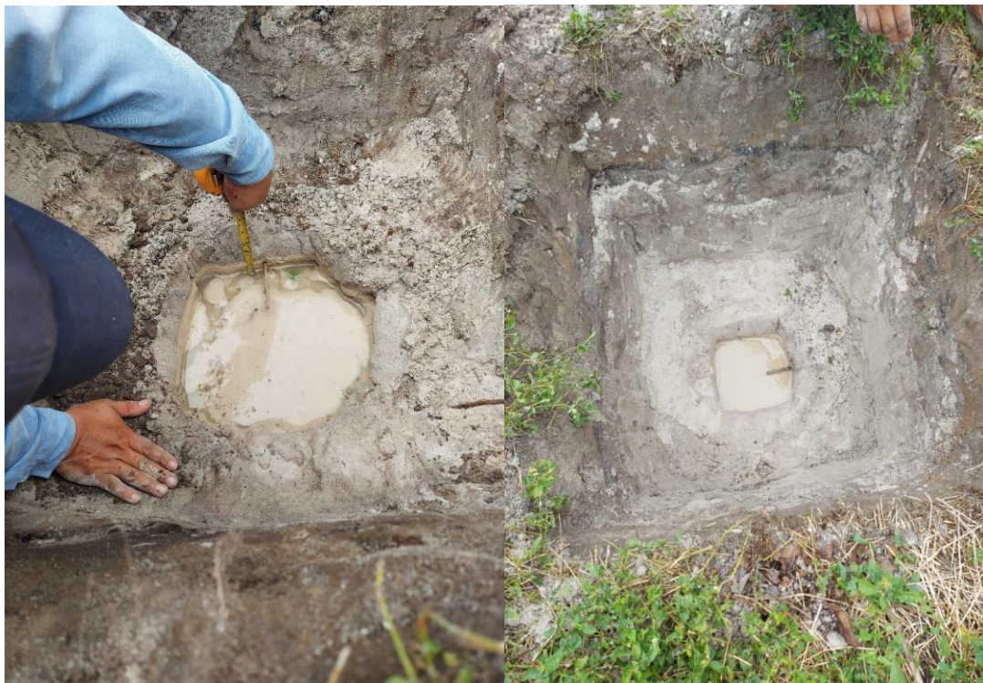
FOTO N°39: C-2 TEST DE PERCOLACIÓN
