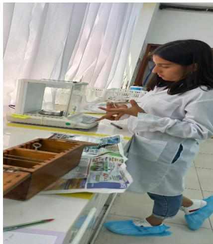
Figura 31. Pesaje de puras placas en la balanza analítica en el laboratorio de la UCP.
