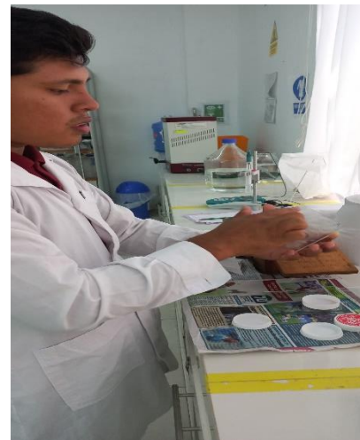
Figura 32. Colocación de vaselina en las placas.
