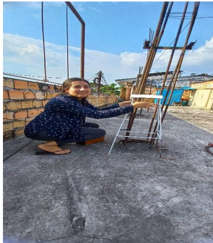
Figura 29. Colocación de placas de captación de PAS en la Av. Quiñones (AV 1-3).
