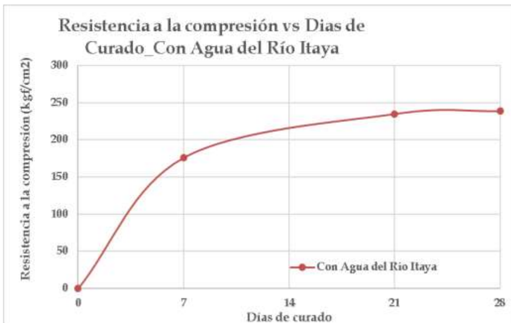
GRAFICO N° 9 CURVA DE RESISTENCIA OBTENIDA DE LOS CILINDROS DE CONCRETO 175 KG/CM2 UTILIZANDO AGUA DEL RIO ITAYA.
