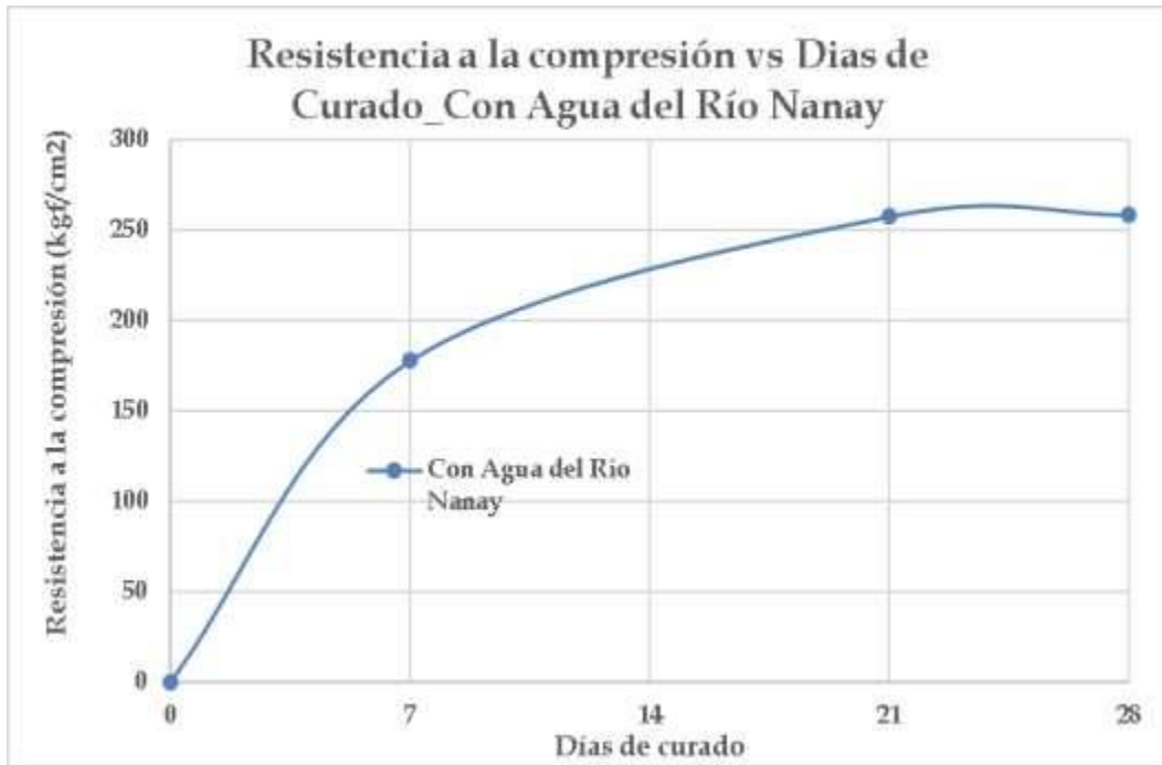
GRAFICO N° 8 CURVA DE RESISTENCIA OBTENIDA DE LOS CILINDROS DE CONCRETO 175 KG/CM2 UTILIZANDO AGUA DEL RIO NANAY.
