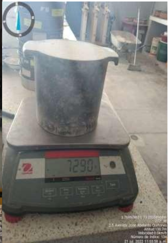
IMAGEN N° 8 PESO Y CLASIFICACIÓN DE LOS AGREGADOS
