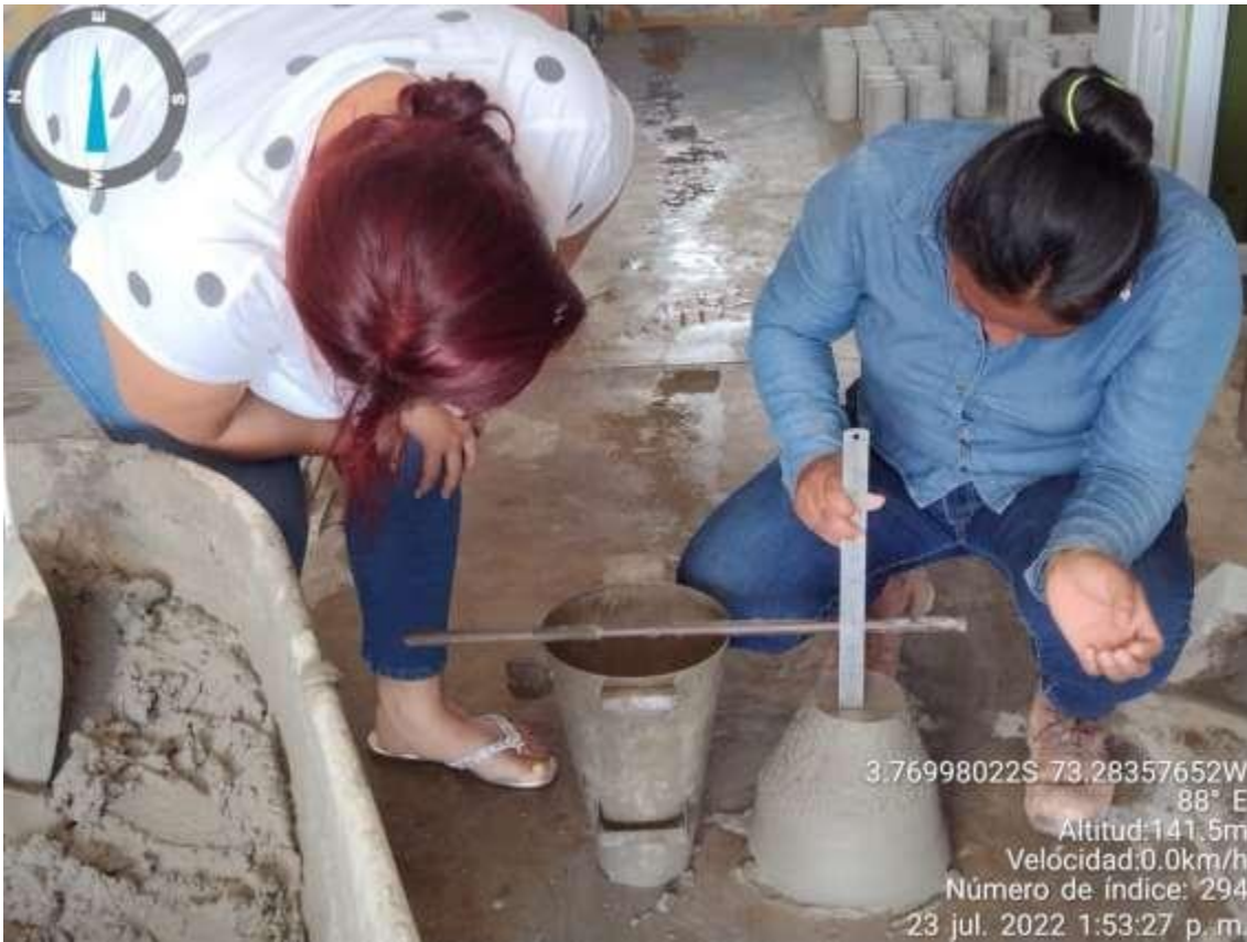
IMAGEN N° 11 REALIZACIÓN DEL SLUMP.
