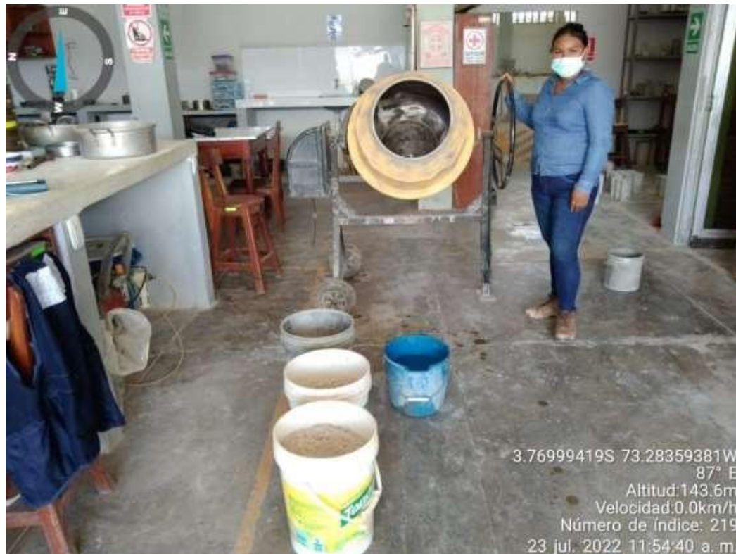
IMAGEN N° 10 REALIZACIÓN DE LA MESCLA PARA LA ELABORACIÓN DE LASPROBETAS
