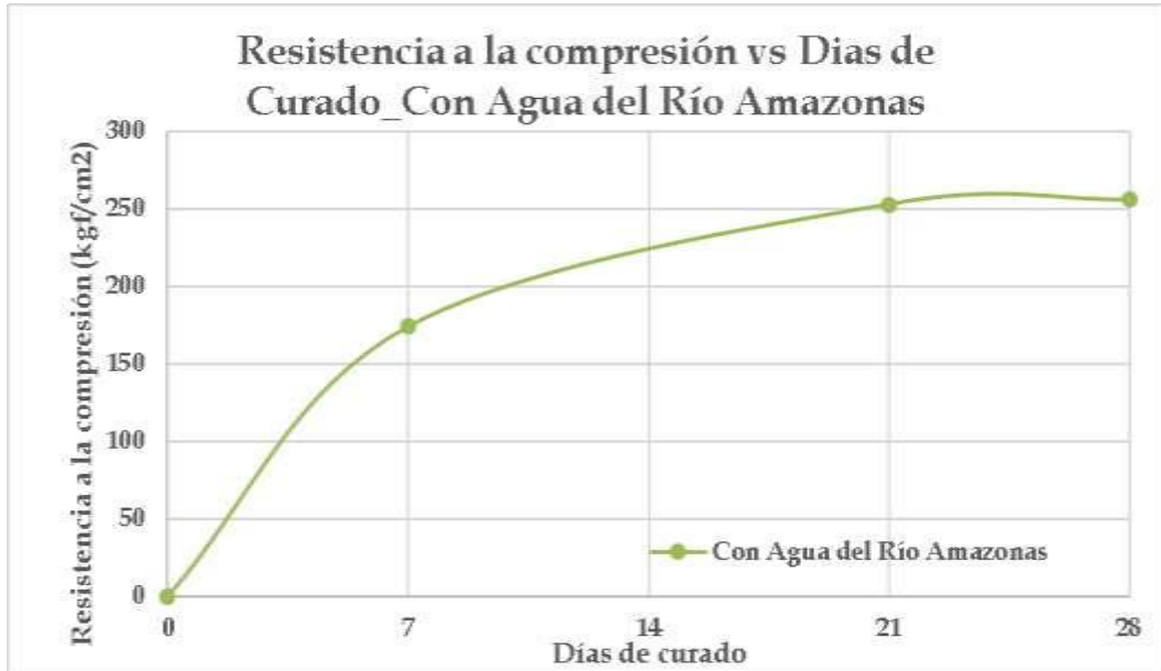
GRAFICO N° 10 CURVA DE RESISTENCIA OBTENIDA DE LOS CILINDROS DE CONCRETO 175 KG/CM 2 UTILIZANDO AGUA DEL RIO AMAZONAS.
