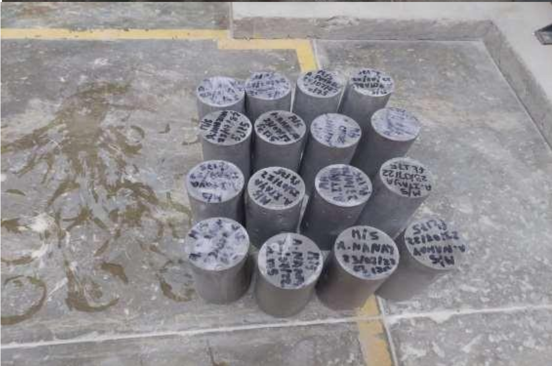
IMAGEN N° 14 PROBETAS LISTAS PARA LA PRUEBA DE RESISTENCIA ACOMPRESIÓN.
