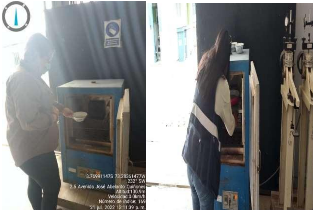
IMAGEN N° 9 SECADO DEL AGREGADO FINO.
