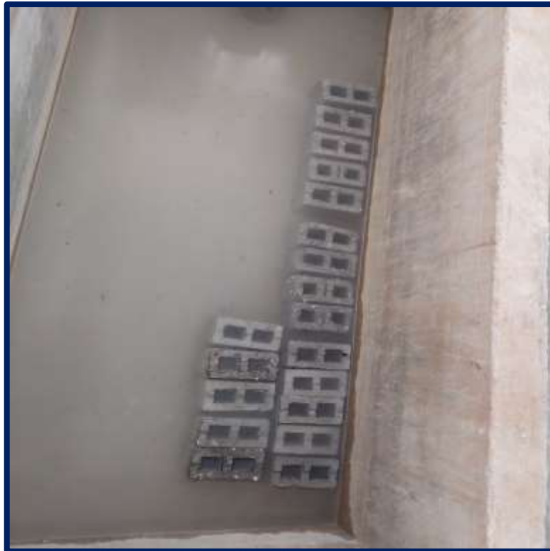
Foto 18: CURADO DE LAS BLOQUETAS DE CONCRETO EN UN RECIPIENTE CON AGUA POR UN PERIODO DE 28 DIAS.
