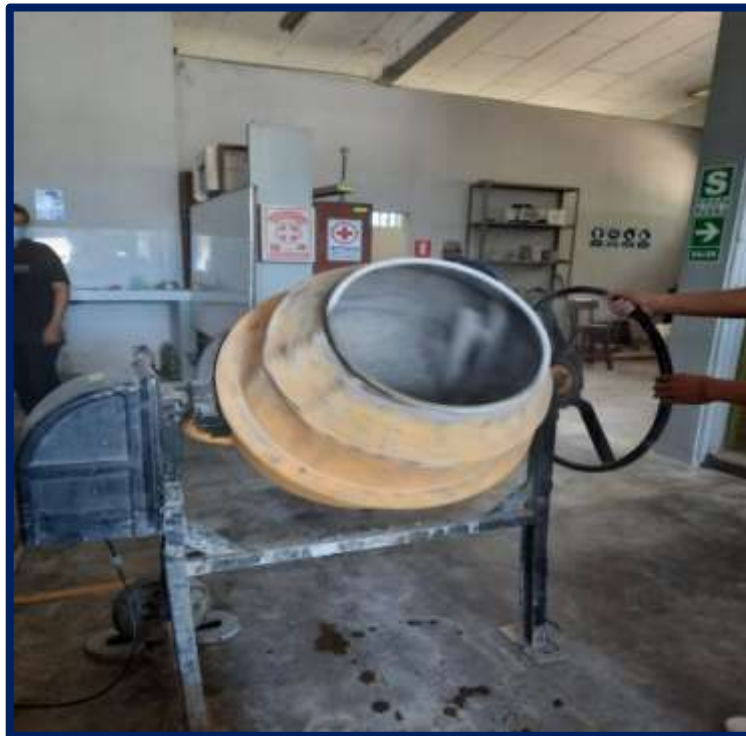
Foto 4: MEZCLADO DE LOS MATERIALES, UTILIZAMOS EL TROMPO.
