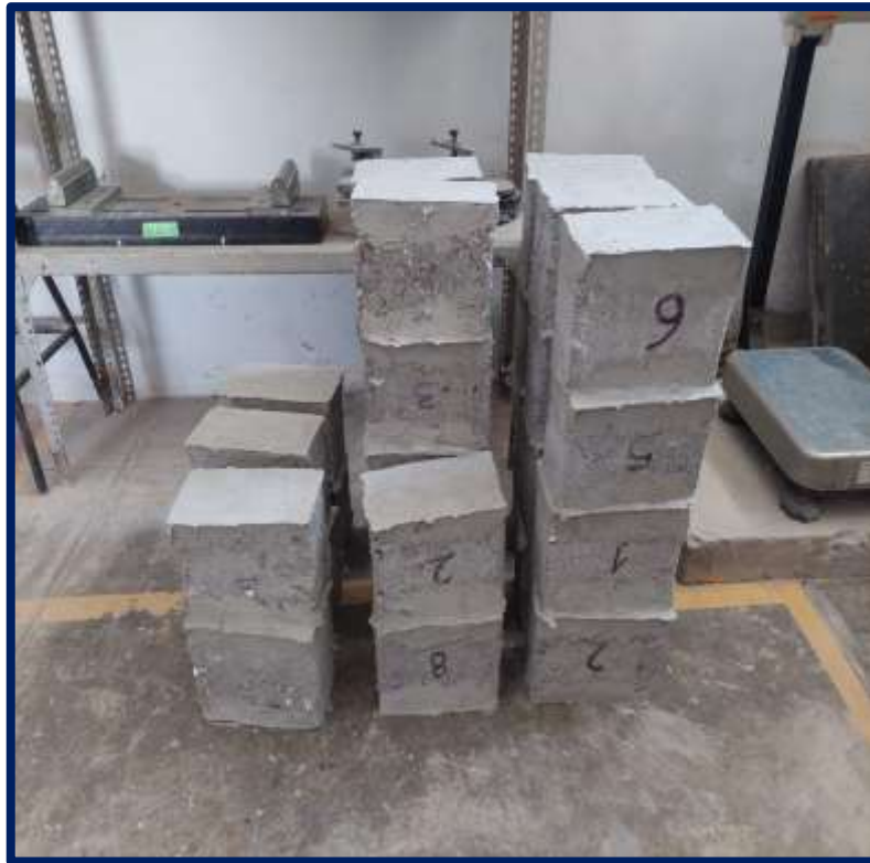
Foto 22: ENSAYOS DE RUPTURAS PARA VER LAS RESISTENCIAS DE LAS BLOQUETAS DE CONCRETO
