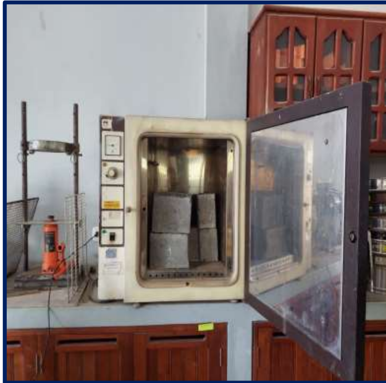
Foto 20: SECADO EN EL HORNO DE LAS BLOQUETAS DE CONCRETO.
