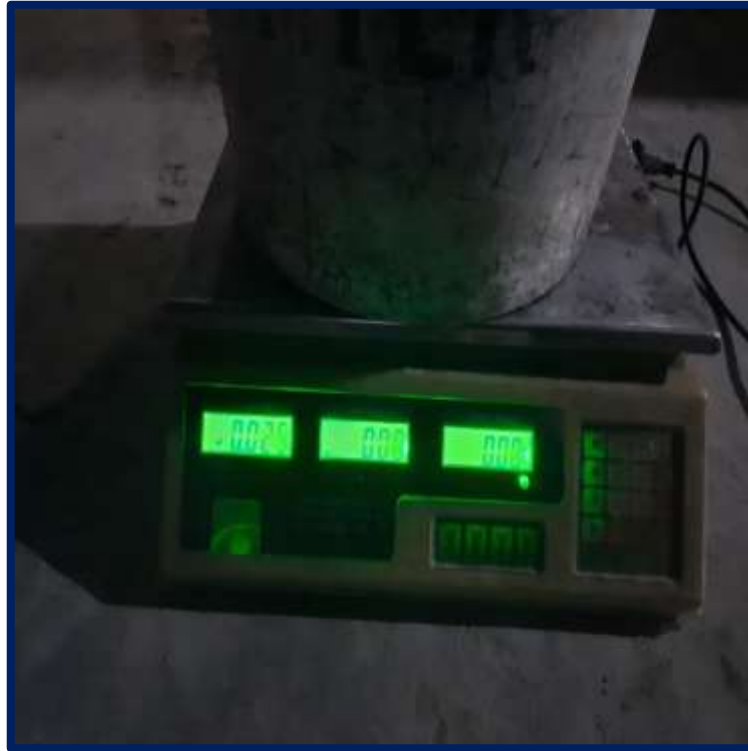
Foto 7: PESADO DE LOS MATERIALES: CEMENTO, ARENA, AGUA Y PET.
