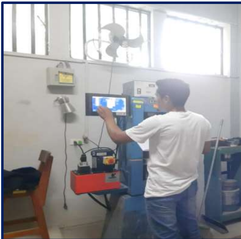
Foto 21: ENSAYOS DE RUPTURAS PARA VER LAS RESISTENCIAS DE LAS BLOQUETAS DE CONCRETO.
