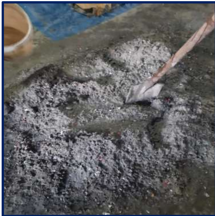
Foto 11: INICIO DEL MESCLADO DE LOS MATERIALES: CEMENTO, ARENA, AGUA Y PET DE FORMA MANUAL.
