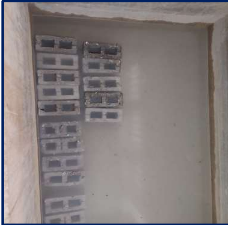
Foto 17: CURADO DE LAS BLOQUETAS DE CONCRETO EN UN RECIPIENTE CON AGUA POR UN PERIODO DE 28 DIAS.
