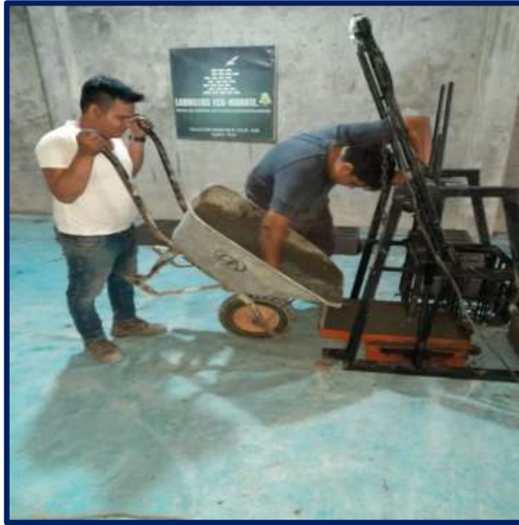
Foto 13: LLEVADO DE LA MESCLA SEMISECA A LOS MOLDES.
