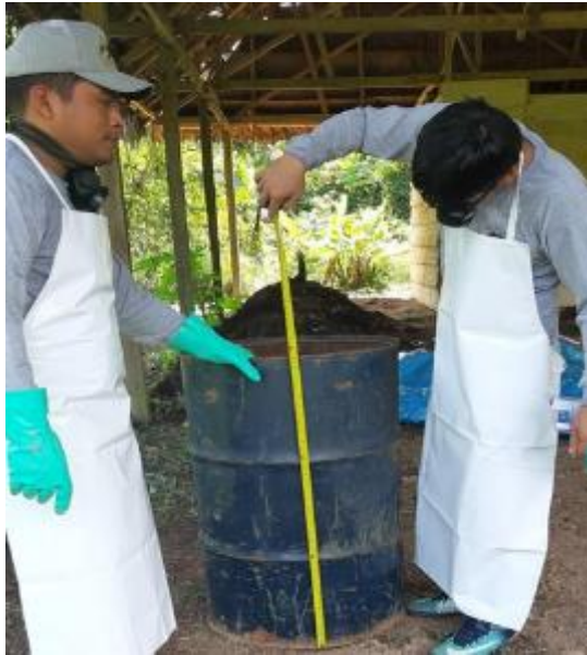
Foto 07. Proceso de determinación de la densidad de residuos sólidos.
