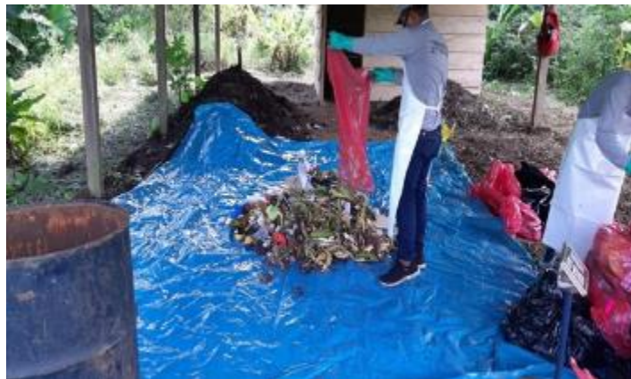
Foto 08. Aplicación del método del cuarteo a las muestras de residuos sólidos municipales
