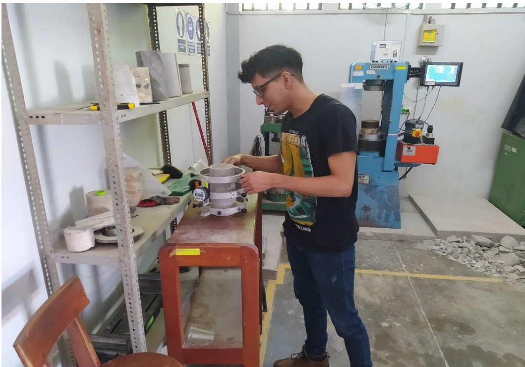
FOTO N° 48: ajustando el equipo en la probeta para el ensayo de módulo de elasticidad.
