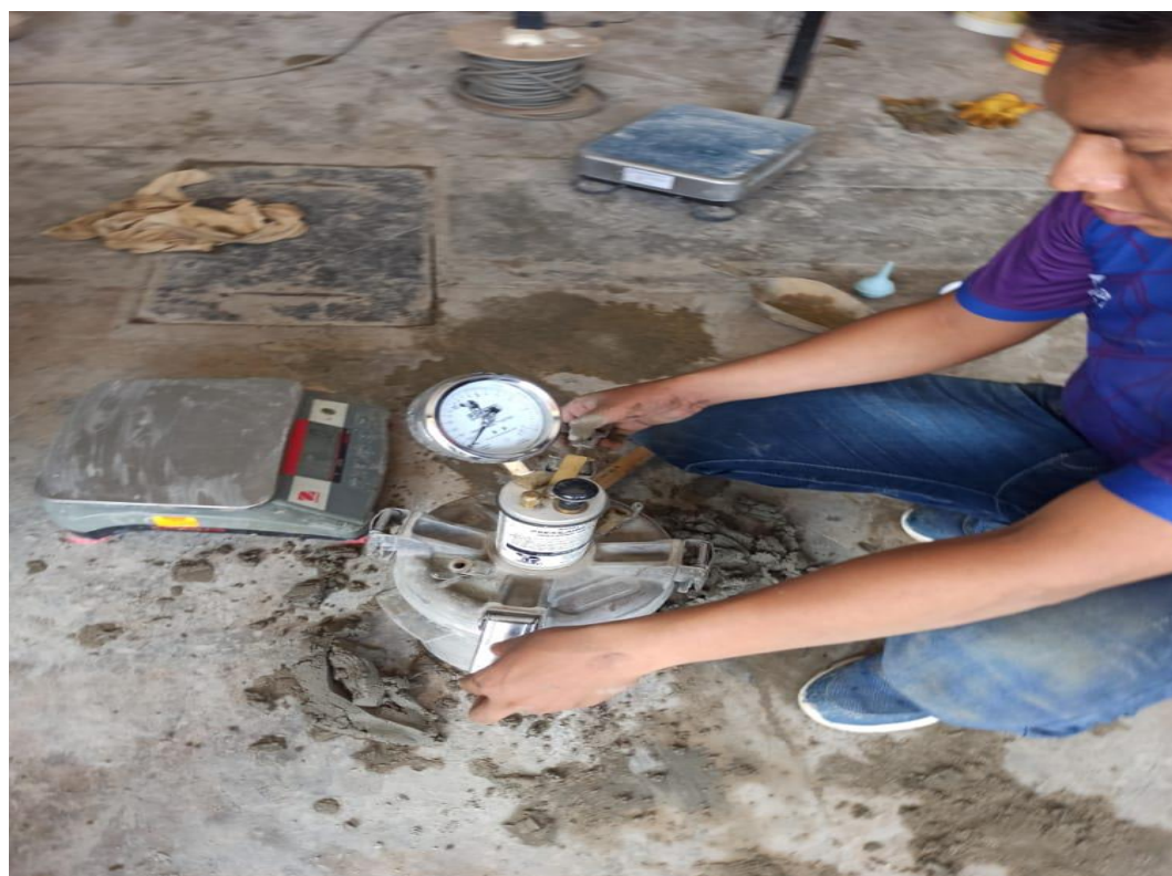
FOTO N° 30: Ensayo de contenido de aire en la mezcla de concreto cemento – arena por el método de presión y realizando las anotaciones debidas.
