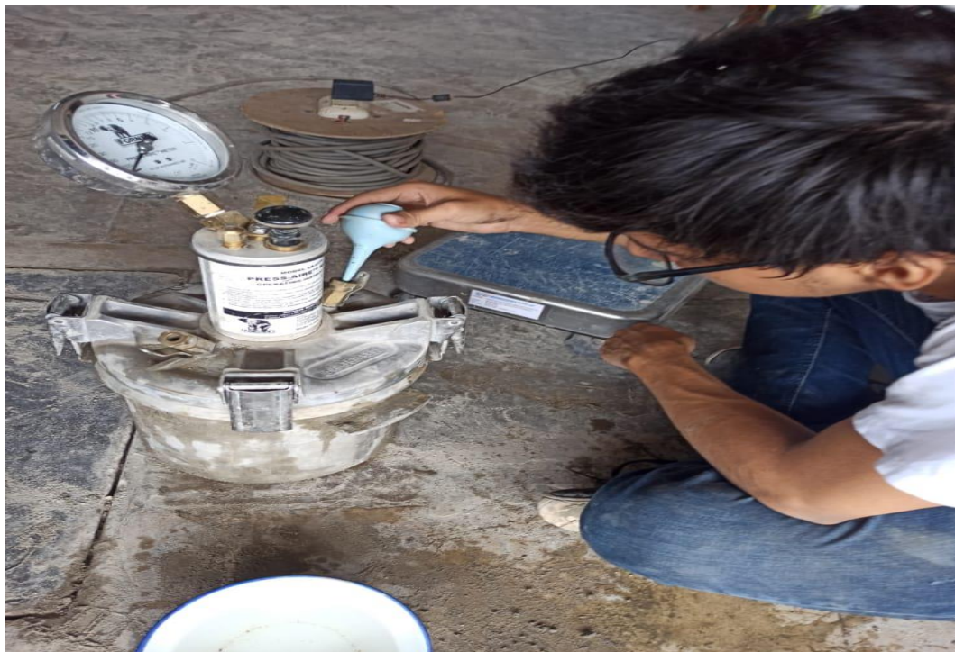
FOTO N° 30: Ensayo de contenido de aire en la mezcla de concreto cemento – arena por el método de presión y realizando las anotaciones debidas.
