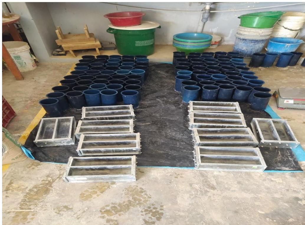
FOTO N° 22: Preparación de los moldes cilíndricos y prismáticos con su engrasado (petróleo, para su fácil desmolde).
