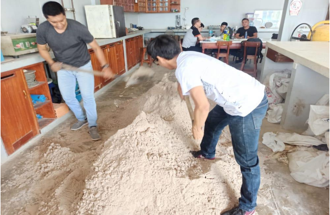
FOTO N° 05: Toma de muestra y homogenización del agregado fino para los respectivos ensayos.
