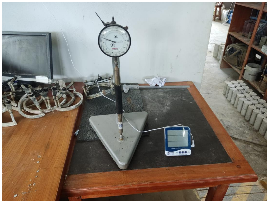
FOTO N° 38: Equipo para la contracción del concreto cemento-arena. (Barra Invar y medidor de humedad)
