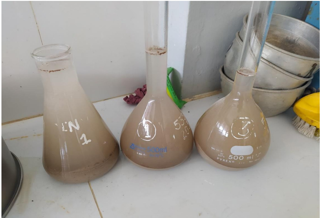
FOTO N° 12: Vaciado de muestras saturadas para el ensayo de absorción del agregado fino.
