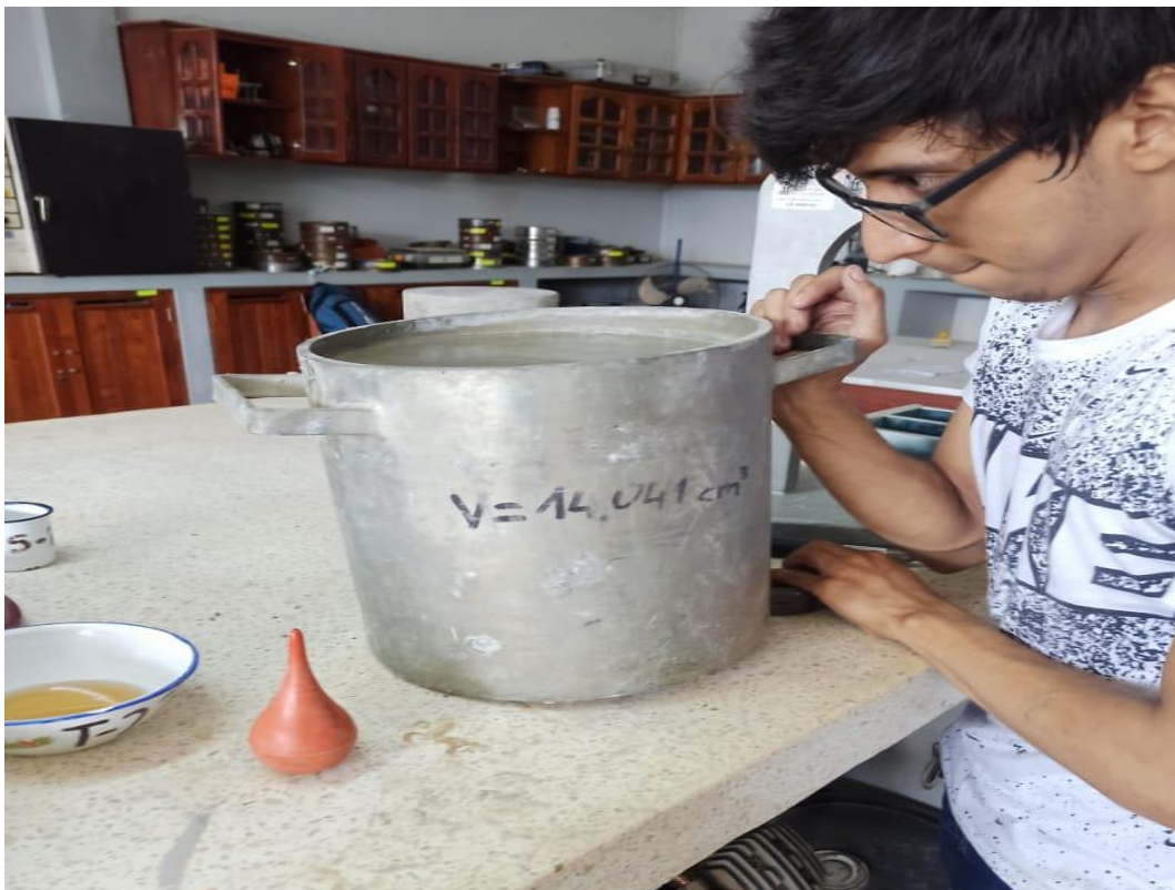
FOTO N° 32: Ensayo de Exudación del concreto y realizando las anotaciones debidas.
