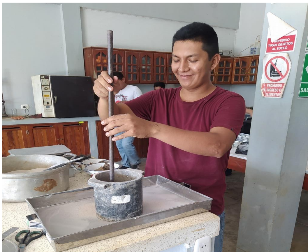
FOTO N° 20: Ensayo de peso unitario compactado.
