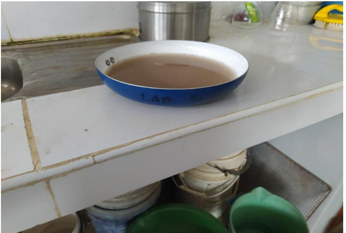
FOTO N° 12: Vaciado de muestras saturadas para el ensayo de absorción del agregado fino.
