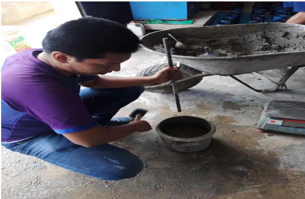
FOTO N° 26: Ensayo de peso unitario de la mezcla de concreto cemento – arena.
