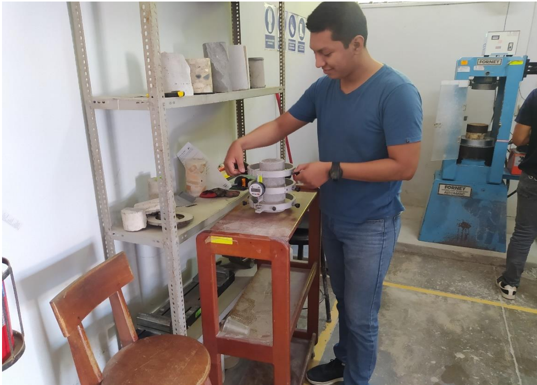
FOTO N° 50: Ensayo de módulo de elasticidad.
