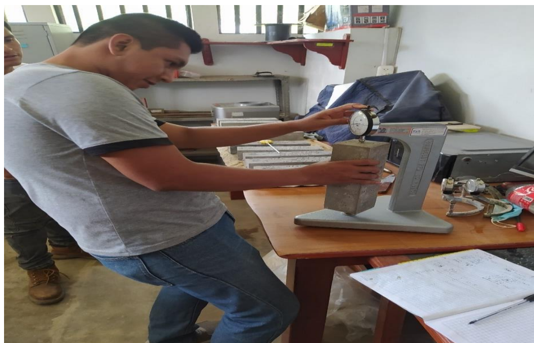
FOTO N° 42: Ensayo de contracción del concreto cemento-arena.
