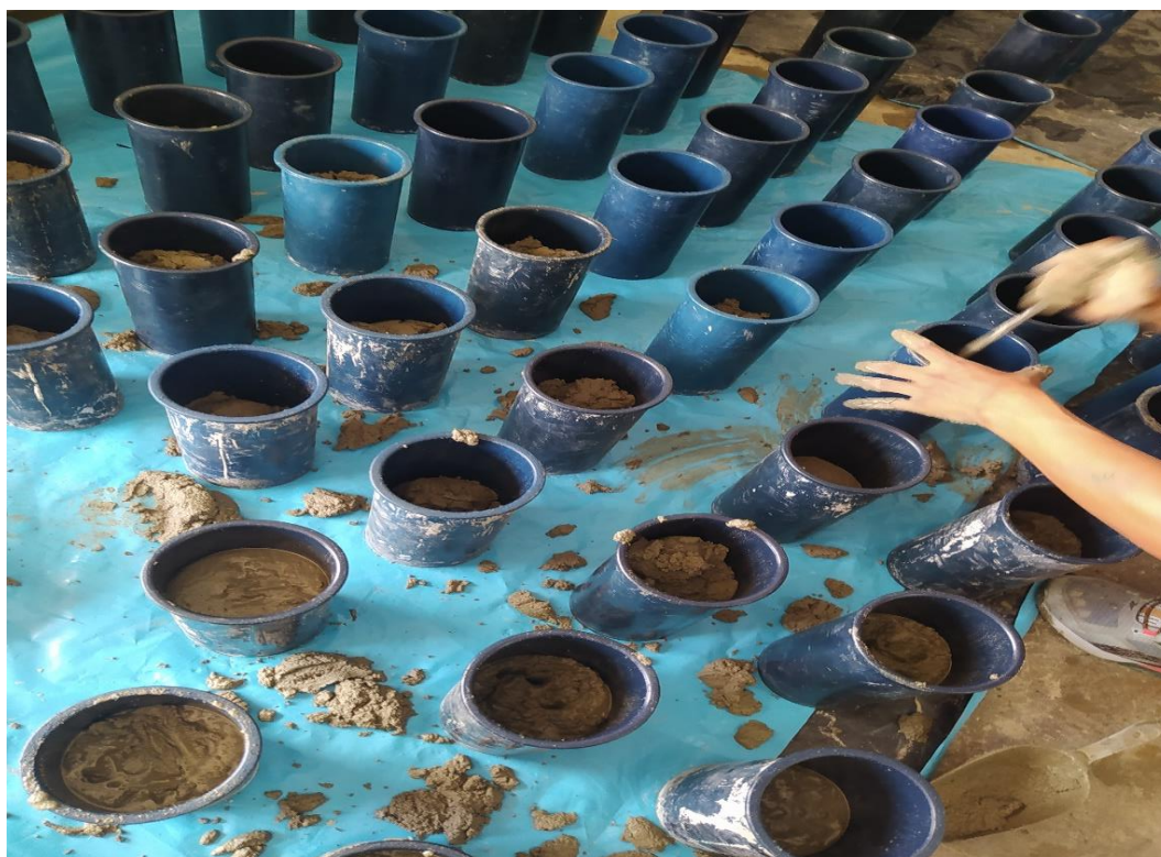
FOTO N° 34: Vaciado de la mezcla de concreto cemento – arena, en los moldes cilíndricos y prismáticos.
