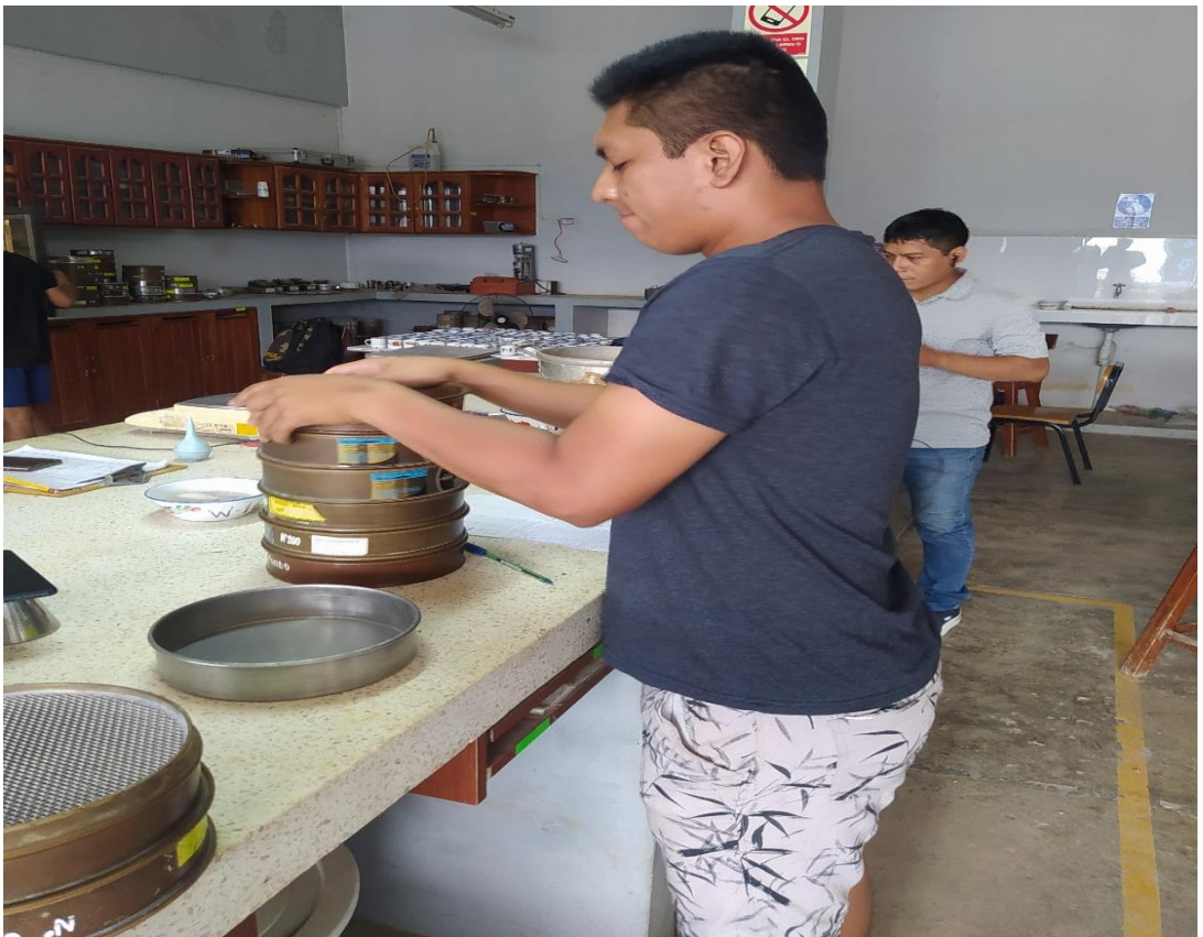
FOTO N° 18: Ensayo de análisis granulométrico.
