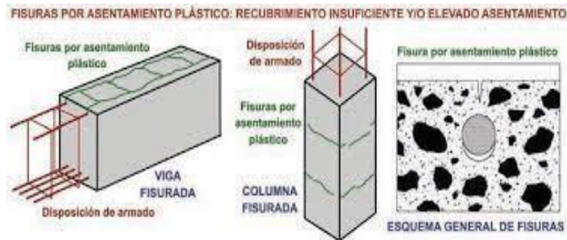
GRÁFICO N° 02. Fisuras por asentamiento plástico.
