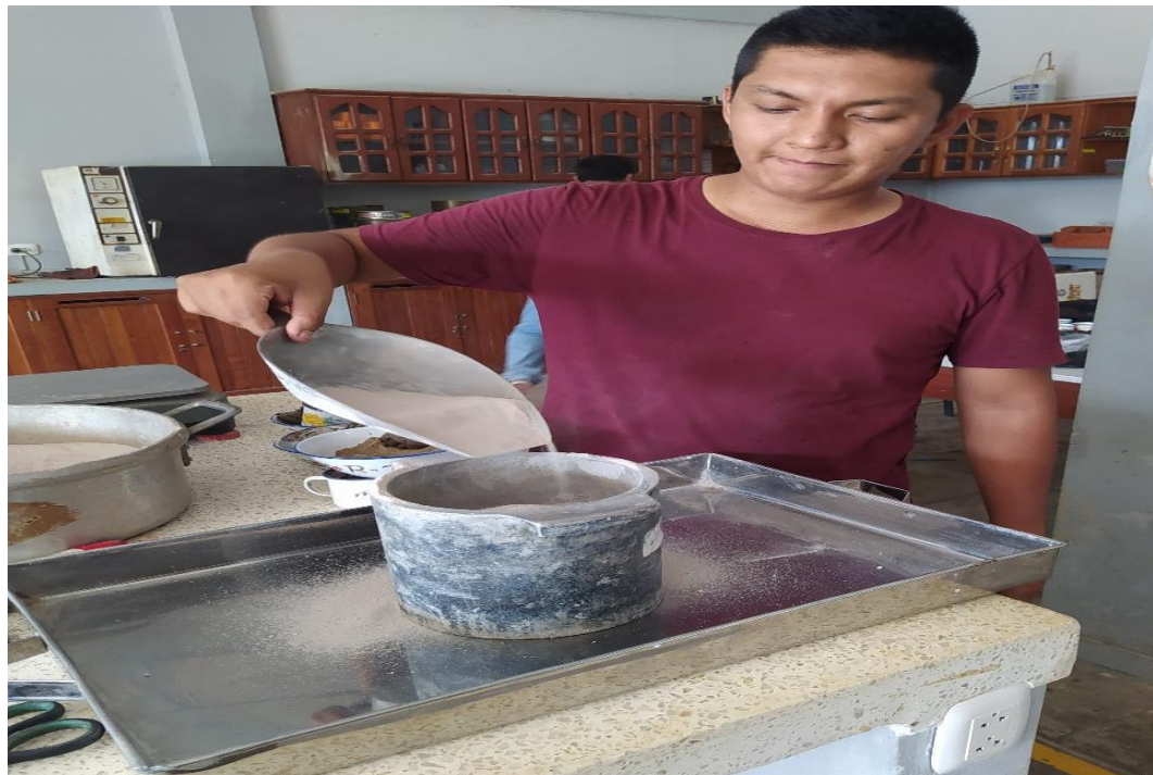
FOTO N° 20: Ensayo de peso unitario compactado.
