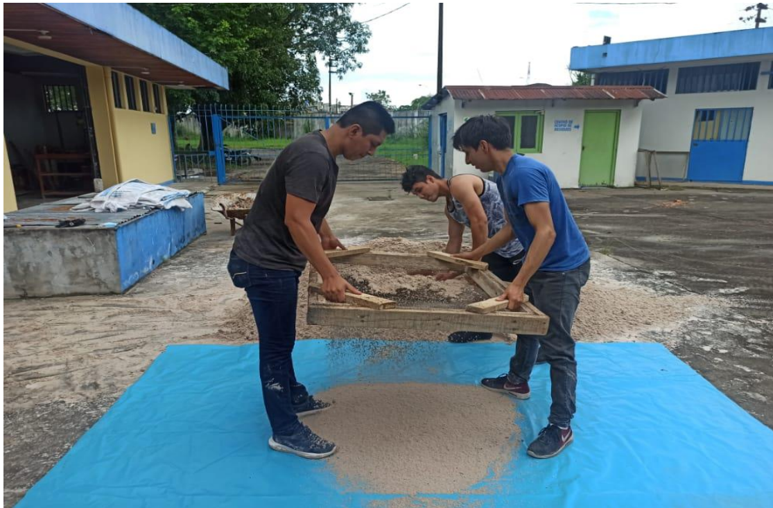
FOTO N° 04: Zarandeo de la muestra de agregado fino (arena) y remoción de impurezas.
