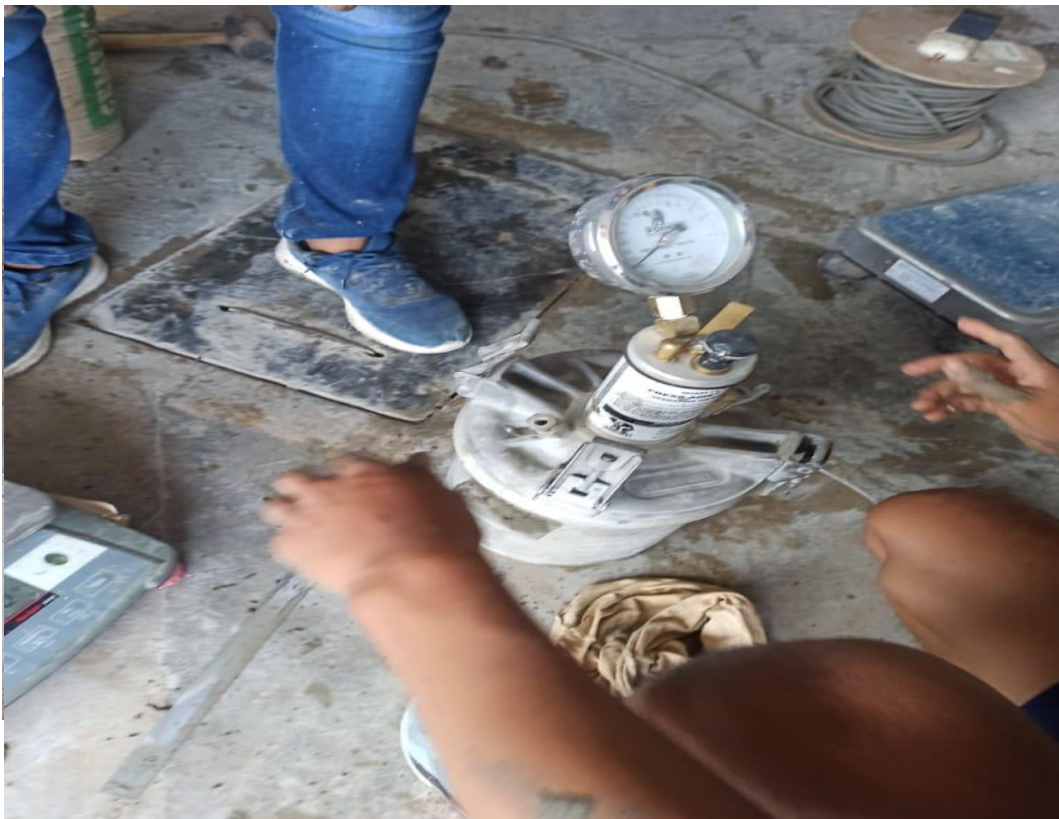
FOTO N° 28: Equipo para el ensayo de contenido de aire en la mezcla de concreto cemento – arena por el método de presión.
