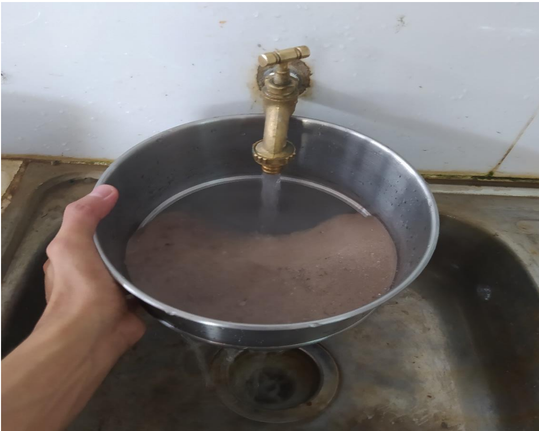
FOTO N° 16: Lavado de muestras para el ensayo de pasante la malla N° 200.
