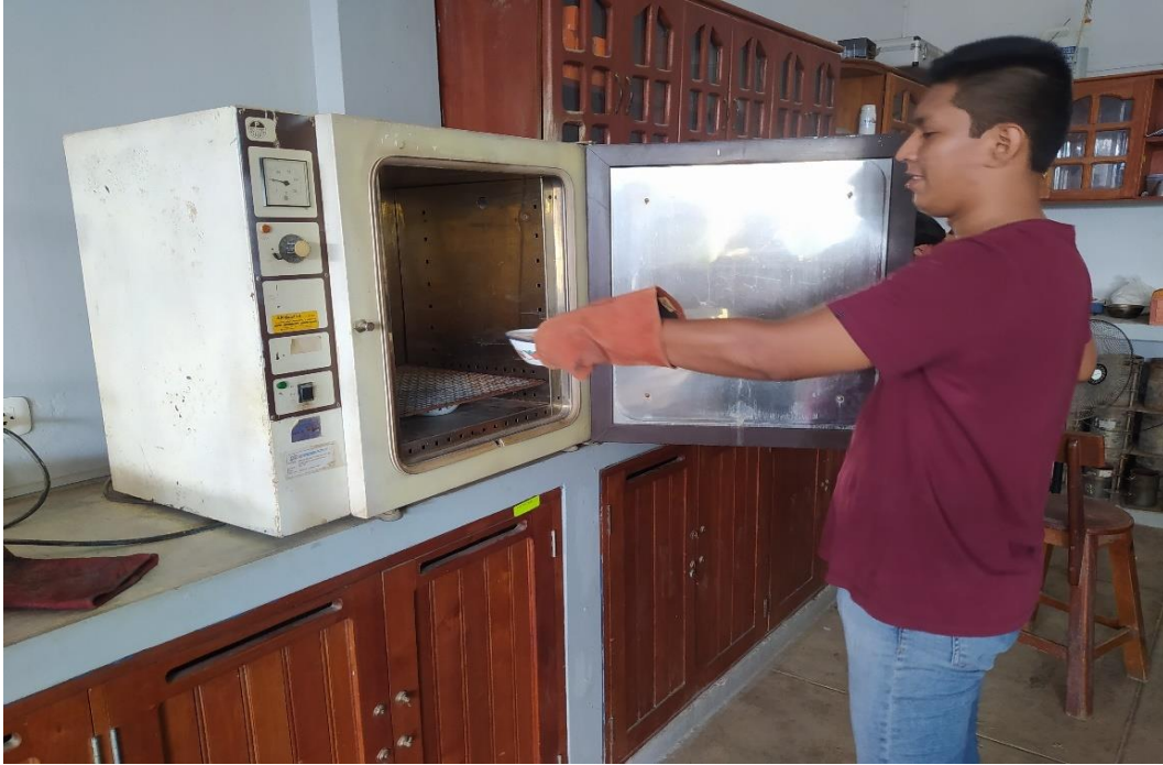
FOTO N° 15: Secado de muestras para los ensayos de Peso Unitario Suelto y Compactado, análisis granulométrico y pasante la malla N° 200.
