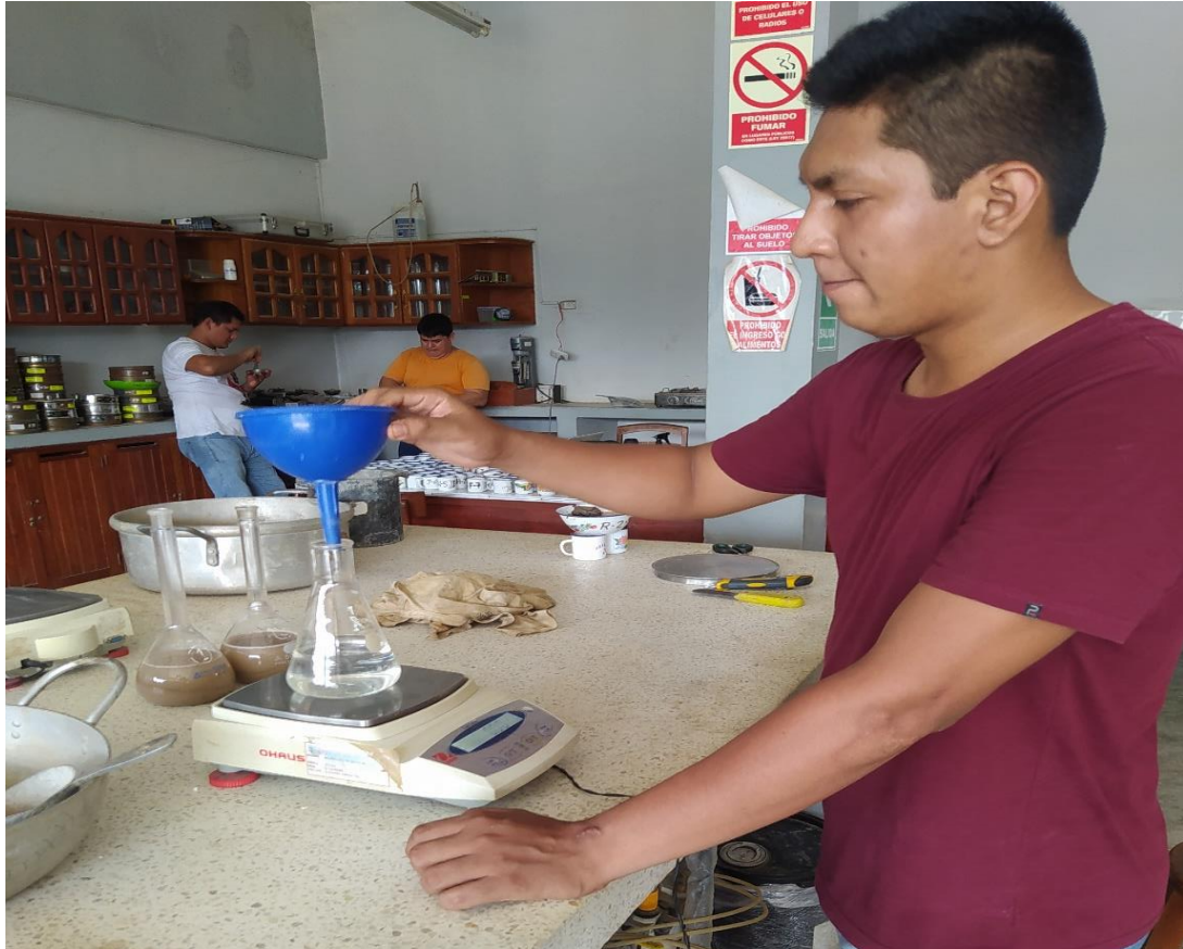
FOTO N° 10: Muestras ensayadas para el peso específico.
