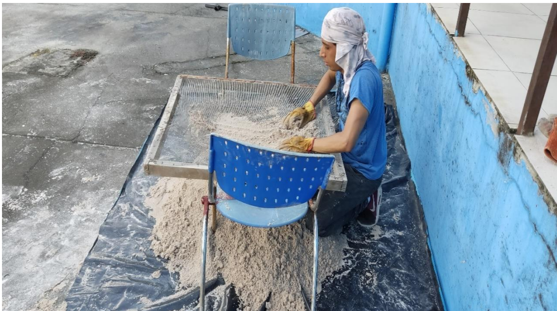
FOTO N° 04: Zarandeo de la muestra de agregado fino (arena) y remoción de impurezas.
