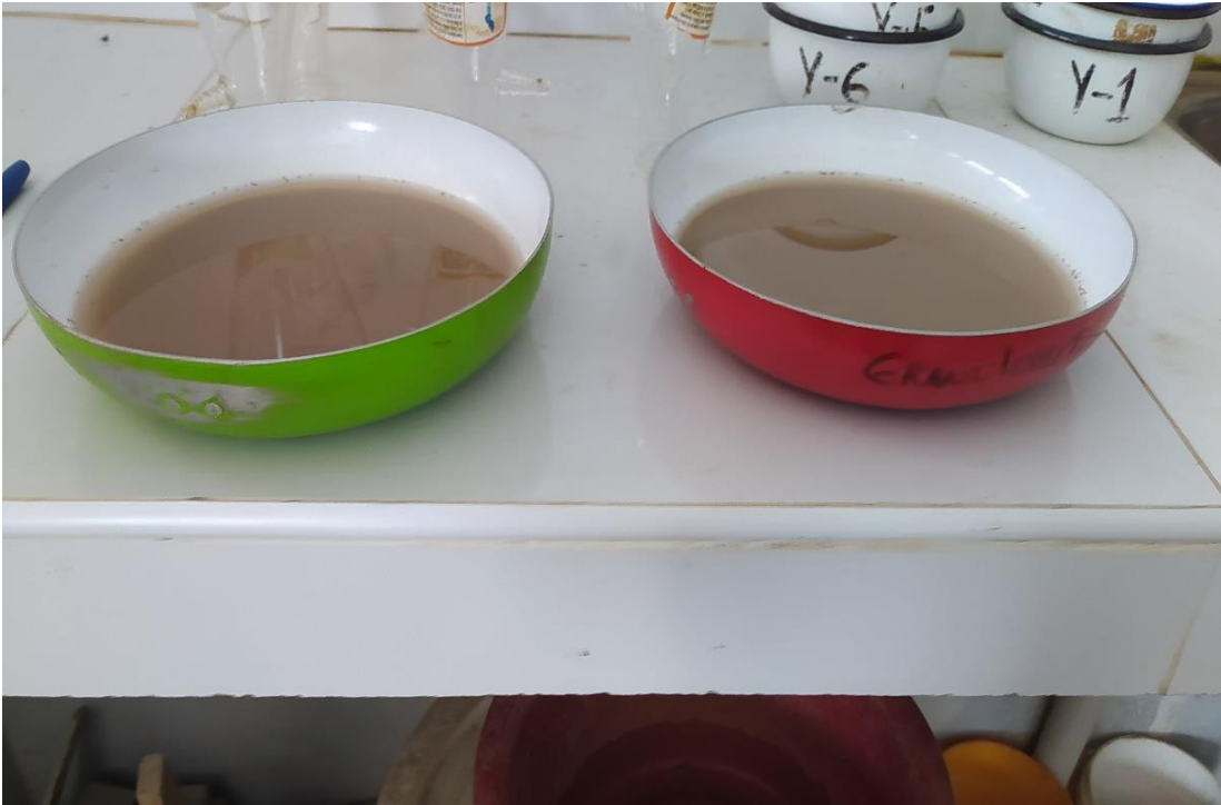
FOTO N° 14: Colocación de muestras para el respectivo secado del ensayo de absorción.
