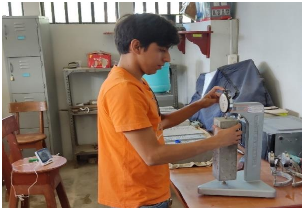
FOTO N° 41: Lectura y registro del cambio de longitud en los prismas del concreto cemento – arena, realizando el respectivo control de humedad.
