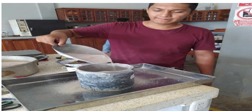
GRÁFICO N° 15: Ensayo de peso unitario suelto.
