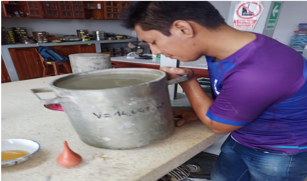
FOTO N° 31: Ensayo de Exudación del concreto.
