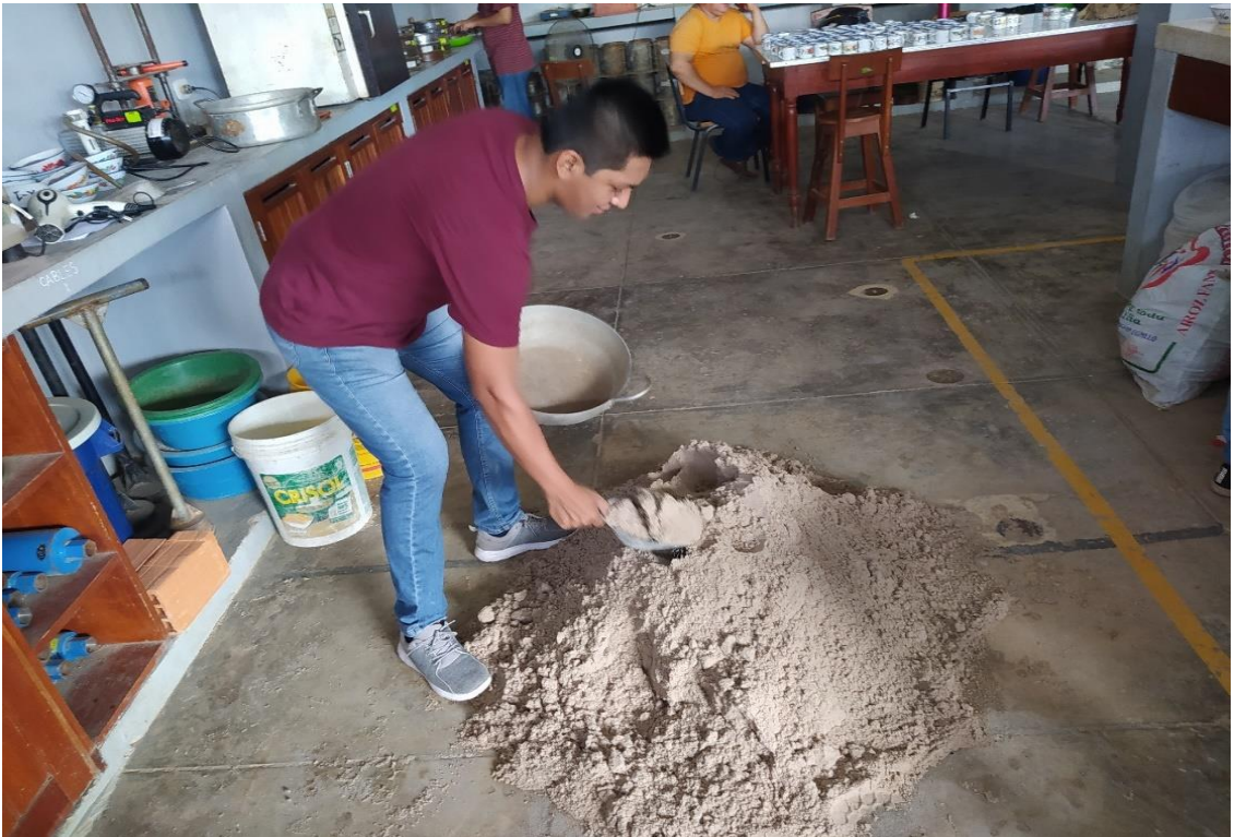
FOTO N° 08: Punto óptimo del agregado fino para el ensayo de peso específico en su condición Saturado Superficialmente Seco (SSS).
