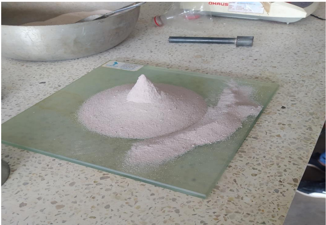
FOTO N° 08: Punto óptimo del agregado fino para el ensayo de peso específico en su condición Saturado Superficialmente Seco (SSS).
