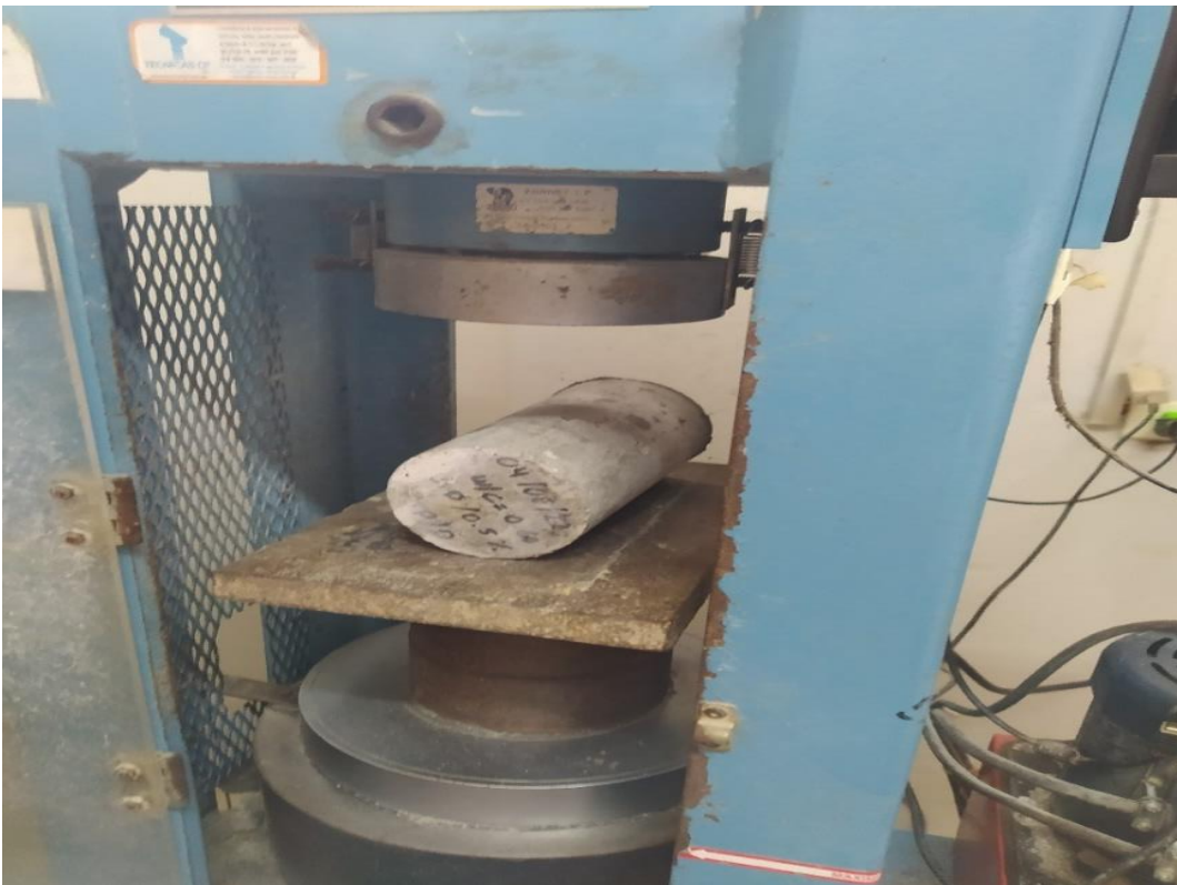
FOTO N° 46: Ensayo de tracción por compresión diametral.
