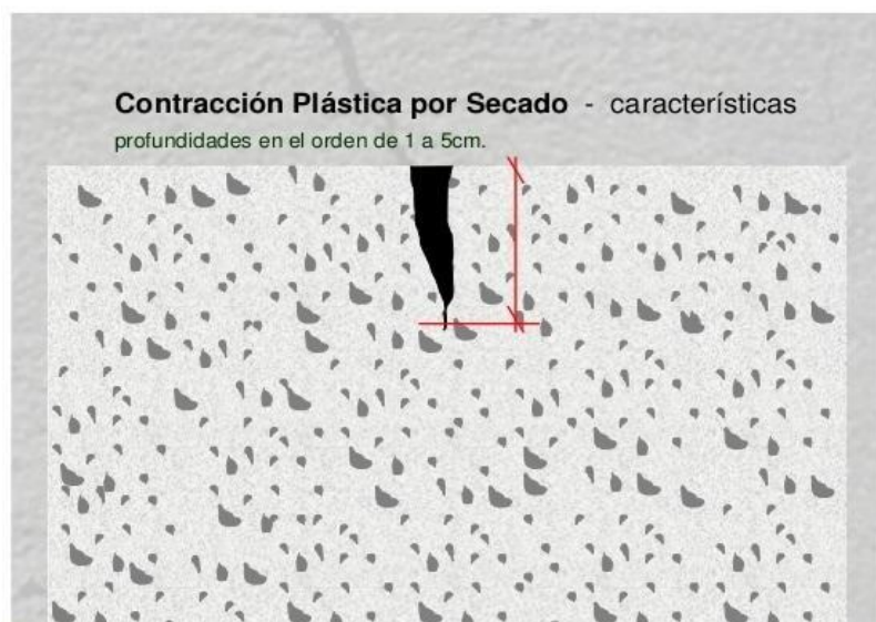
GRÁFICO N°04. Fisuras por contracción plástica en el concreto fresco.
