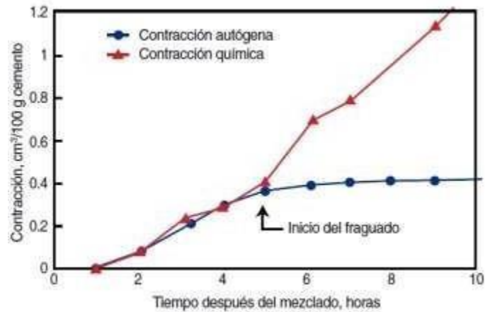
GRÁFICO N°05. Relación entre contracción autógena y contracción química de la pasta de cemento en edades tempranas.
