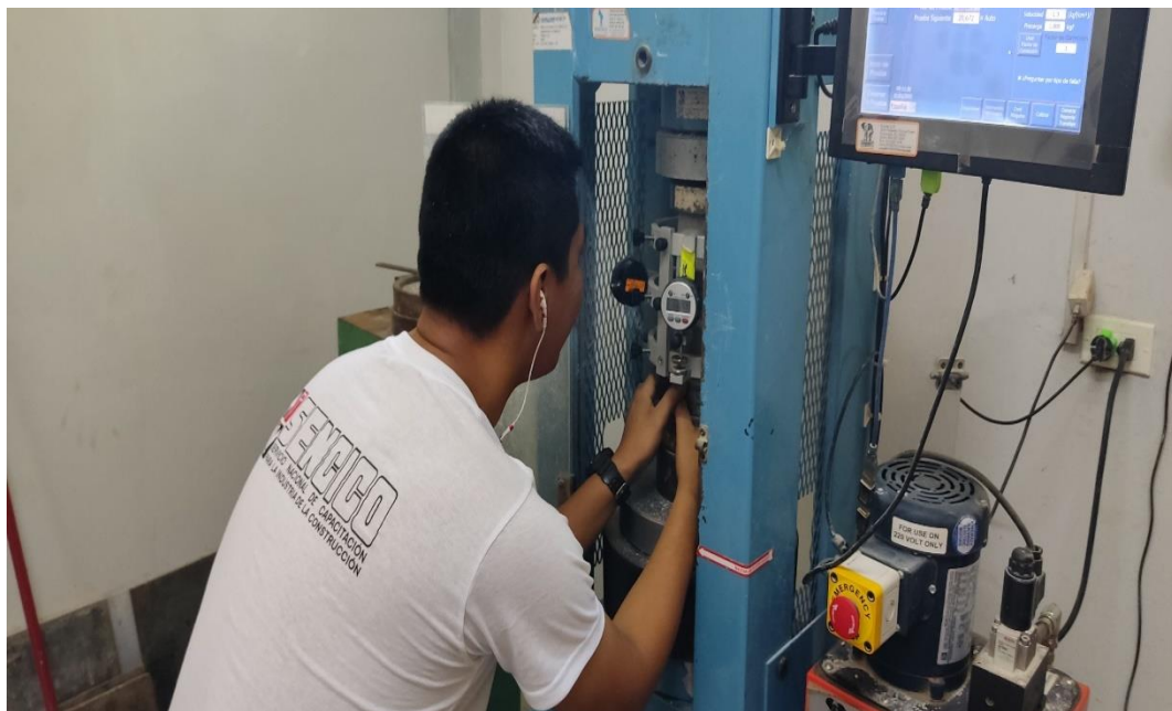
FOTO N° 50: Ensayo de módulo de elasticidad.
