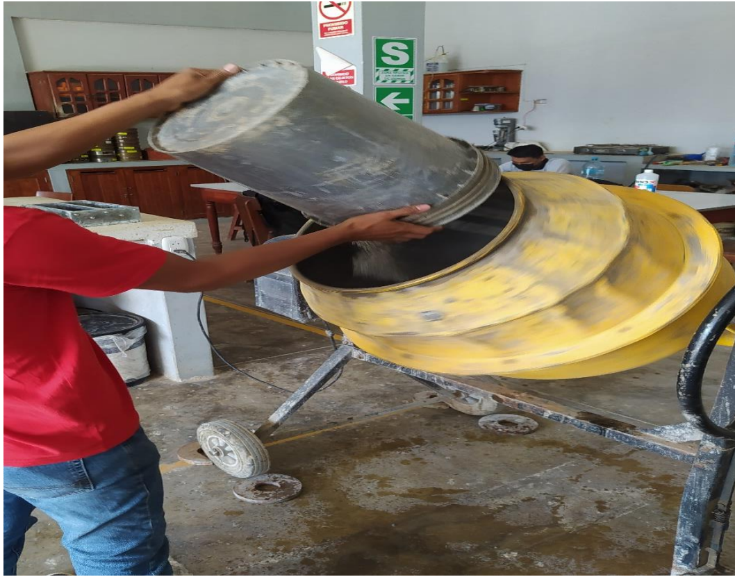
FOTO N° 25: Mezcladora. (Trompo para el diseño de mezcla)
