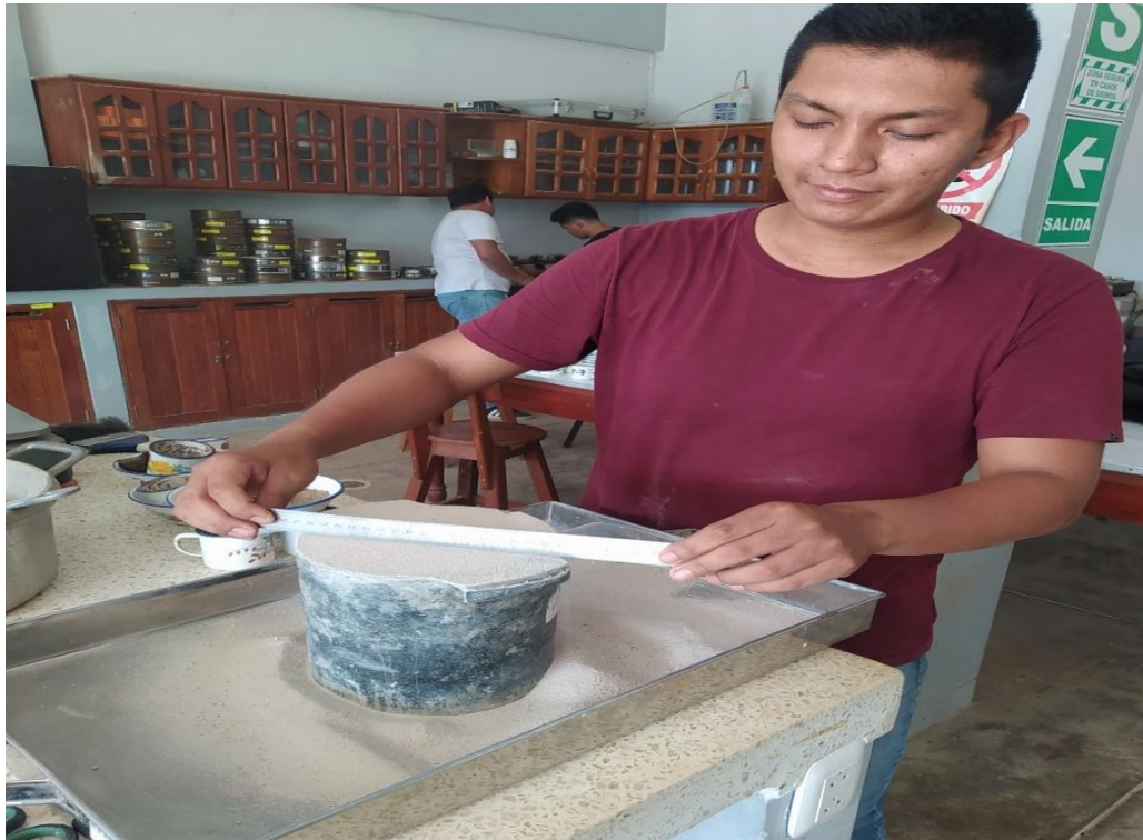
FOTO N° 22: Preparación de los moldes cilíndricos y prismáticos con su engrasado (petróleo, para su fácil desmolde).
