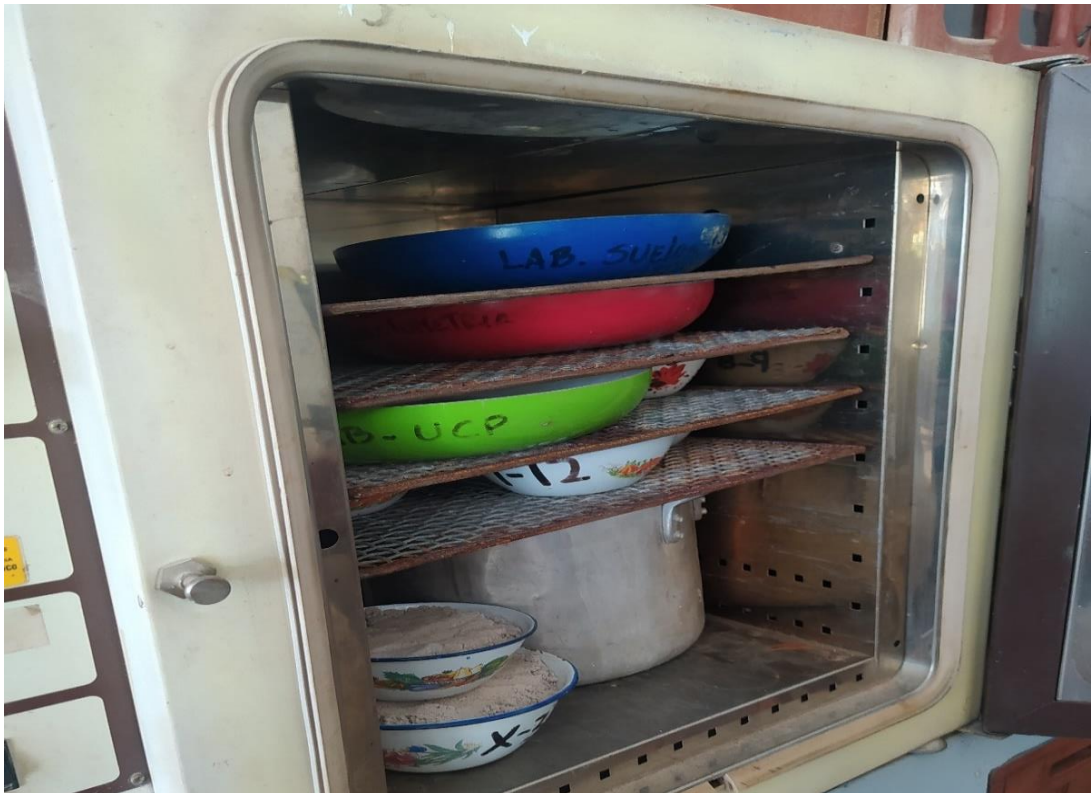
FOTO N° 14: Colocación de muestras para el respectivo secado del ensayo de absorción.
