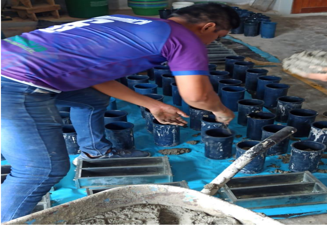
FOTO N° 35: Colocación de la mezcla en los respectivos moldes.
