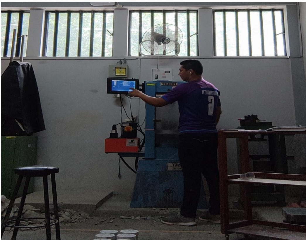
FOTO N° 44: Prueba de Compresión en la prensa hidráulica.
