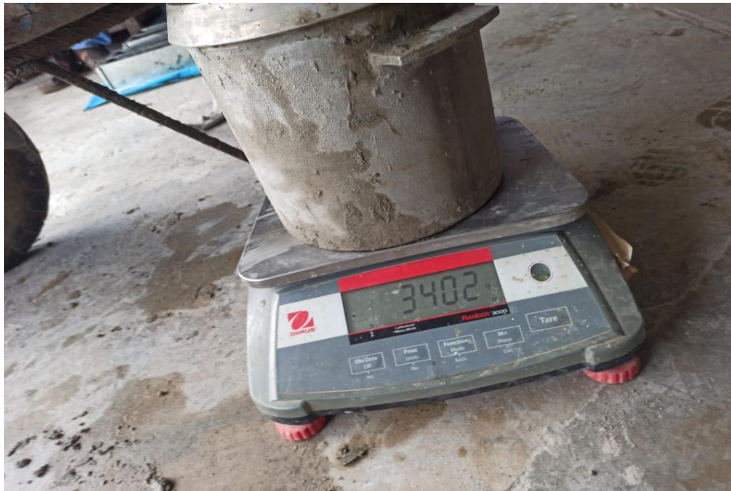
FOTO N° 28: Equipo para el ensayo de contenido de aire en la mezcla de concreto cemento – arena por el método de presión.
