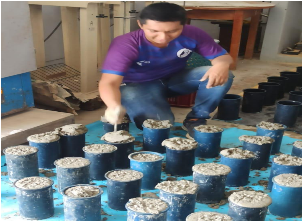
FOTO N° 36: Colocación de la mezcla en capas los respectivos moldes y chuzado con 25 golpes usando la varilla.
