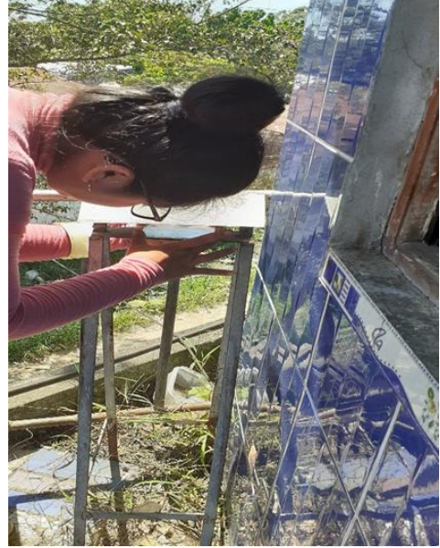
Colocación en cada placa de vidrio en las Estaciones de Muestreo.
