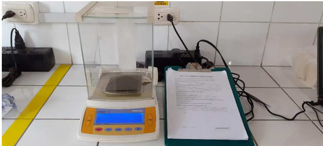
Luego de extraer y transportar al laboratorio las placas con Polvo Atmosferico Sedimentable (PAS) se realizó el pesaje correspondiente a cada placa, para luego trasladar los datos obtenidos en la ficha de apuntes.
