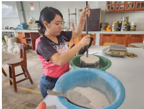
Gráfico 10. Ensayo de peso unitario compactado
