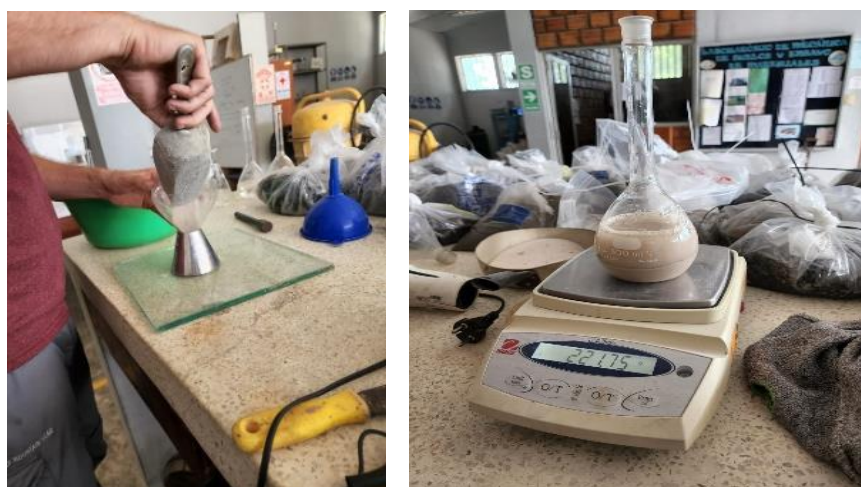
Gráfico 7. Ensayo de peso específico del agregado fino.
