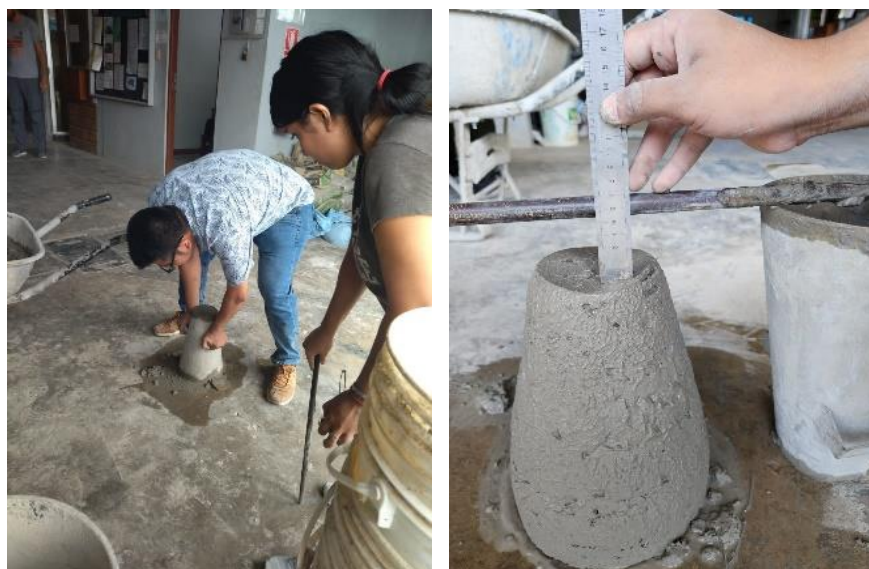
Gráfico 15. Ensayo de consistencia de la mezcla
