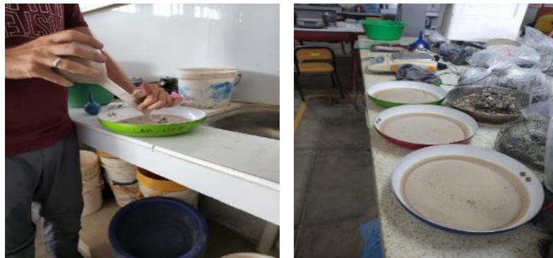
Gráfico 8. Ensayo de absorción del agregado fino
