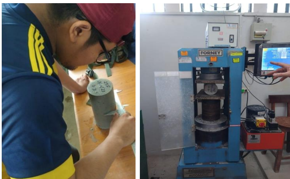
Gráfico 23. Resistencia a la compresión por tracción diametral.
