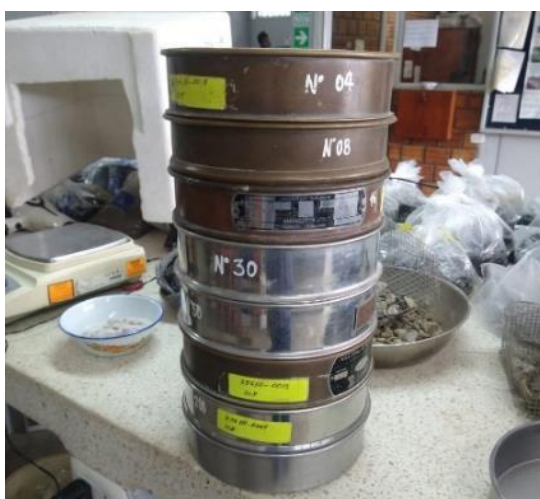
Gráfico 2. Juego de tamices para el ensayo de análisis granulométrico
