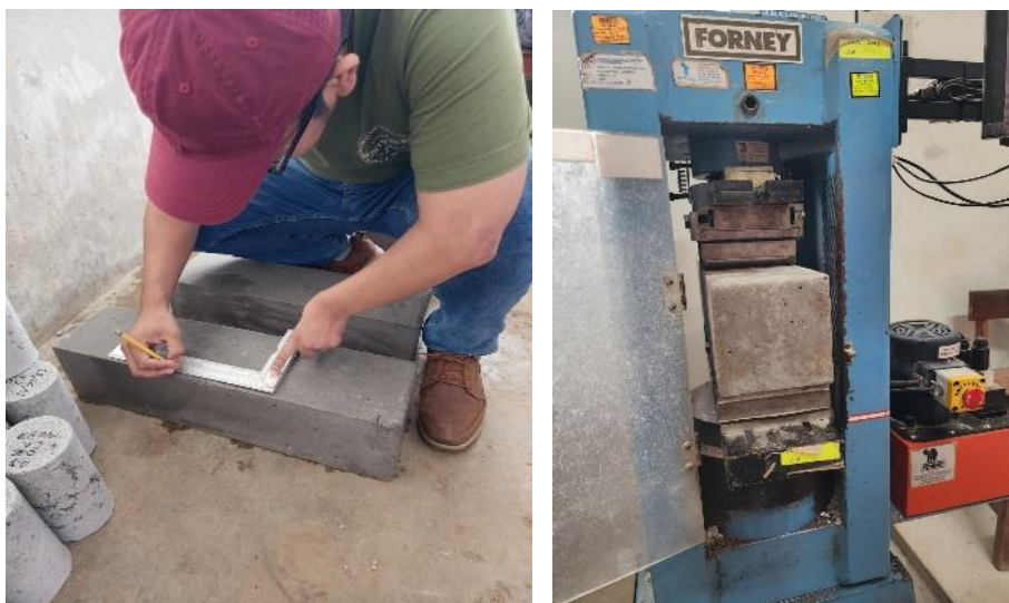
Gráfico 28. Medición del tercio de la viga del concreto
