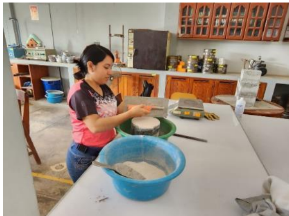
Gráfico 9. Ensayo del peso unitario suelto
