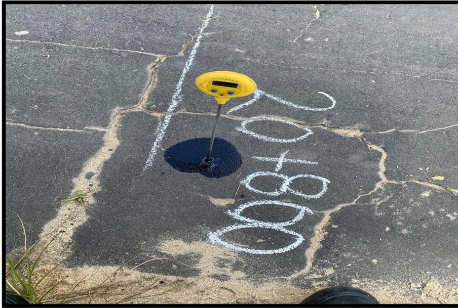
*Fotografía 7 Toma de Temperatura del pavimento en cada punto de ensayo*
