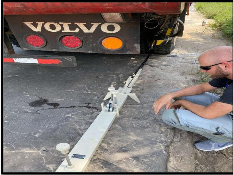
*Fotografía 5 Verificación de los Diales antes de iniciar la Marcha del Camión*
