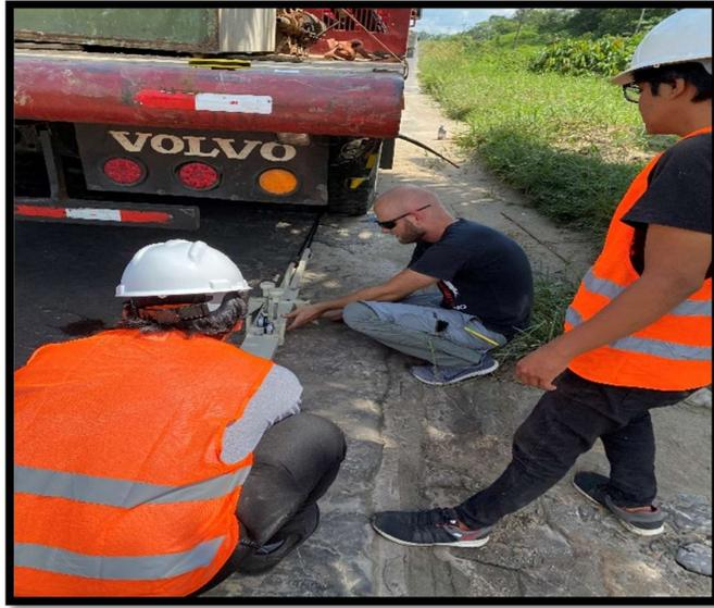
*Fotografía 3 Colocación de la Viga en el Punto de Ensayo*
