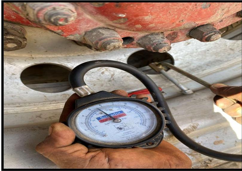
*Fotografía 9 Medición de Presión de las llantas*
