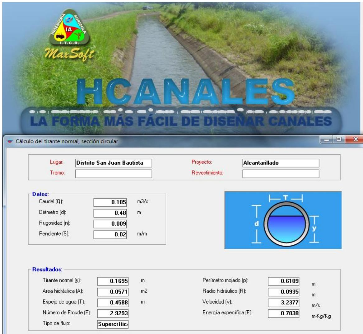
Figura 16. Diseño de ductos aplicando H Canales
