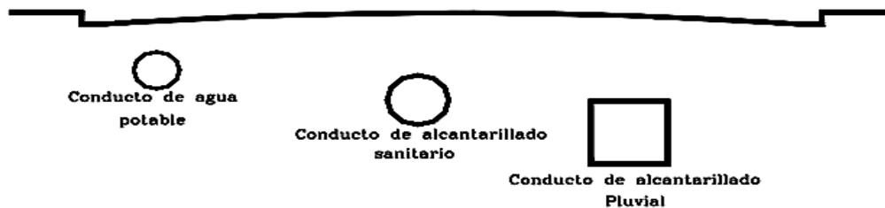
Figura 3. Esquema de las redes hidráulicas urbanas
