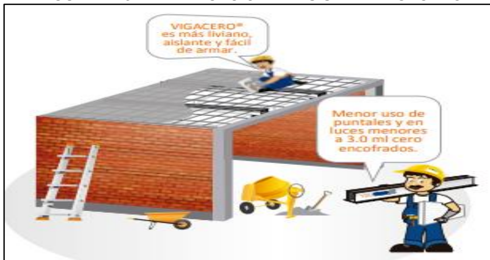
FIGURA N° 3 APLICACIÓN DEL SISTEMA VIGACERO
