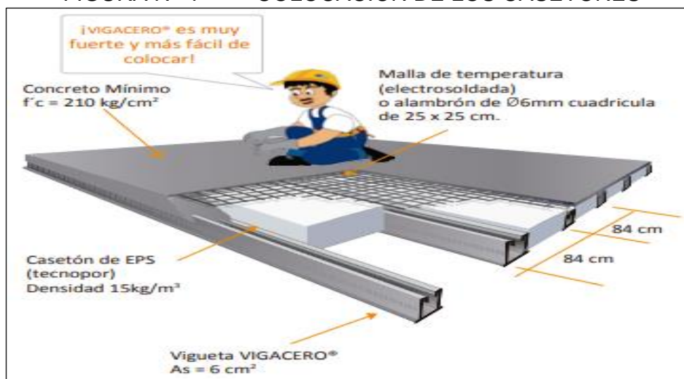
FIGURA N° 4 COLOCACIÓN DE LOS CASETONES
