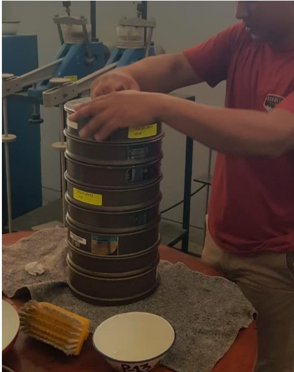
Figura 8. Tamizado granulométrico de las muestras de suelo.
