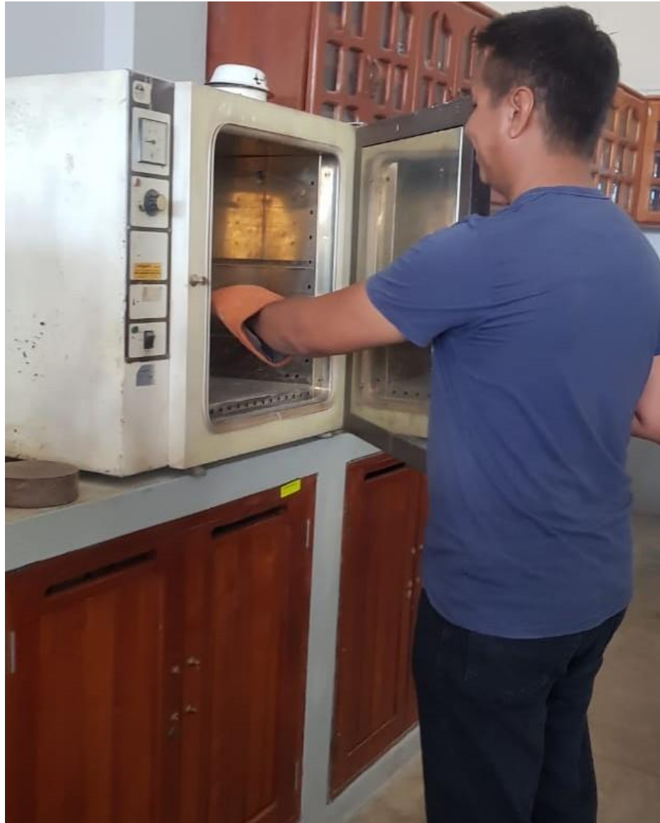
Figura 9. Ensayo de contenido de humedad de las muestras de suelo.
