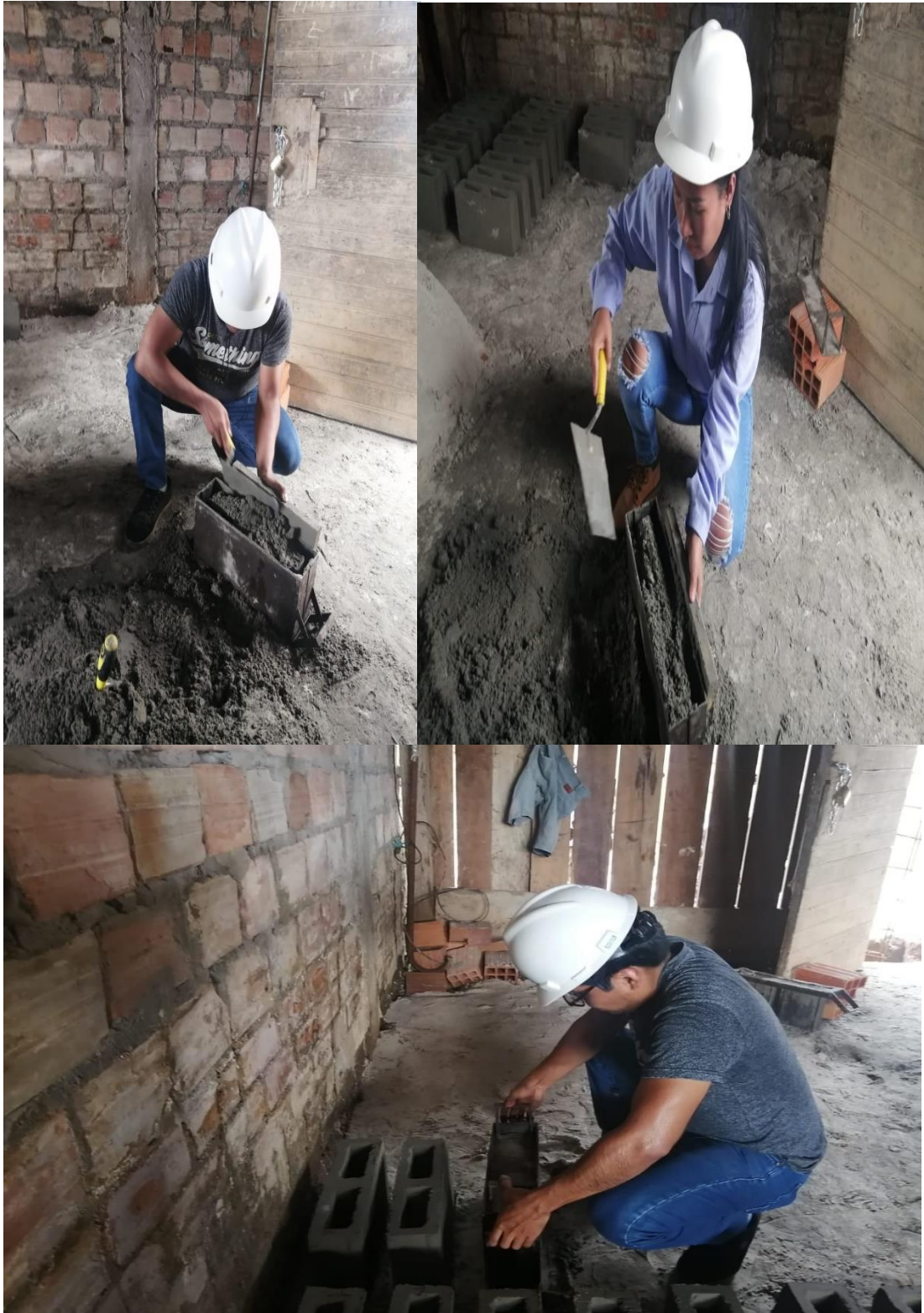
Imagen 1 Elaboración de bloques de concreto.
