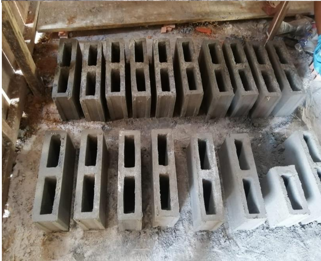
Imagen 2 Proceso de fraguado de los bloques de mortero.
