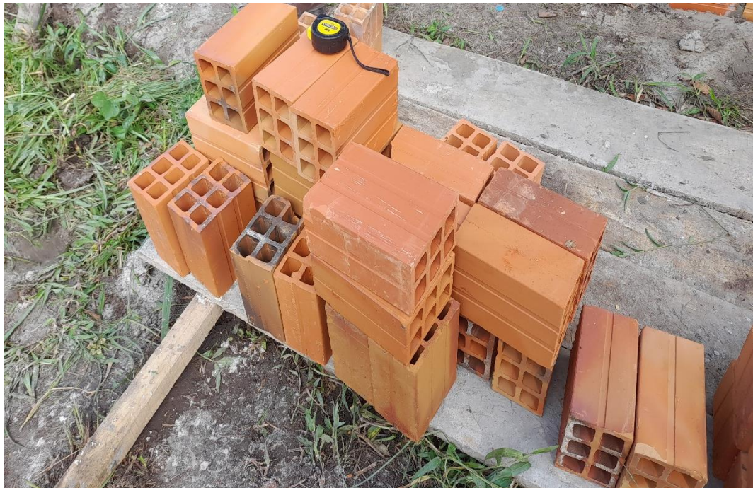
Imagen 6 Ladrillos de arcilla utilizados en el asentado de muro.
