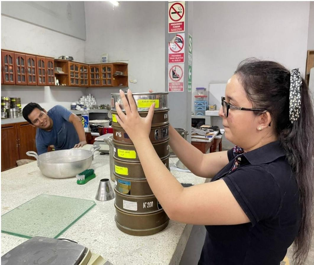
**Imagen 6:** Tamizaje de los agregados para el diseño de mezcla.
