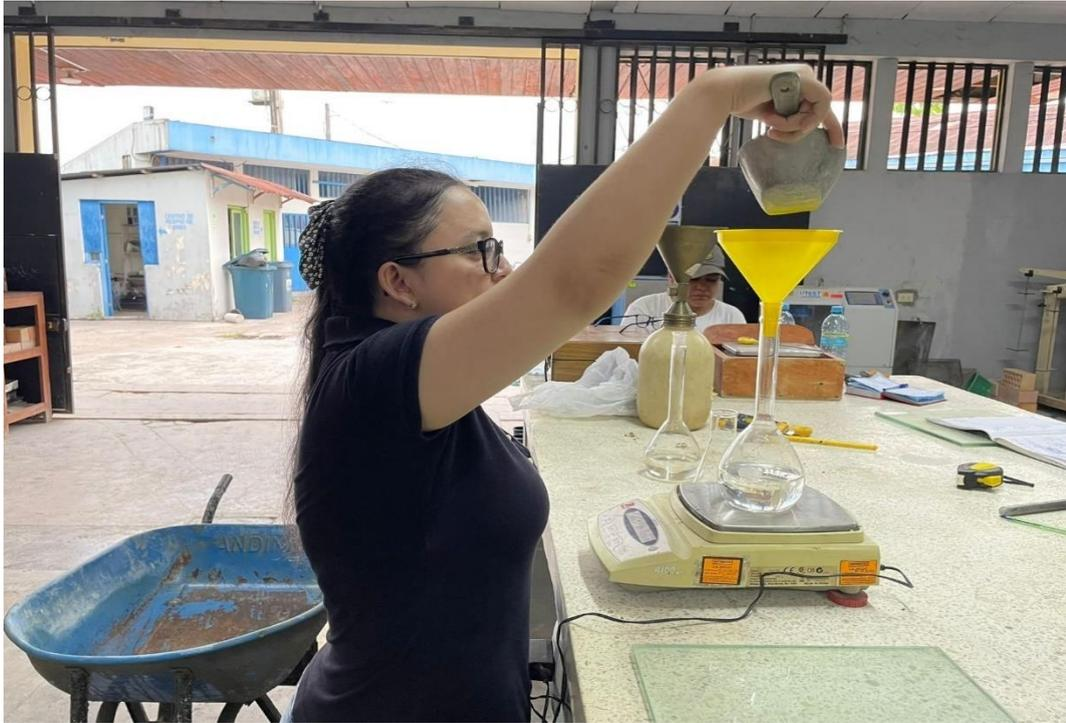
**Imagen 7:Pesado del agua para el diseño de mezcla.**
