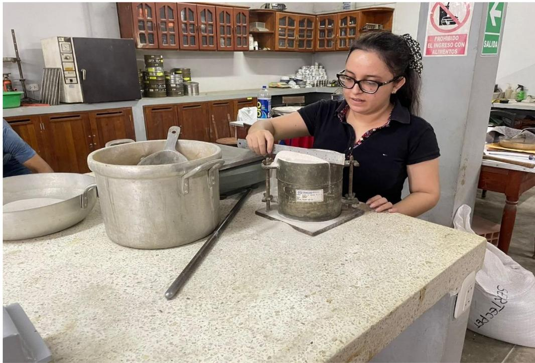
**Imagen 5** colocacion del agregado fino en el recipiente para su compactación.
