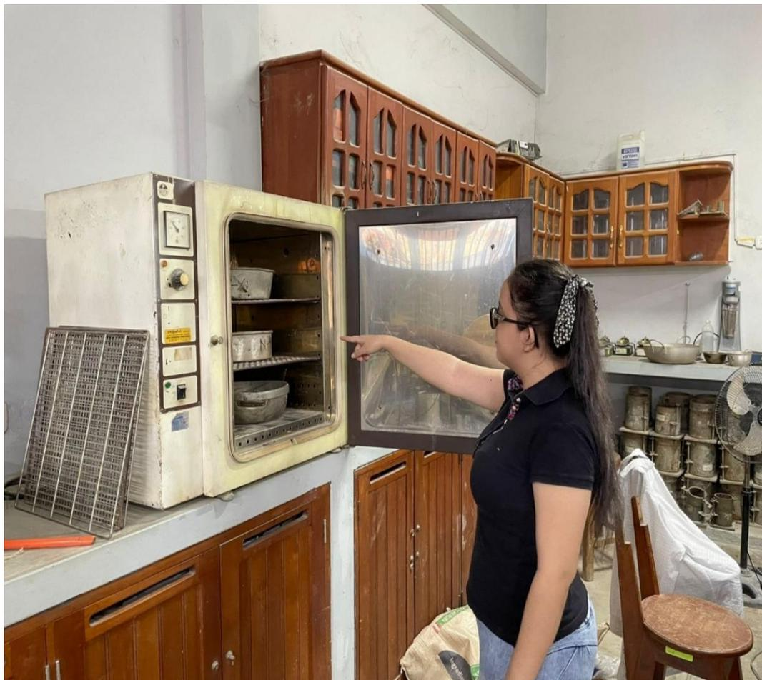
**Imagen 8:Ensayo de los agregados ( secado del agregado).**
