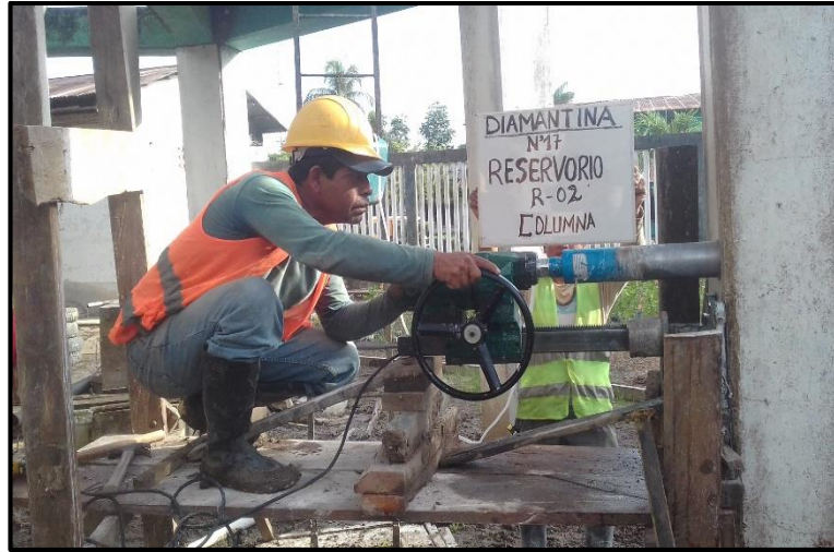
Gráfico 25. Fotografía Extracción de núcleo de Columna de Reservorio R-2
