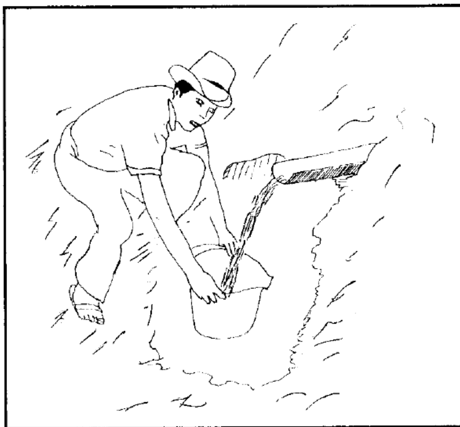
Figura N° 11 Aforo de agua por el método volumétrico
