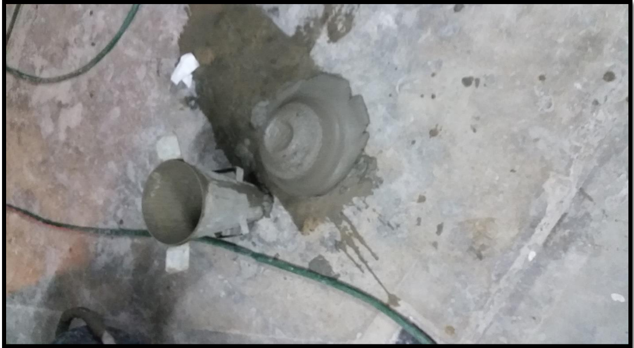
❖ Ensayo Cono de Abrams, sin aditivo.
