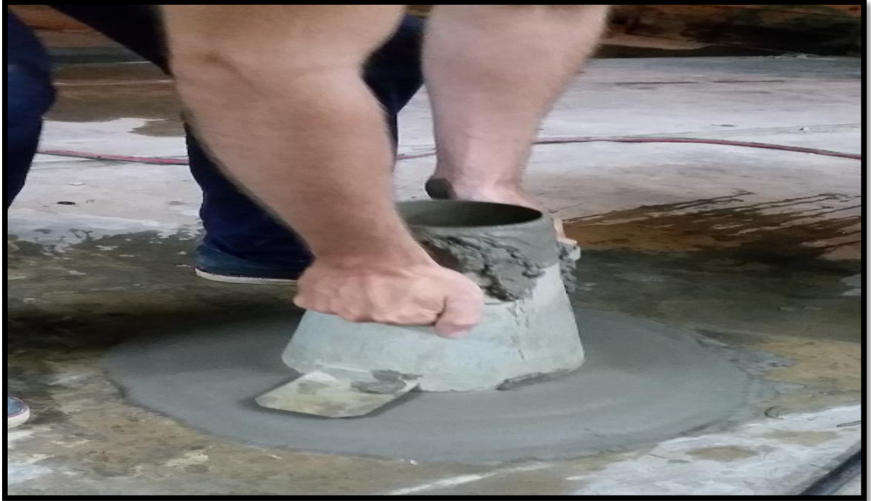
❖ Ensayo Cono de Abrams, utilizando aditivo.
