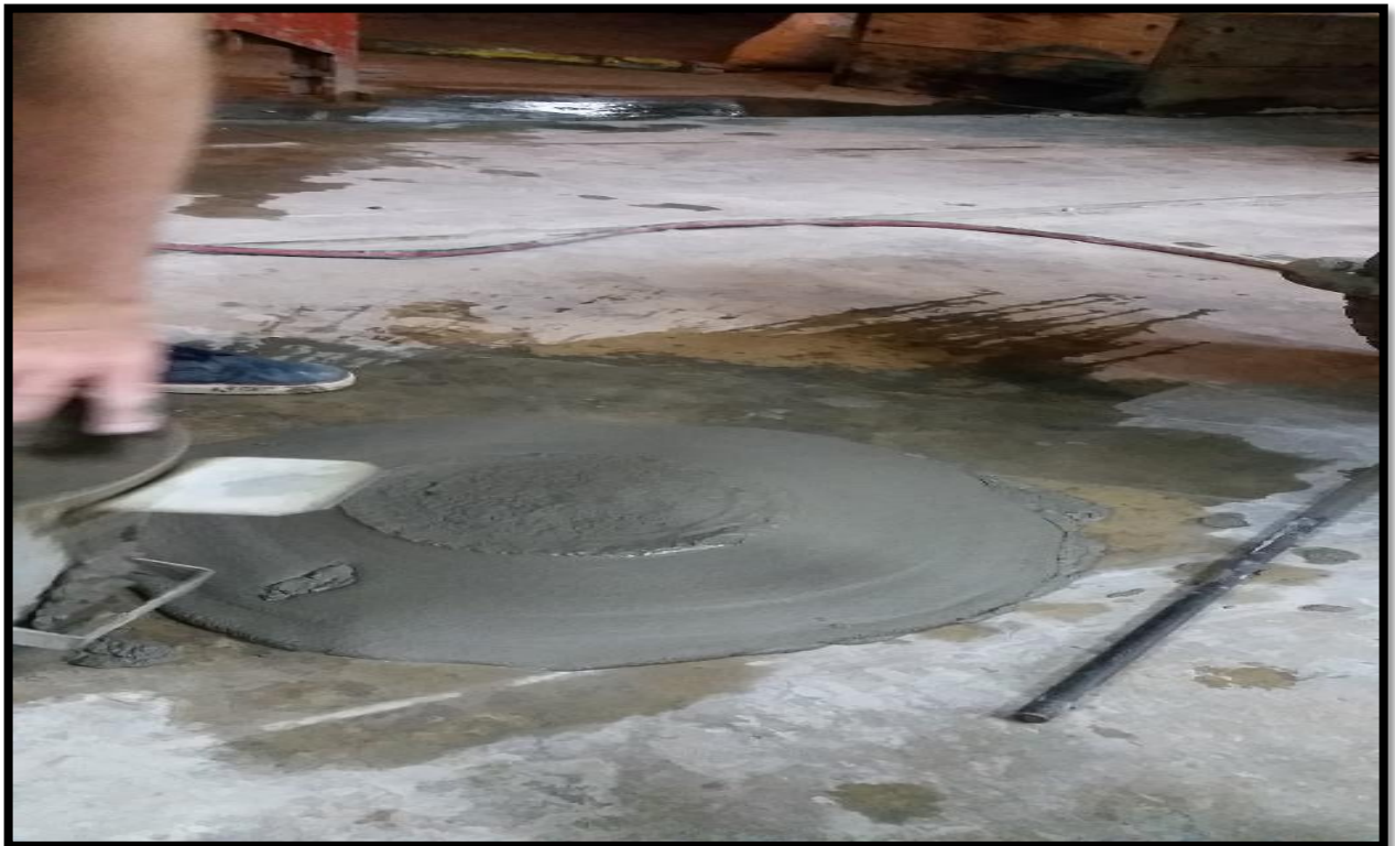
❖ Ensayo Cono de Abrams, utilizando aditivo.
