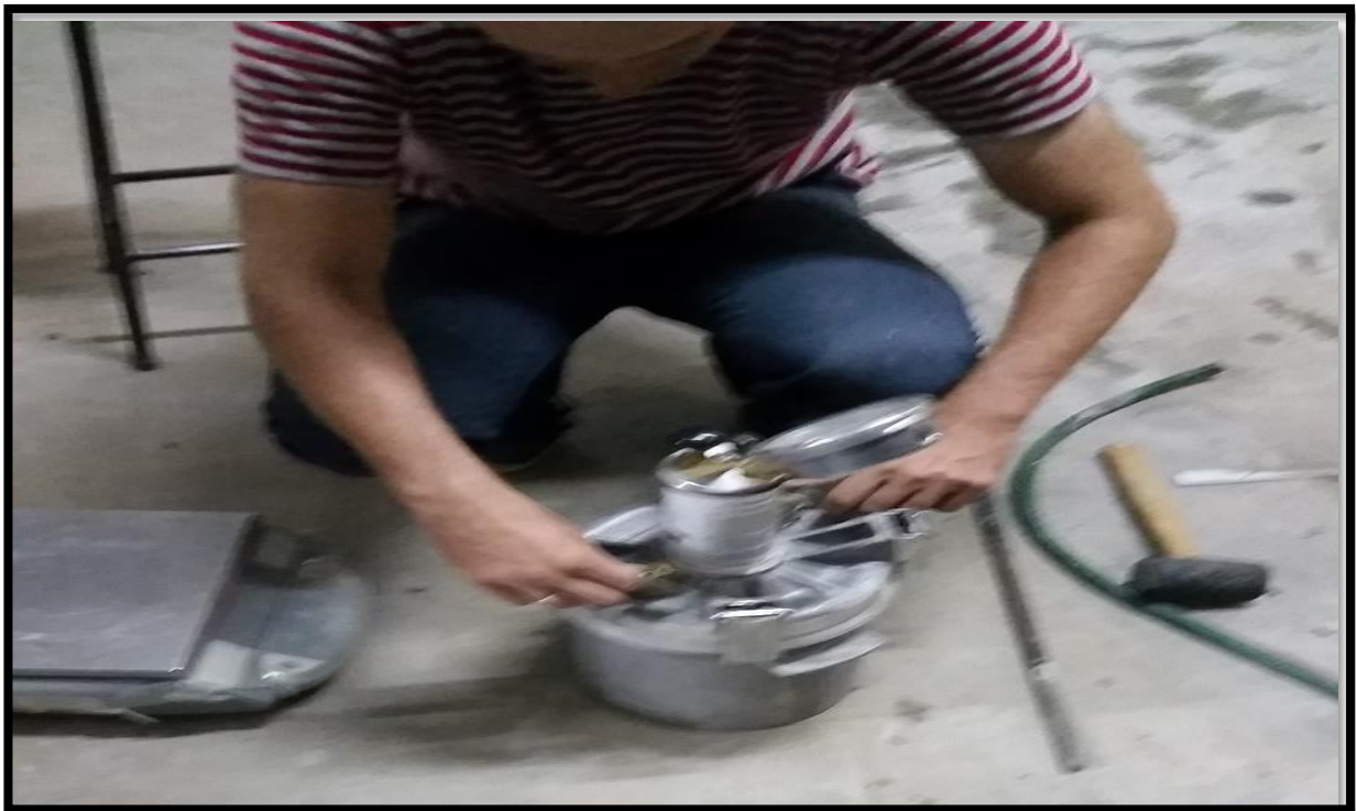
❖ Ejecutando el ensayo de olla de Washington, para sacar el contenido de aire del concreto cemento-arena en estado fresco.
